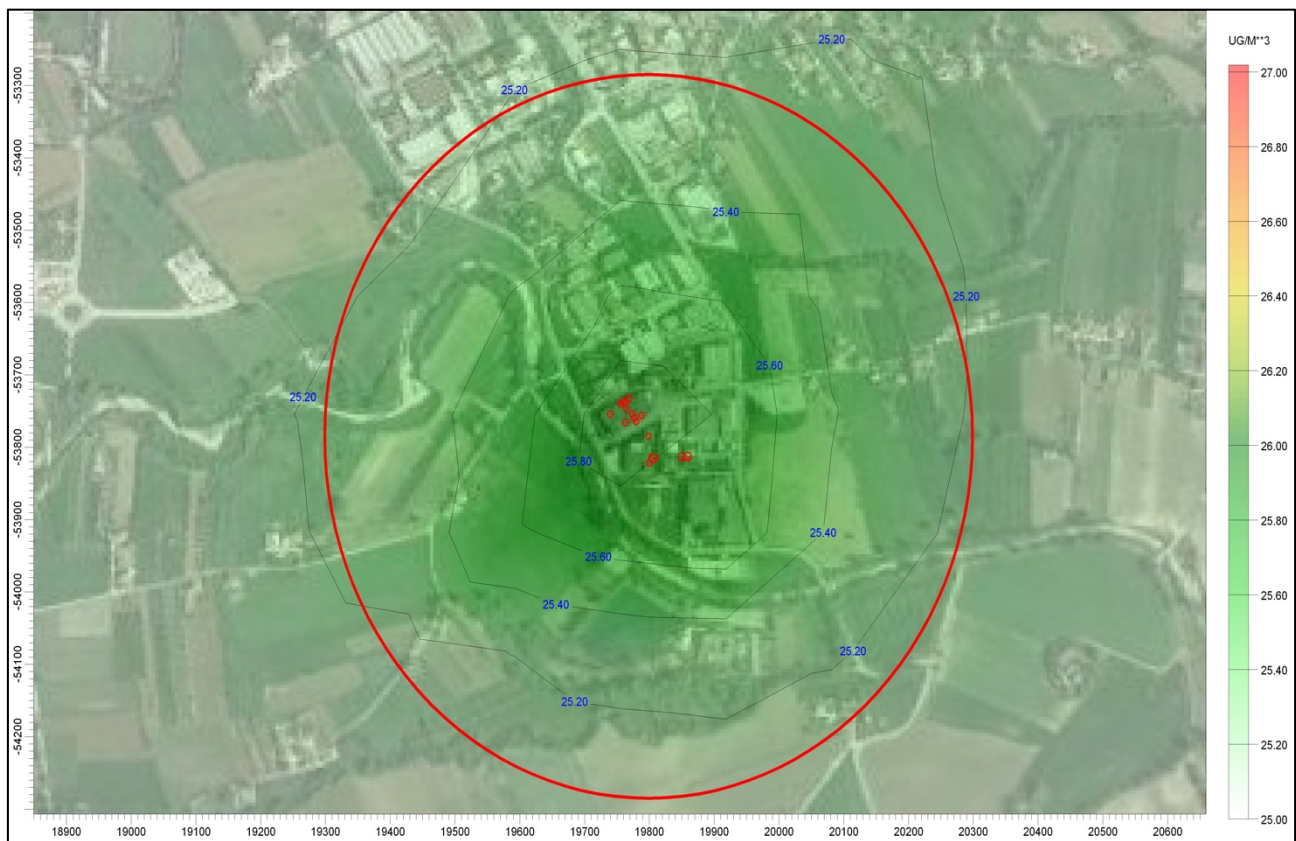
Figura 23: Mappa della concentrazione massime giornaliere di PM10 nell'anno 2017 [ \mu\text{g}/\text{m}^3 ]. Emissioni dall'azienda in esercizio nello stato di progetto integrate con il valore di fondo riferito al comune di Nereto (TE) ( 25 \mu\text{g}/\text{m}^3 ). Il cerchio rosso ha raggio di 500 m.
