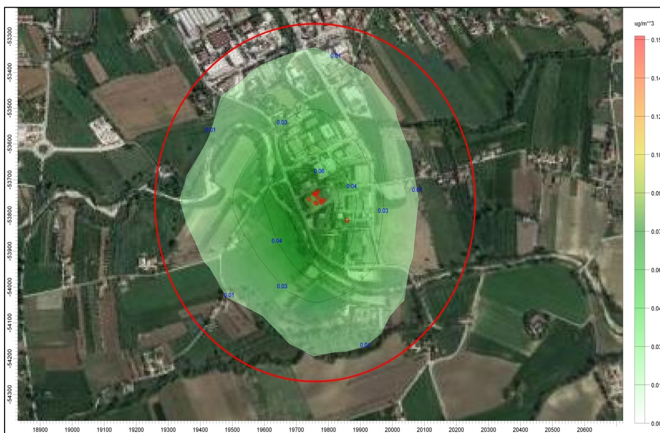
Figura 17: Mappa della concentrazione medie annue per il permanganato di potassio nell'anno 2017 [ \mu\text{g}/\text{m}^3 ]. Emissioni dall'azienda in esercizio nello stato di fatto. Il cerchio rosso ha raggio di 500 m.
