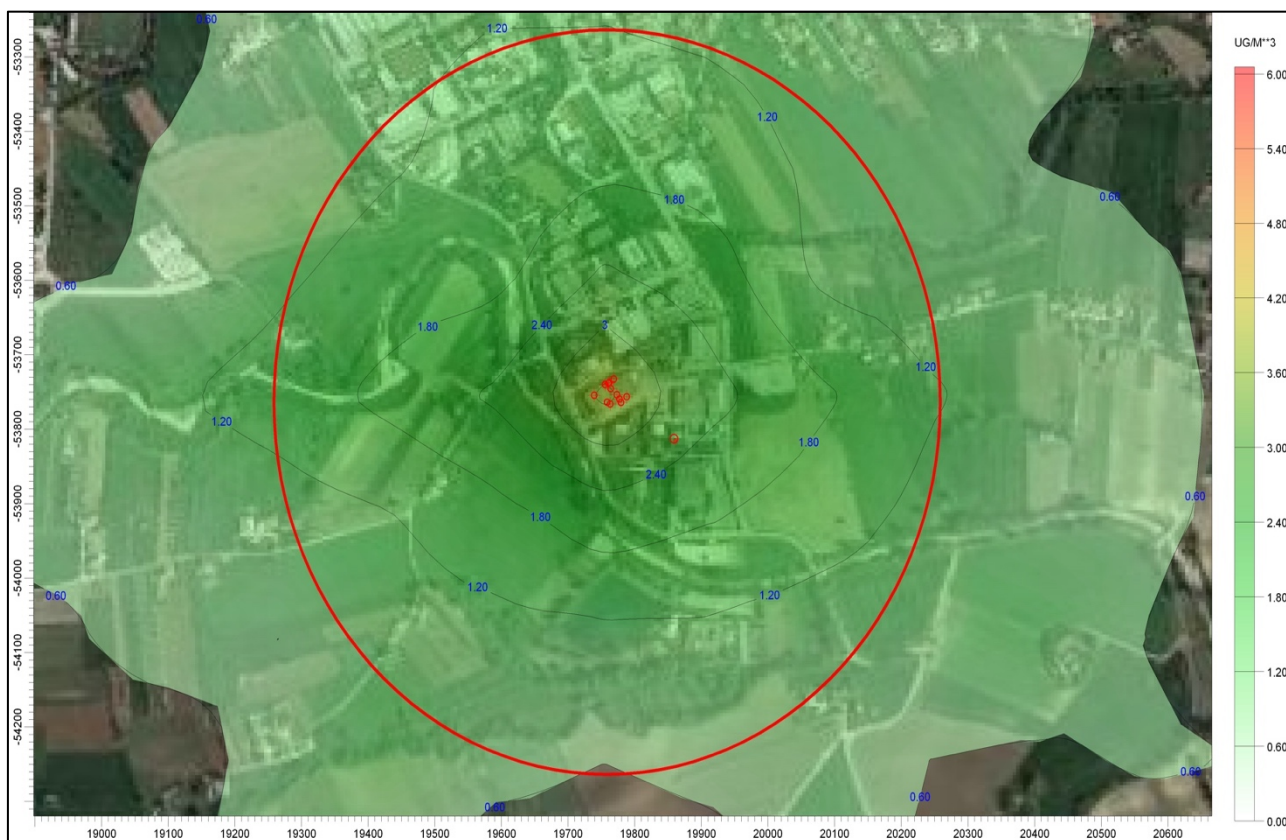
Figura 14: Mappa della concentrazione massime orarie di cloro nell'anno 2017 [ \mu\text{g}/\text{m}^3 ]. Emissioni dall'azienda in esercizio nello stato di fatto. Il cerchio rosso ha raggio di 500 m.
