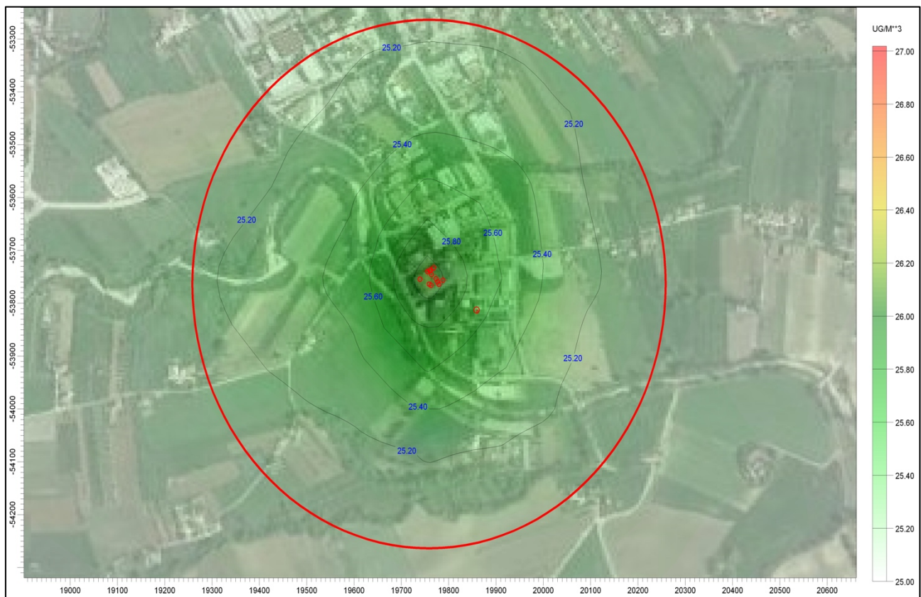
Figura 22: Mappa della concentrazione massime giornaliere di PM10 nell'anno 2017 [ \mu\text{g}/\text{m}^3 ]. Emissioni dall'azienda in esercizio nello stato di fatto integrate con il valore di fondo riferito al comune di Nereto (TE) ( 25 \mu\text{g}/\text{m}^3 ). Il cerchio rosso ha raggio di 500 m.
