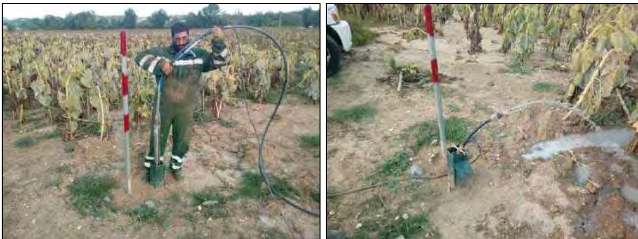
Fig.3: Fasi dello spurgo dei piezometri.
