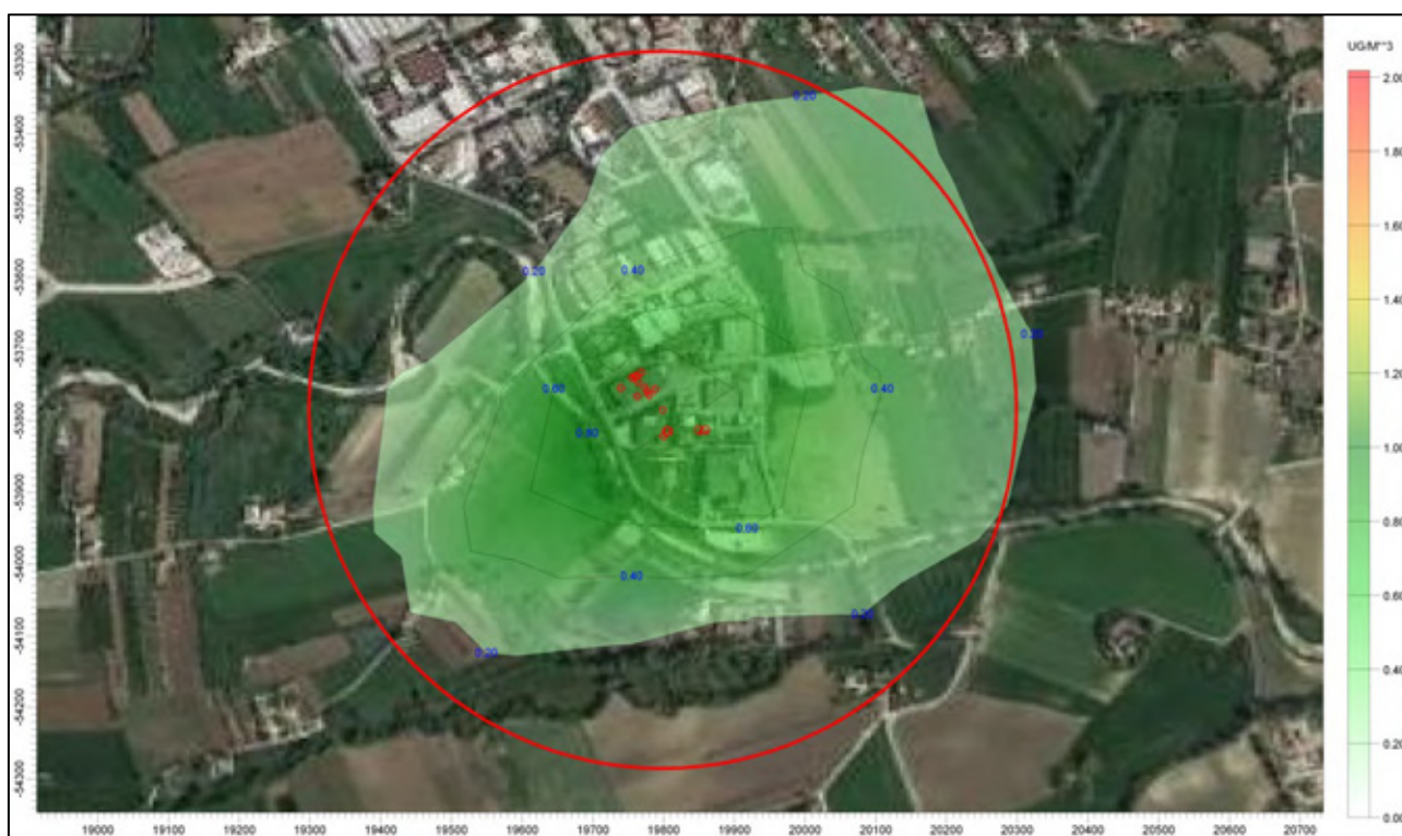
Figura 26: Mappa della concentrazione massime sulle otto ore di idrossido di sodio nell'anno 2017 [ \mu\text{g}/\text{m}^3 ]. Emissioni dall'azienda in esercizio nello stato di progetto.
