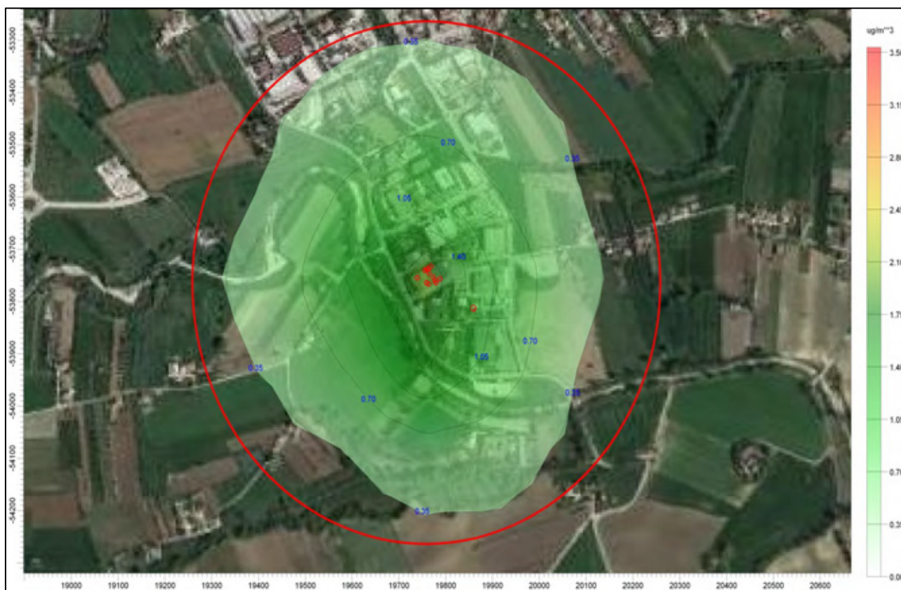
Figura 24: Mappa della concentrazione massime annuali di SOV tot nell'anno 2017 [ \mu\text{g}/\text{m}^3 ]. Emissioni dall'azienda in esercizio nello stato di fatto. Il cerchio rosso ha raggio di 500 m.
