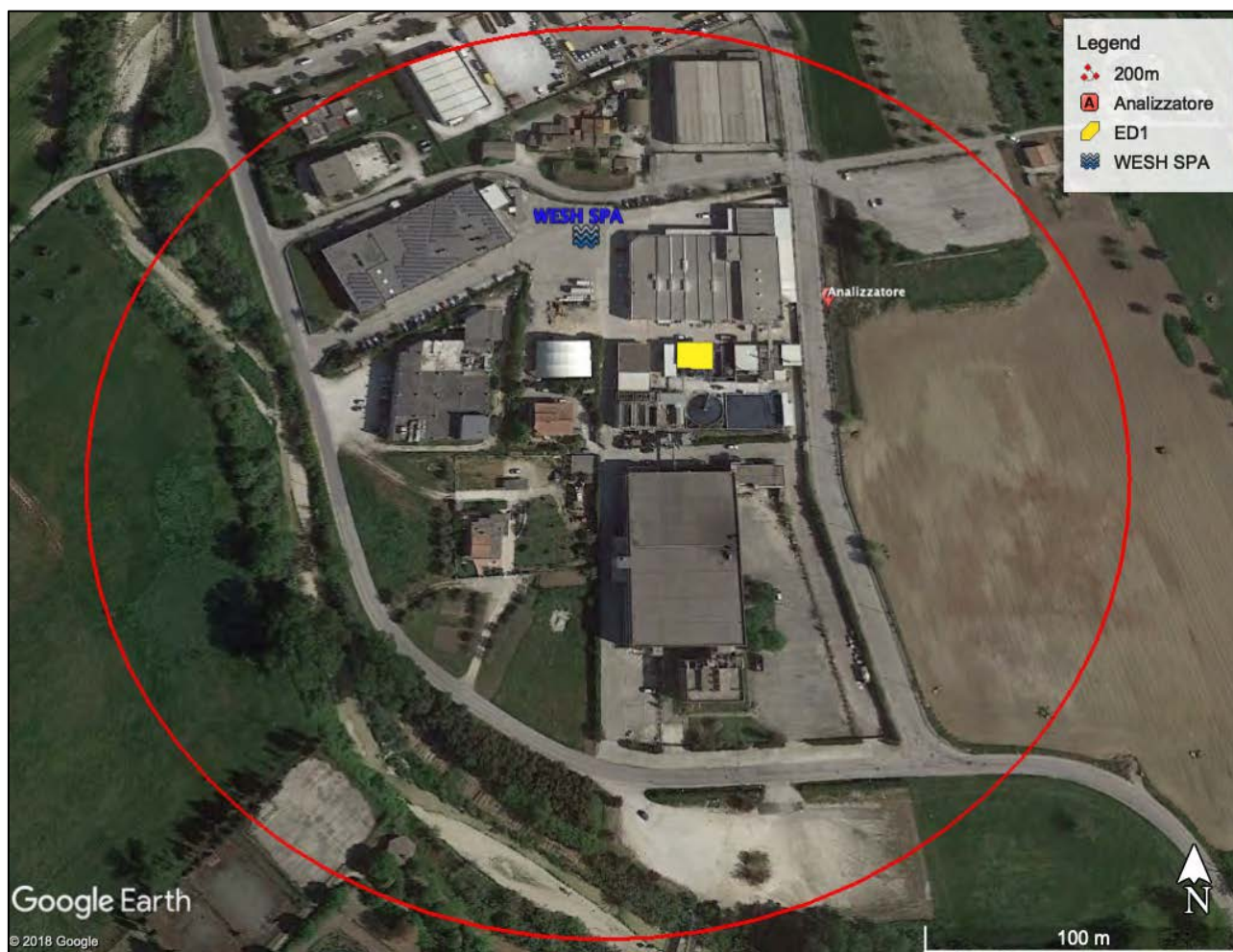
Figura 12: Posizione degli analizzatori (A) installati rispetto all'emissione diffusa analizzata (ED1). Il cerchio rosso ha raggio di 200 m.
