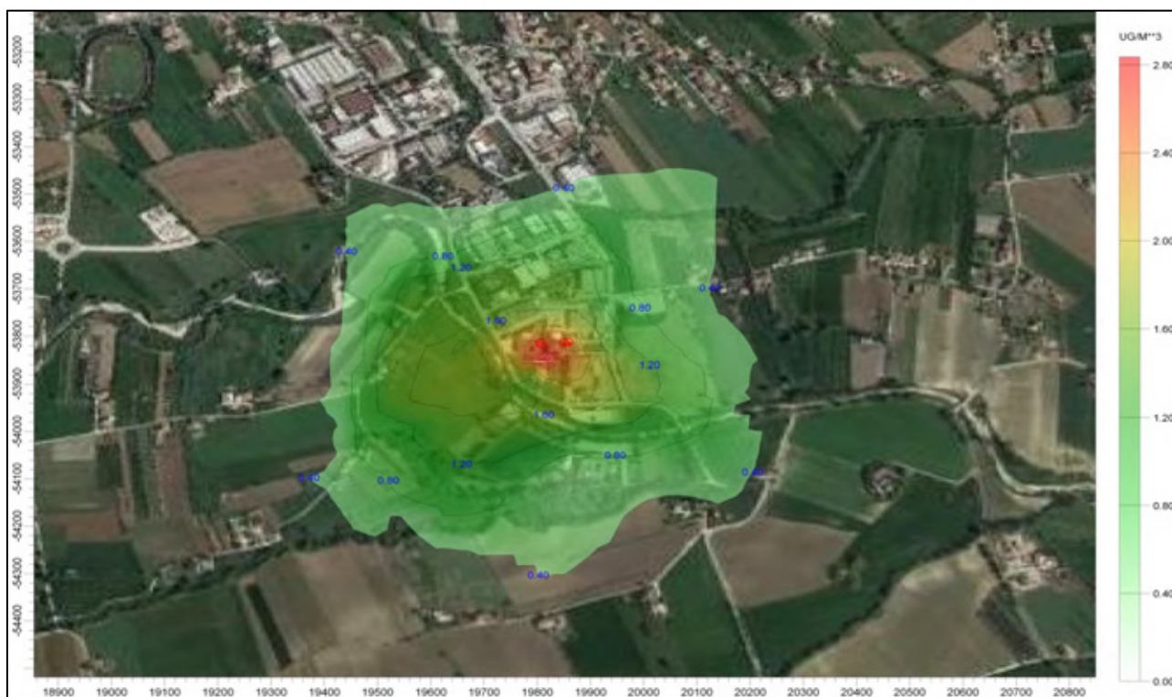
Figura 15: Mappa della concentrazione massime orarie di idrogeno solforato per il 29 luglio 2017 [ \mu\text{g}/\text{m}^3 ]. Emissioni dall'azienda in esercizio nello stato di progetto.
