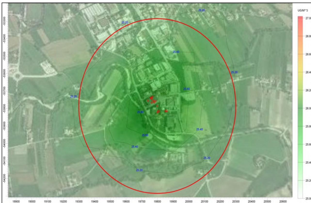
Figura 23: Mappa della concentrazione massime giornaliere di PM10 nell'anno 2017 [ \mu\text{g}/\text{m}^3 ]. Emissioni dall'azienda in esercizio nello stato di progetto integrate con il valore di fondo riferito al comune di Nereto (TE) ( 25 \mu\text{g}/\text{m}^3 ). Il cerchio rosso ha raggio di 500 m.
