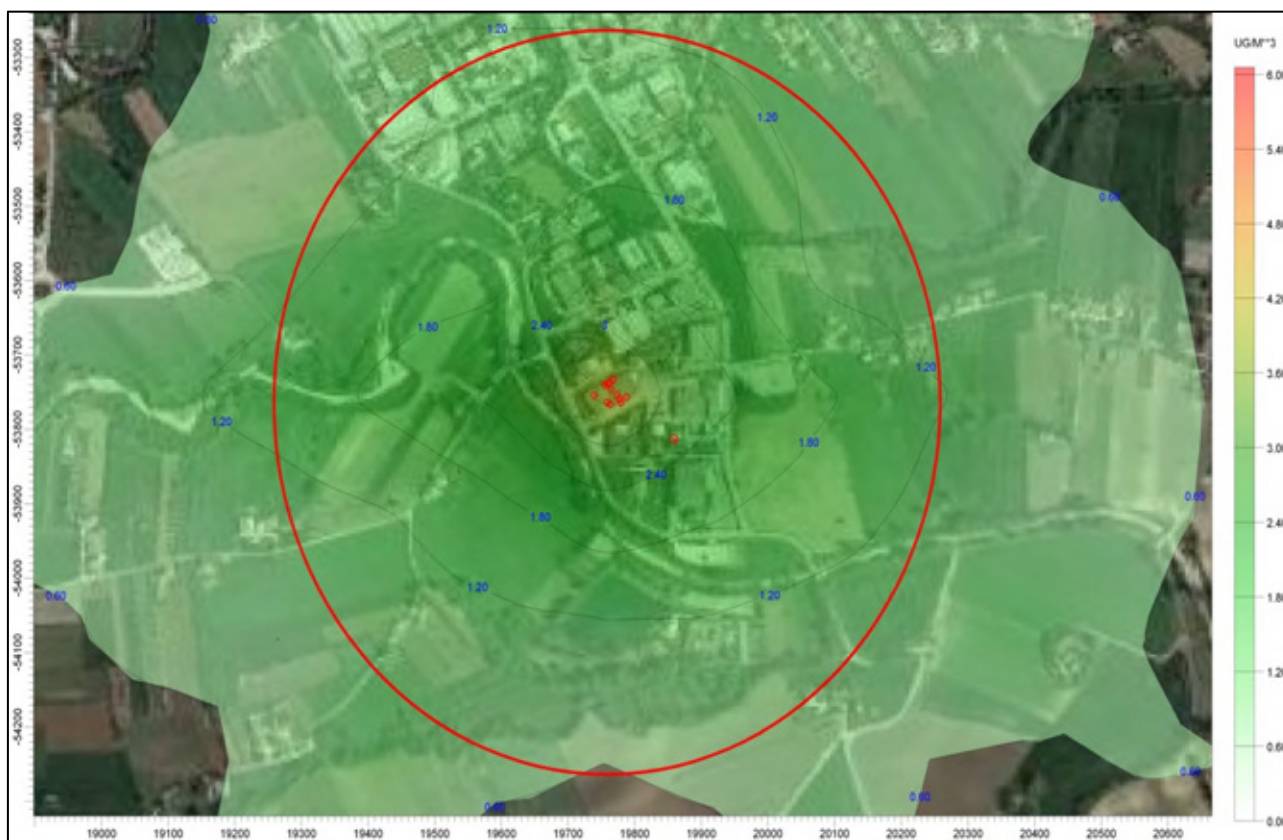
Figura 14: Mappa della concentrazione massime orarie di cloro nell'anno 2017 [ \mu\text{g}/\text{m}^3 ]. Emissioni dall'azienda in esercizio nello stato di fatto. Il cerchio rosso ha raggio di 500 m.
