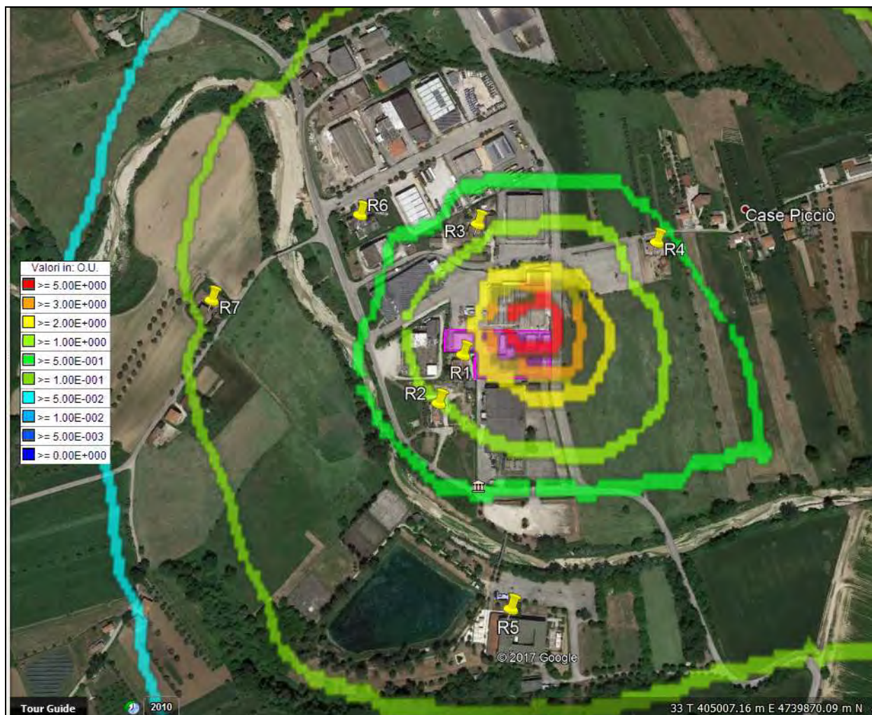
FIGURA 8.1.2.1: Curve di isolivello 98° percentile concentrazioni di picco di odore presso i recettori più prossimi [OU E /m 3 ] – stato di progetto
