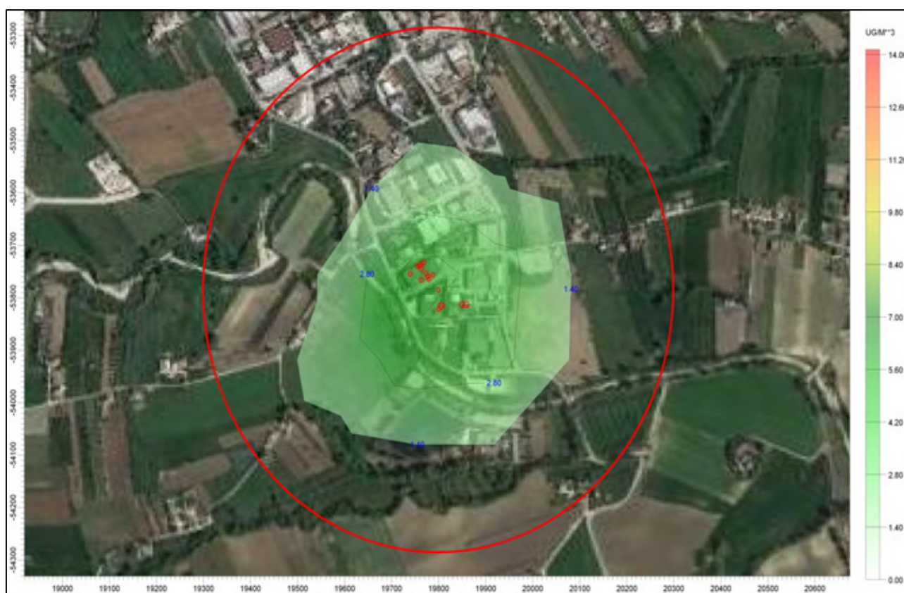
Figura 19: Mappa della concentrazione massime orarie di ammoniaca nell'anno 2017 [ \mu\text{g}/\text{m}^3 ]. Emissioni dall'azienda in esercizio nello stato di progetto. Il cerchio rosso ha raggio di 500 m.
