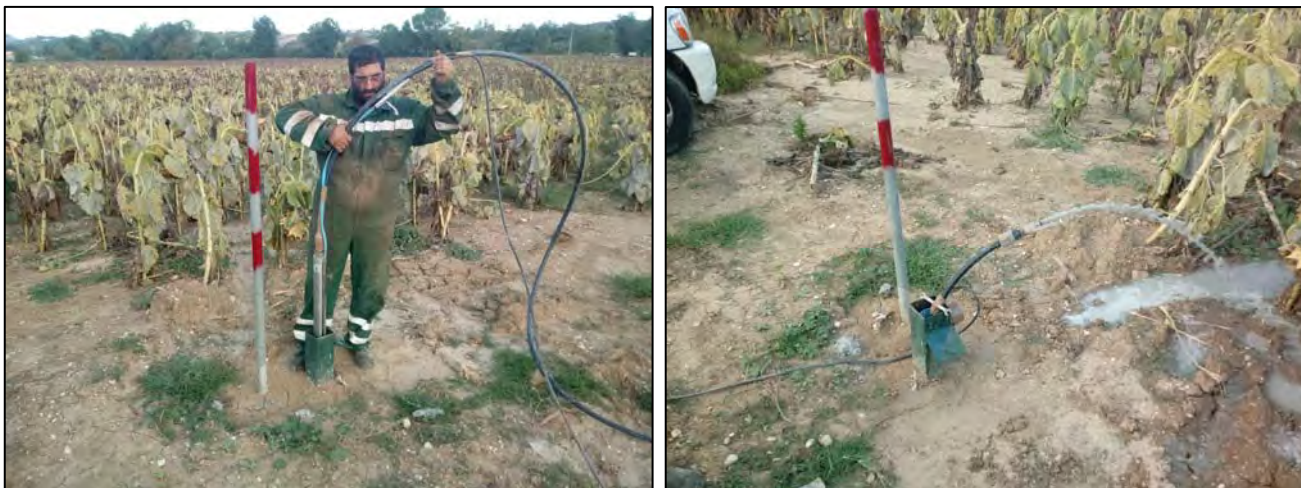
Fig.3: Fasi dello spurgo dei piezometri.
