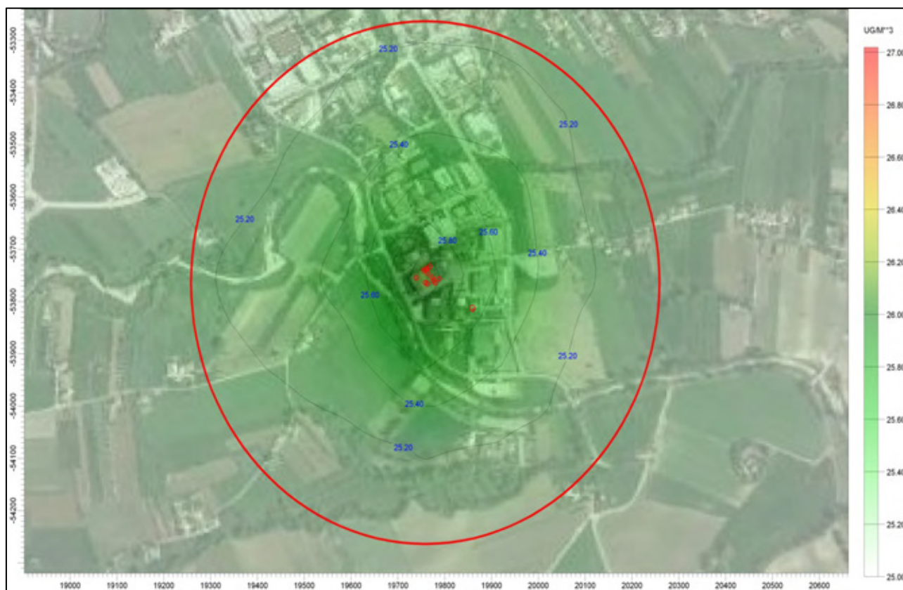
Figura 22: Mappa della concentrazione massime giornaliere di PM10 nell'anno 2017 [ \mu\text{g}/\text{m}^3 ]. Emissioni dall'azienda in esercizio nello stato di fatto integrate con il valore di fondo riferito al comune di Nereto (TE) ( 25 \mu\text{g}/\text{m}^3 ). Il cerchio rosso ha raggio di 500 m.
