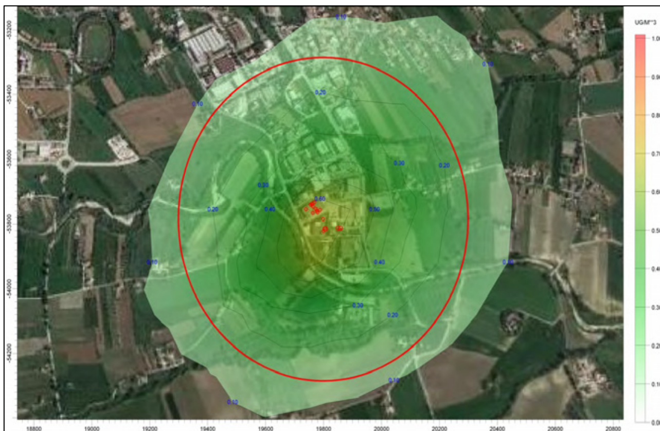
Figura 16: Mappa della concentrazione massime orarie di idrogeno solforato nell'anno 2017 [ \mu\text{g}/\text{m}^3 ]. Emissioni dall'azienda in esercizio nello stato di progetto. Il cerchio rosso ha raggio di 500 m. Il cerchio rosso ha raggio di 500 m.
