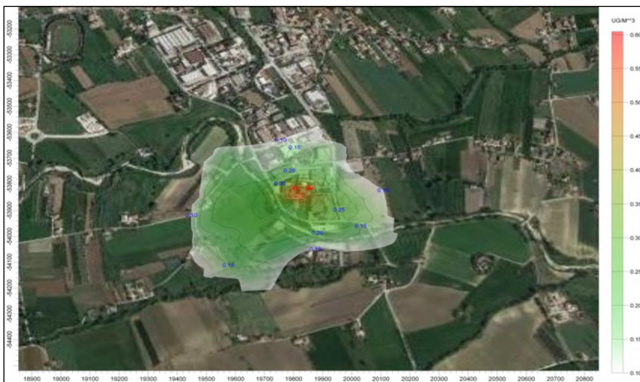
Figura 16: Mappa della concentrazione massime giornaliere di idrogeno solforato per il 29 luglio 2017 [ \mu\text{g}/\text{m}^3 ]. Emissioni dall'azienda in esercizio nello stato di progetto.
