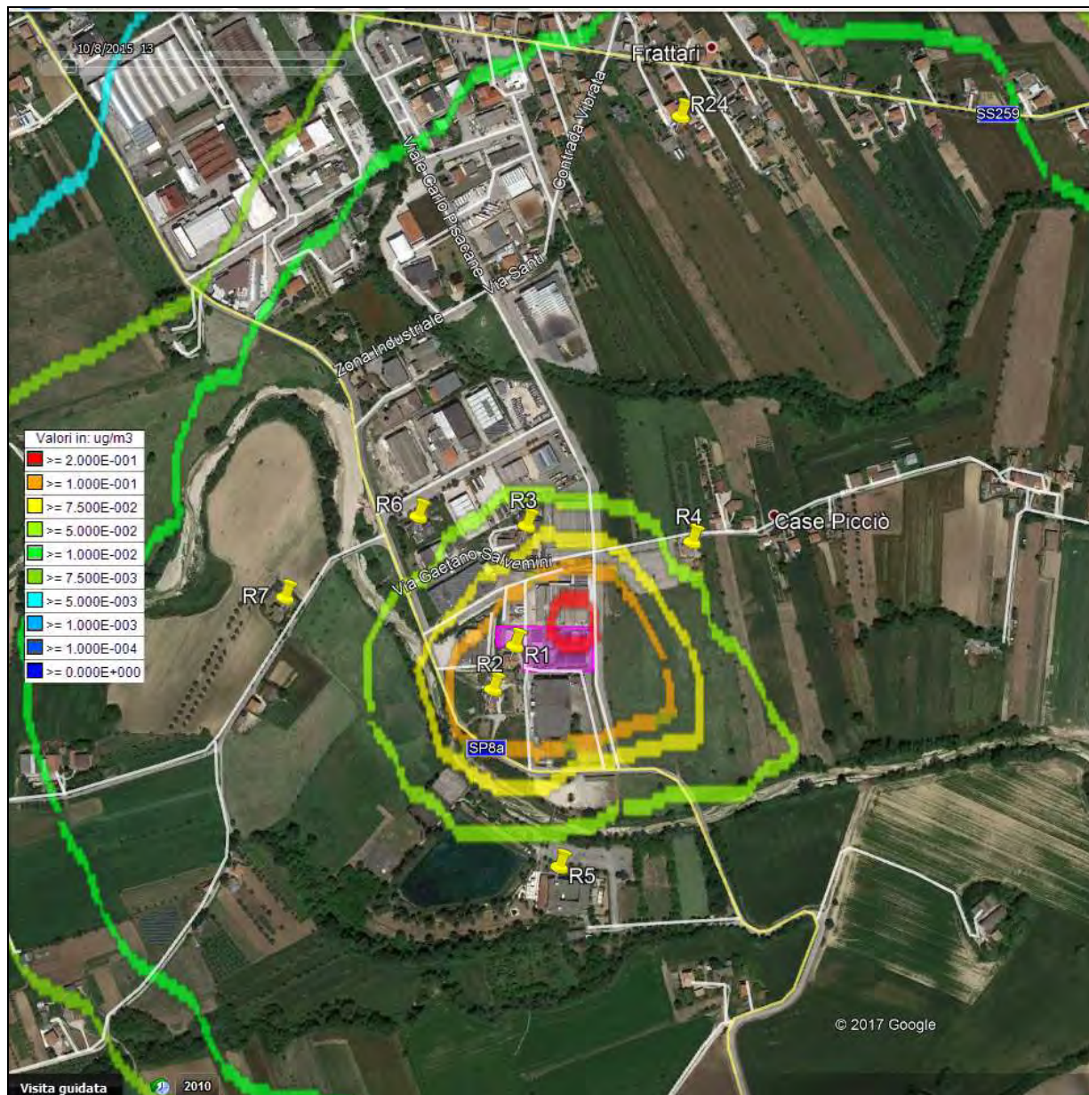
FIGURA 8.2.4.1: Curve di isolivello delle concentrazioni medie annuali di H 2 S presso i recettori più prossimi [µg/m 3 ] – stato di progetto
