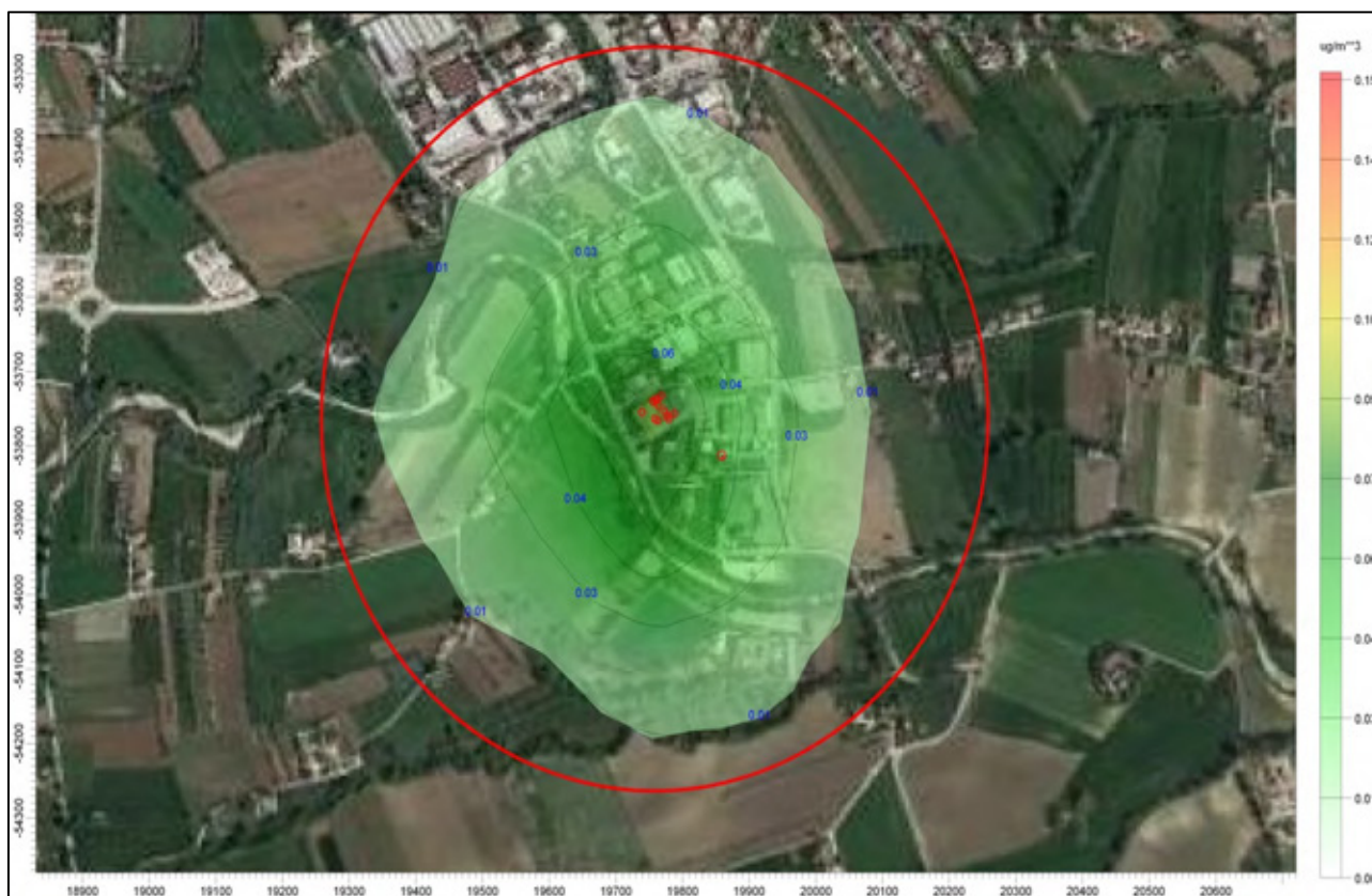
Figura 17: Mappa della concentrazione medie annue per il permanganato di potassio nell'anno 2017 [ \mu\text{g}/\text{m}^3 ]. Emissioni dall'azienda in esercizio nello stato di fatto. Il cerchio rosso ha raggio di 500 m.
