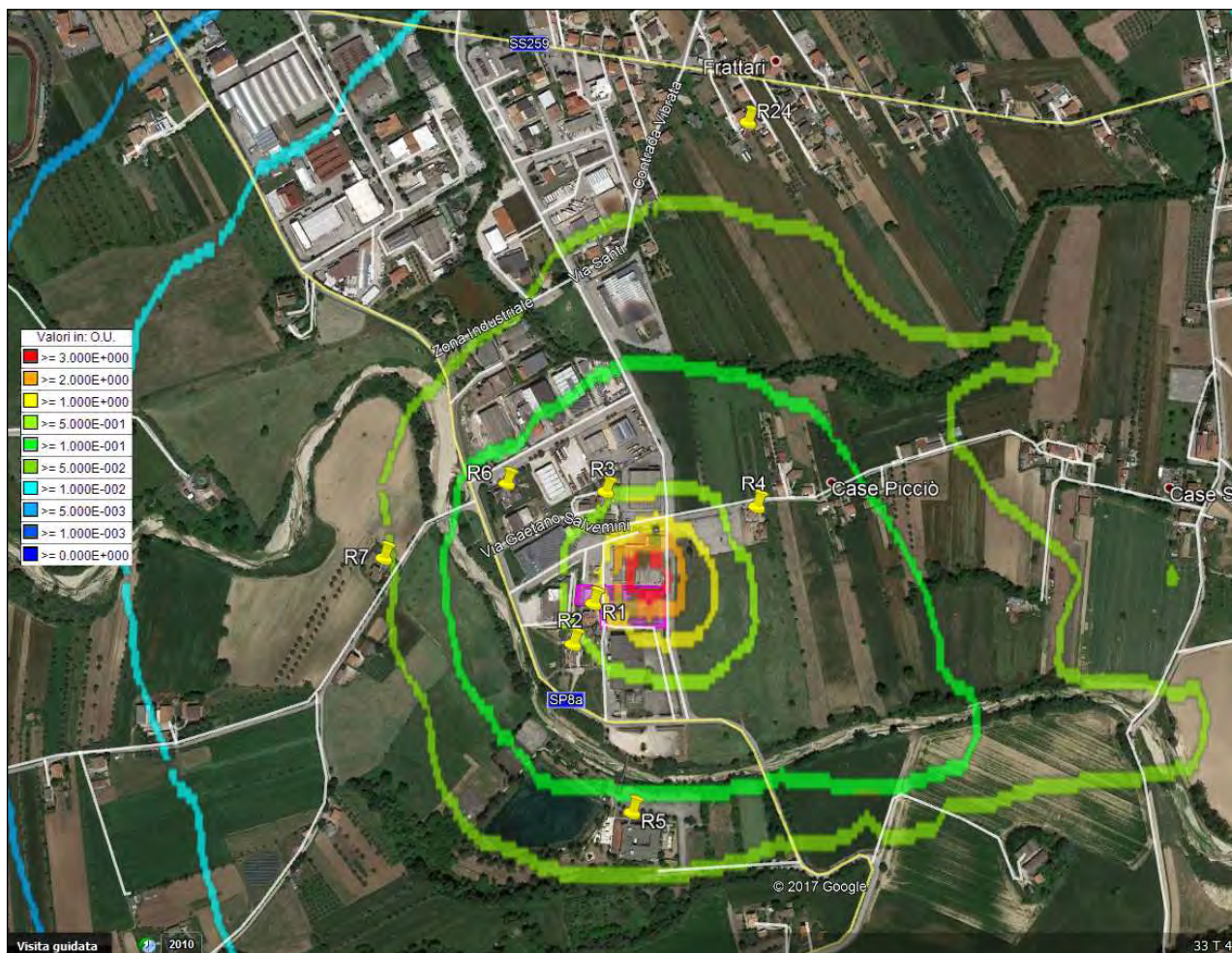
FIGURA 8.1.1.1: Curve di isolivello 98° percentile concentrazioni di picco di odore presso i recettori più prossimi [OU E /m 3 ] – stato di fatto
