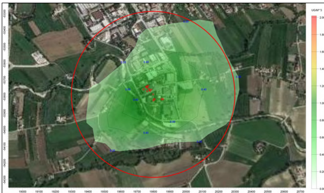
Figura 25: Mappa della concentrazione massime sulle otto ore per l'acido solforico nell'anno 2017 [ \mu\text{g}/\text{m}^3 ]. Emissioni dall'azienda in esercizio nello stato di progetto. Il cerchio rosso ha raggio di 500 m.
