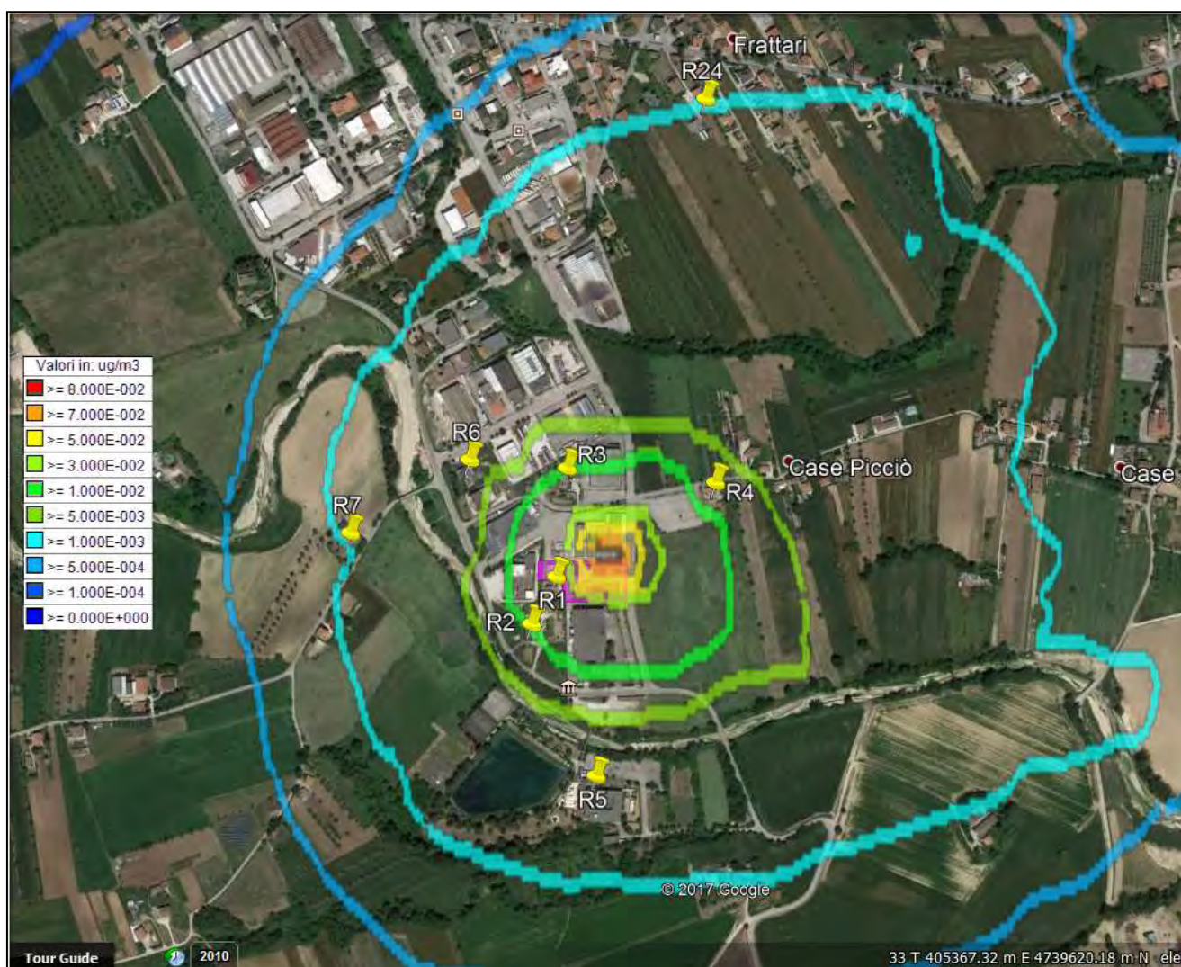
FIGURA 8.2.3.1: Curve di isolivello delle concentrazioni medie annuali di NH 3 presso i recettori più prossimi [µg/m 3 ] – stato di fatto
