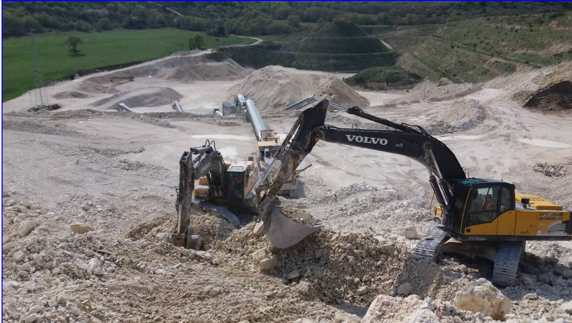
Foto 1 - Escavatore con benna rovescia al lavoro
