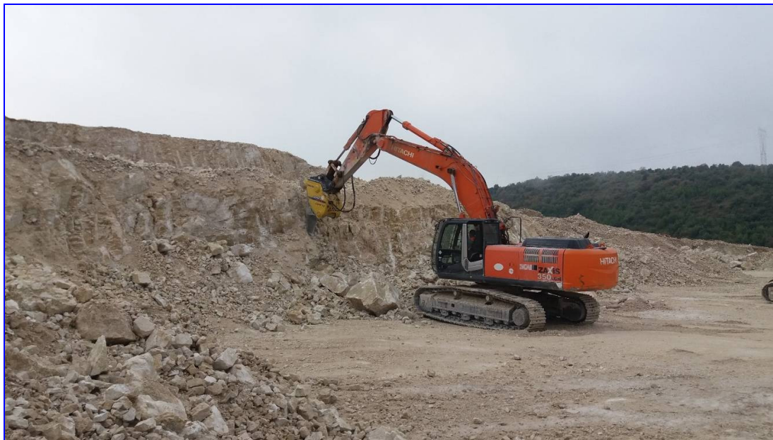
Foto 2 - Escavatore con Vibro-ripper su fronte compatto
