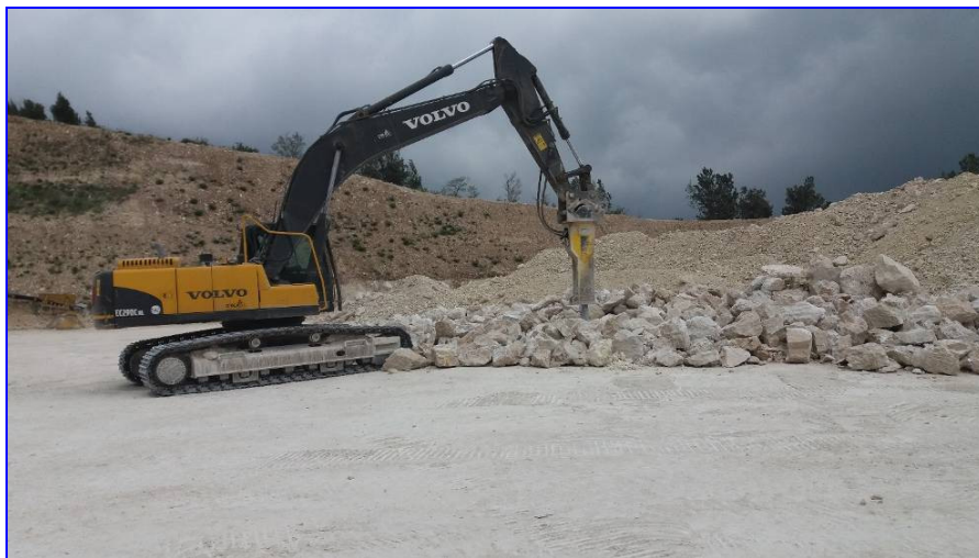
Foto 4 – Escavatore con martello demolitore
