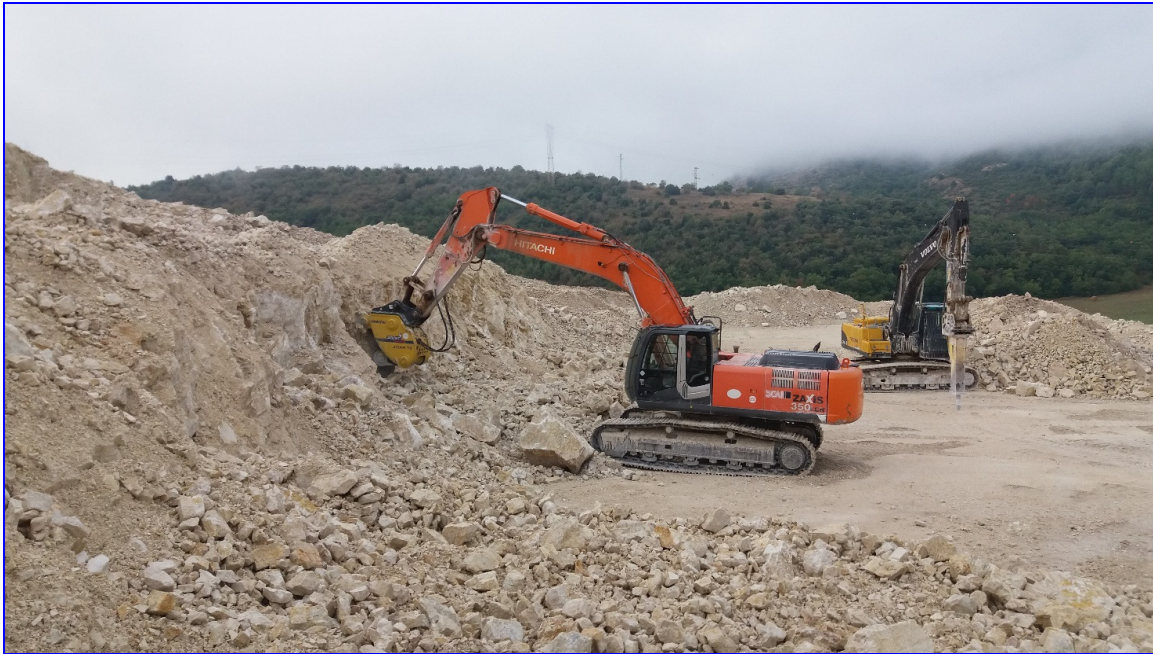
Foto 3 – Vista del materiale prodotto dall'escavatore con Vibro-ripper
