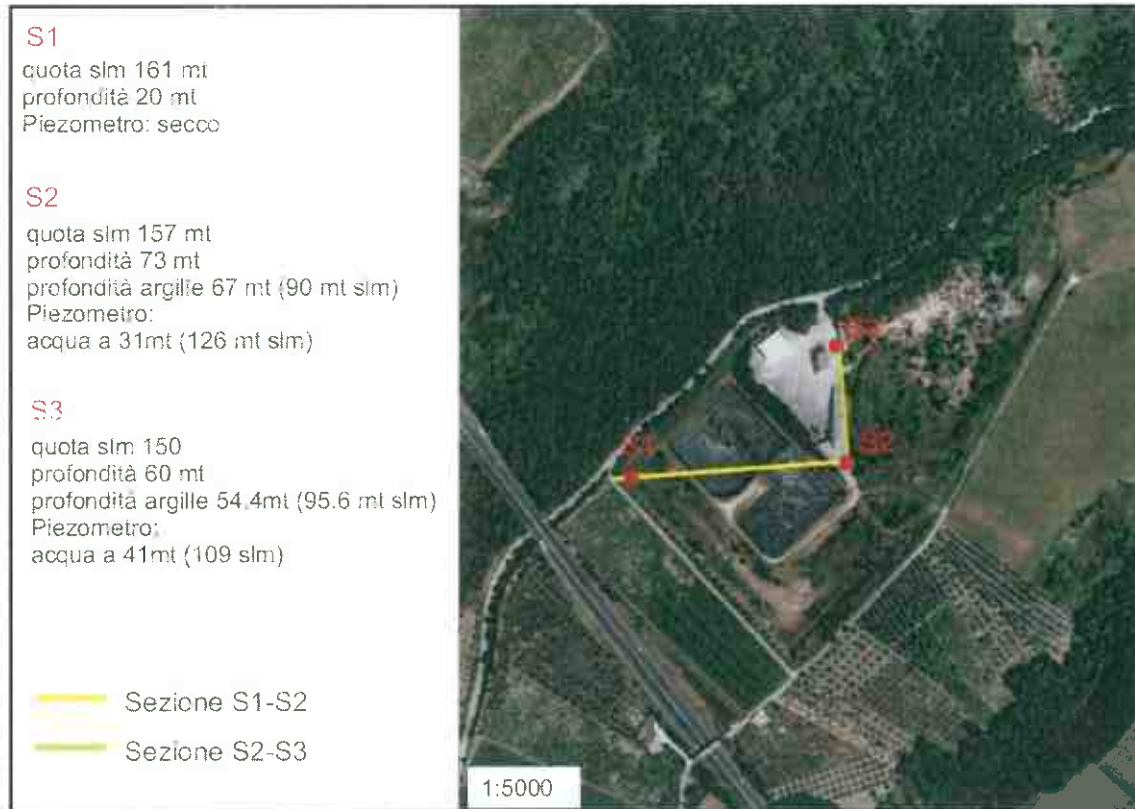
Figura 8. Ubicazione dei sondaggi geognostici eseguiti (dalla Relazione geologica).
