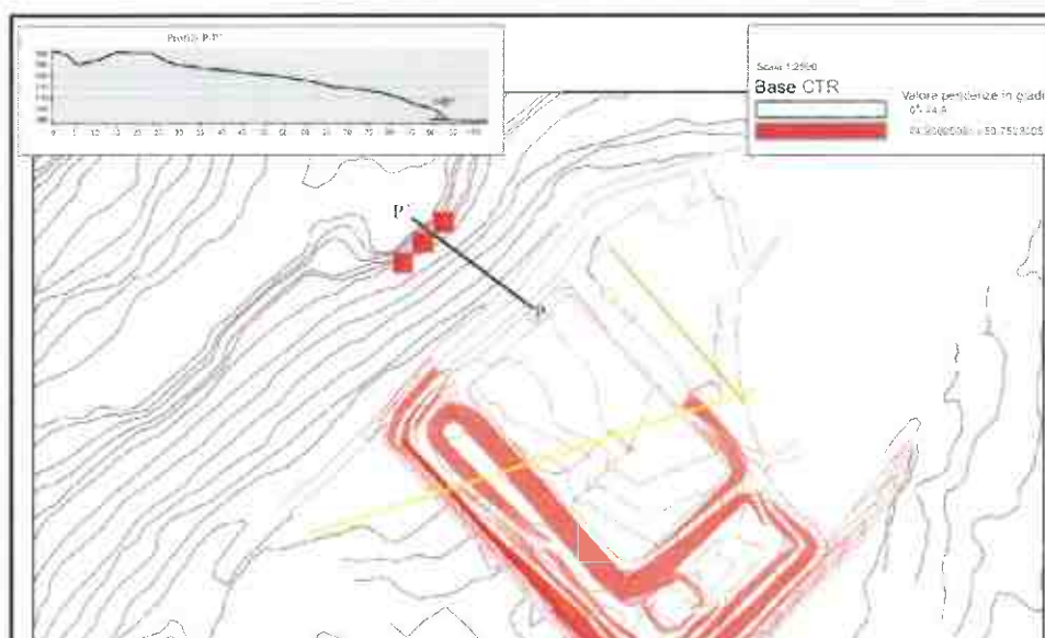
Figura 10: Carta delle pendenze e profilo topografico per la valutazione della presenza di scarpate, così come riportato nella Relazione geologica.
