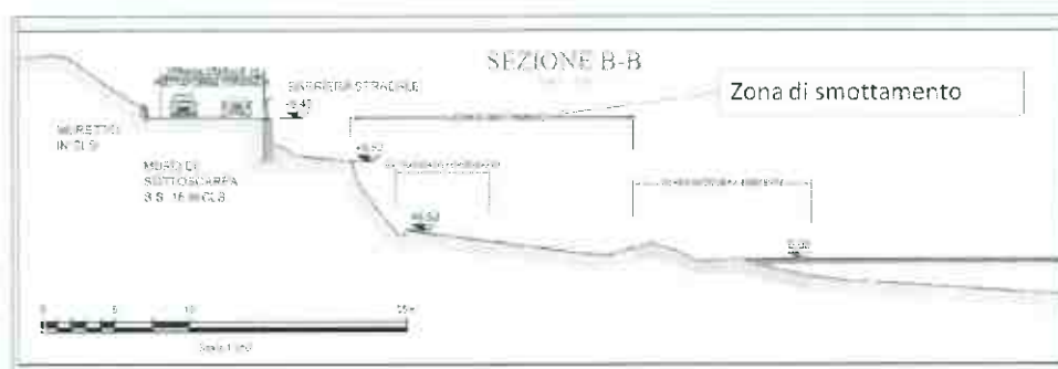
Fig. 3 Sezione tipo della zona oggetto dello smottamento e del processo erosivo.
