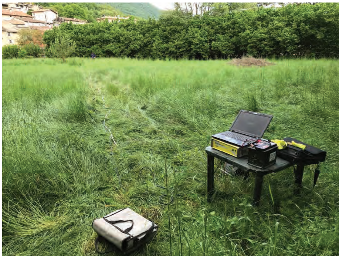
Esecuzione delle prove M.A.S.W. e sismica a rifrazione
