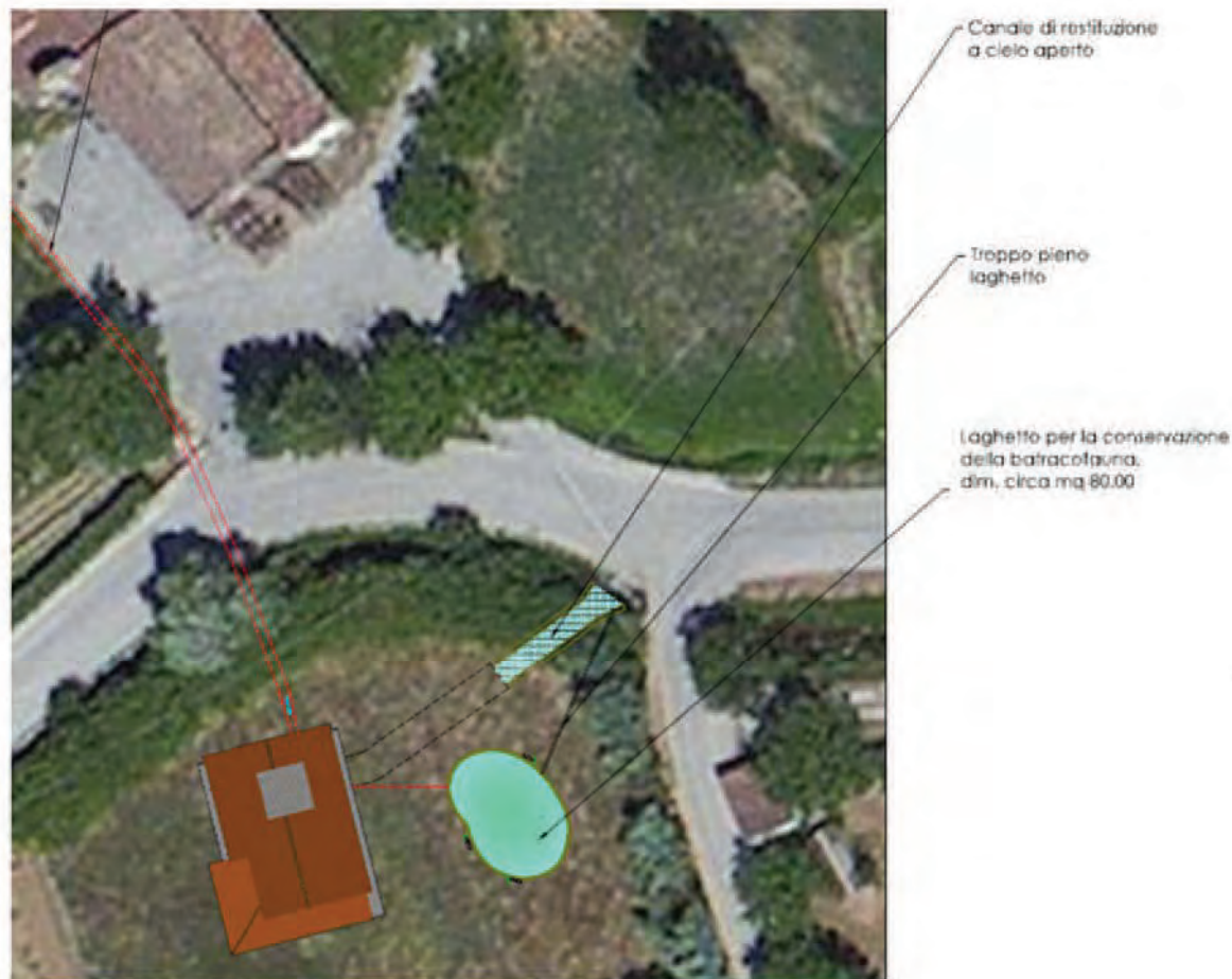
Posizionamento edificio di centrale e laghetto
