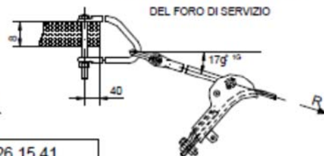
VERIFICA DEL CARICO DI ROTTURA DEL FORO DI SERVIZIO
