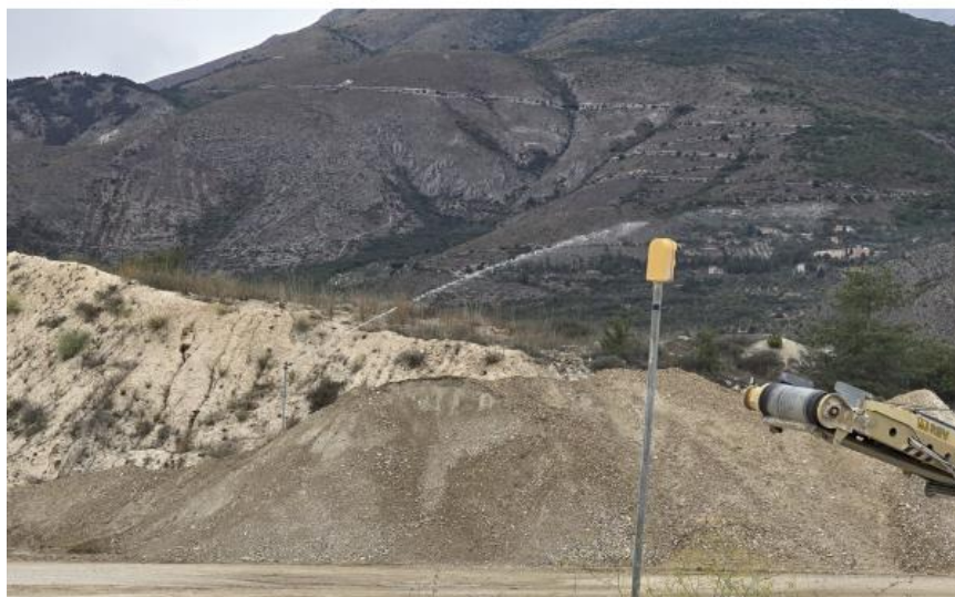
Foto 5 - Rete ugelli nebulizzatori per abbattimento polverosità- area stoccaggio cumuli
