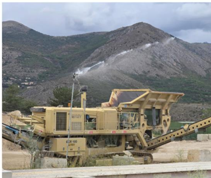
Foto 5 - Rete ugelli nebulizzatori per abbattimento polverosità- area stoccaggio cumuli
