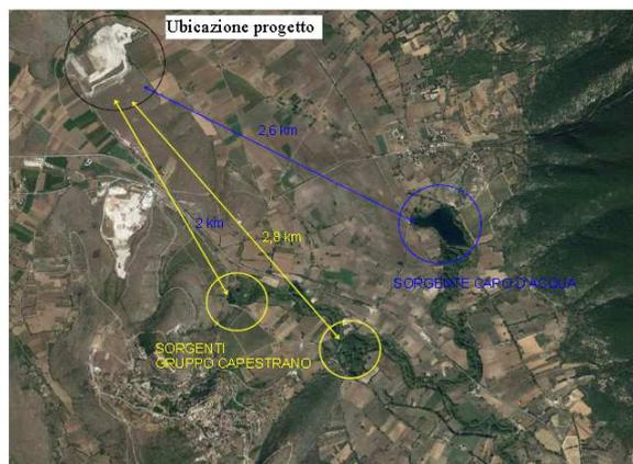
Nello studio è stato condotto sia un Sondaggio Elettrico Verticale e una investigazione diretta su due piezometri che si aggiungono ad un pozzo presente immediatamente all'esterno dell'area di progetto. Tra Gennaio e Giugno 2021, mensilmente è stato monitorato il livello freaticometrico nel pozzo che è risultato compreso tra -17,53 m e -17,62 m dal piano campagna.
