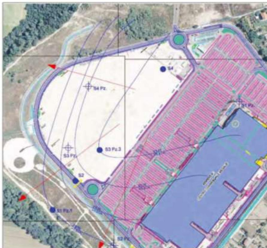
Figura 2.2.2VI: Stralcio della Carta delle isofreatiche in corrispondenza dell'area di progetto (Fonte: "Relazione geologica e modellazione sismica redatta" da Tecnosoil Engineering s.r.l. nel 2017 per la "REALIZZAZIONE DI EDIFICI COMMERCIALI - NO FOOD - P.R.U.S.S.T. 7 - 93 - II ACCORDO DI PROGRAMMA DEL 15.06.2004").
