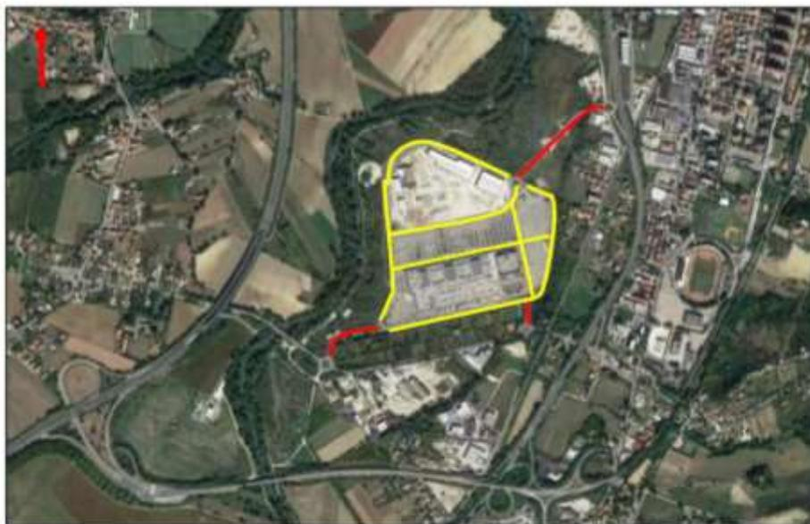
Viabilità nel comparto in esame: in rosso collegamento con la viabilità esterna, in giallo viabilità interna.
