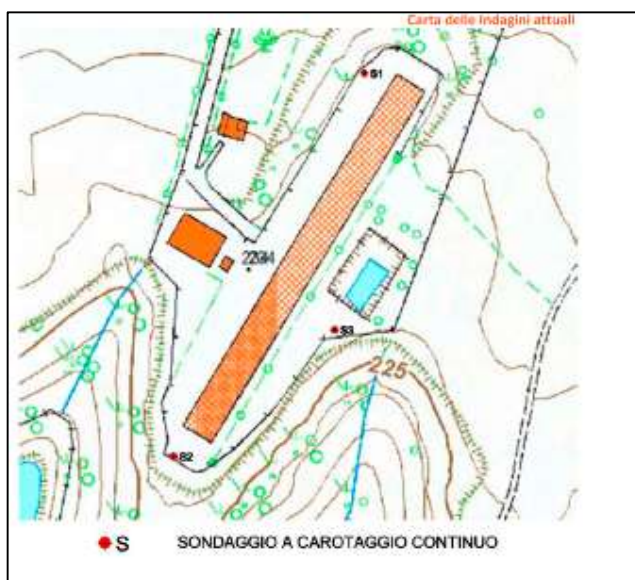
Figura 1. Ubicazione nuovi sondaggi - I sondaggi sono stati effettuati in data 10-11-12 Ottobre 2023
