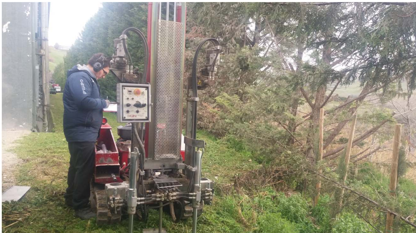
Figura 1 - Ubicazione prova penetrometrica dinamica DPSH 1.
