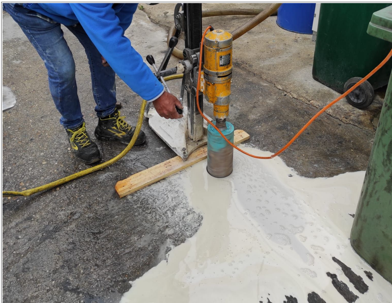
Foto 5: Esecuzione di sondaggio con carotatrice Piazzale Area A
