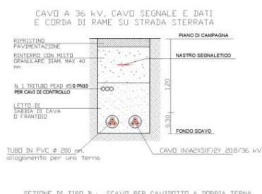
Figura 75 Sezione trincea elettrodotto
