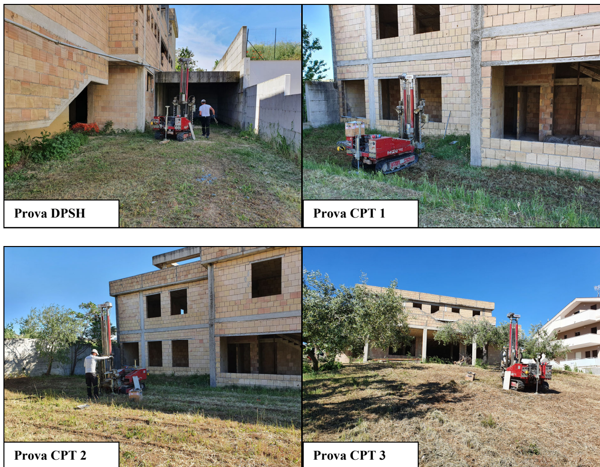
Figura 5.2: – Ubicazione delle prove penetrometriche DPSH (immagine di sinistra) e CPT (immagine di destra)
