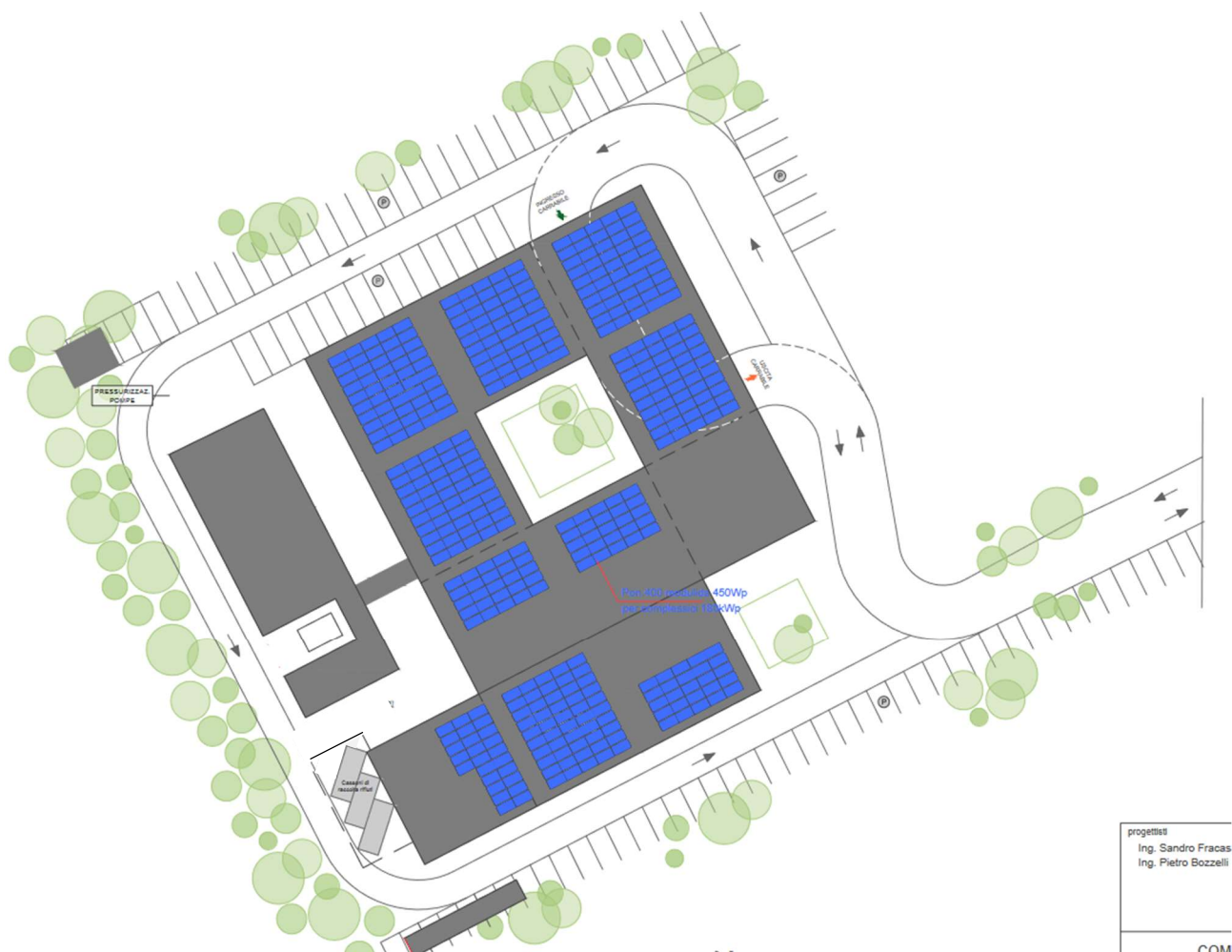
Figura 20 – Schema di principio dell'impianto fotovoltaico da 180 kW sul tetto verde
