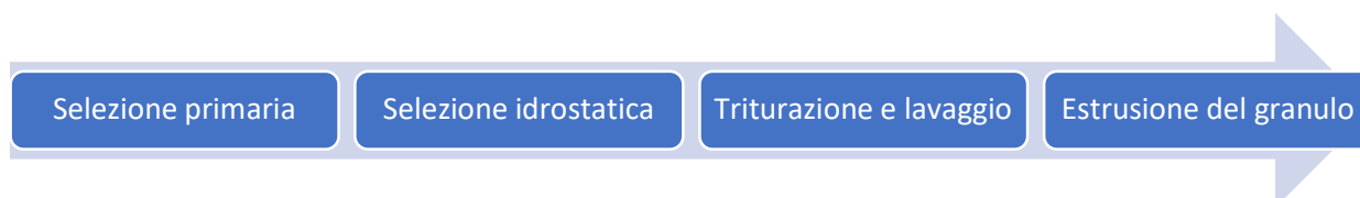
Figura 16 – Flusso del processo di recupero dei rifiuti di plastica prodotti in agricoltura
