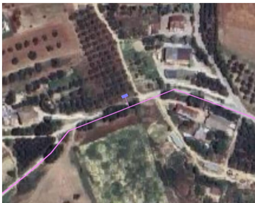
Figura 3 – Dettaglio su ortofoto del posizionamento della nuova cabina di sezionamento (in blu). In magenta il tracciato del cavidotto di connessione alla rete
