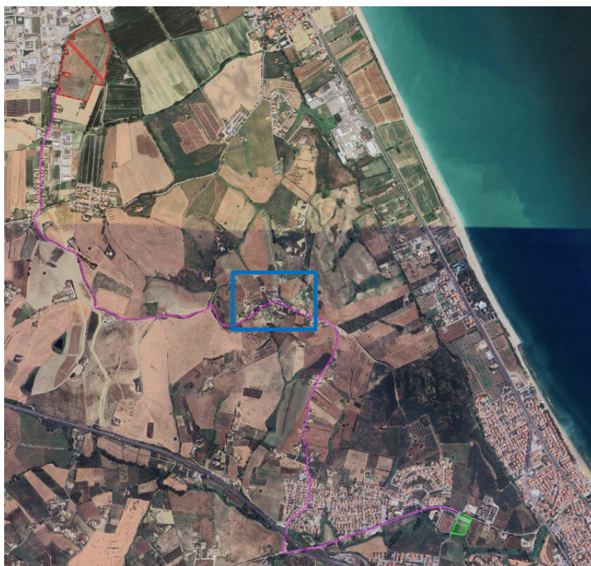
Figura 2 – Sovrapposizione su ortofoto dell’area di impianto (in rosso), del percorso del cavidotto di connessione alla rete (in magenta) e della cabina primaria “Pineto” (in verde). Il riquadro blu indica il posizionamento della cabina di sezionamento
