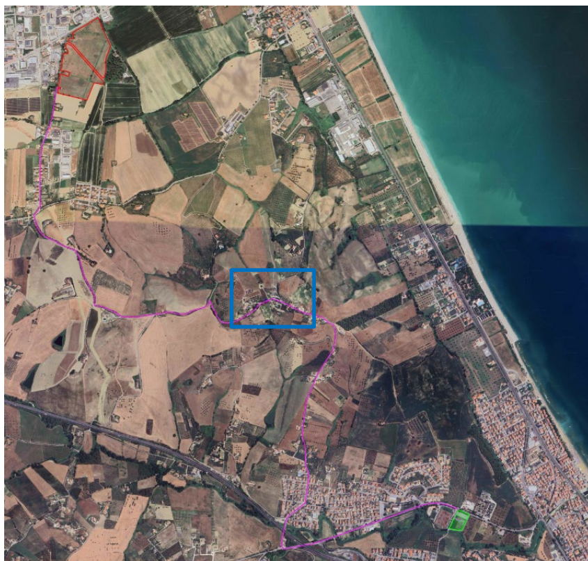
Figura 35 – Sovrapposizione su ortofoto dell’area di impianto (in rosso), del percorso del cavidotto di connessione alla rete (in magenta) e della cabina primaria “Pineto” (in verde). Il riquadro blu indica il posizionamento della cabina di sezionamento
