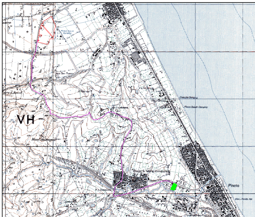
Figura 1 – Estratto dell'elaborato "PIN.ENG.TAV.001. _Inquadramento Territoriale dell'intervento su base IGM". In rosso l'area di impianto, in magenta il cavidotto di connessione alla rete e in verde la "Nuova cabina Primaria Pineto".
