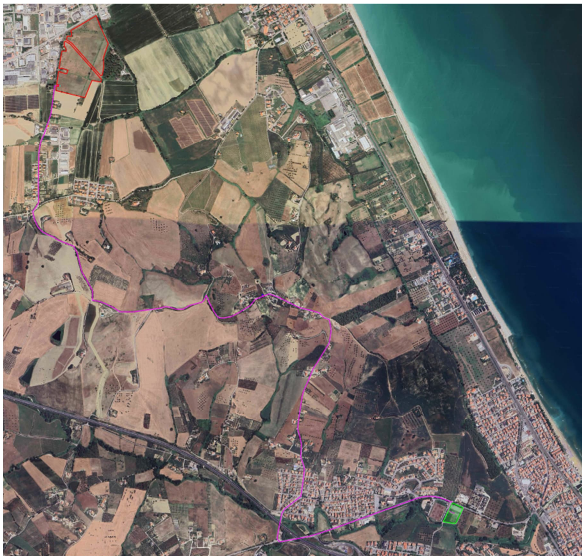
Figura 1 – Sovrapposizione su ortofoto dell’area di impianto (in rosso), del percorso del cavidotto di connessione alla rete (in magenta), della cabina di consegna (in azzurro) e della cabina primaria “Pineto” (in verde).
