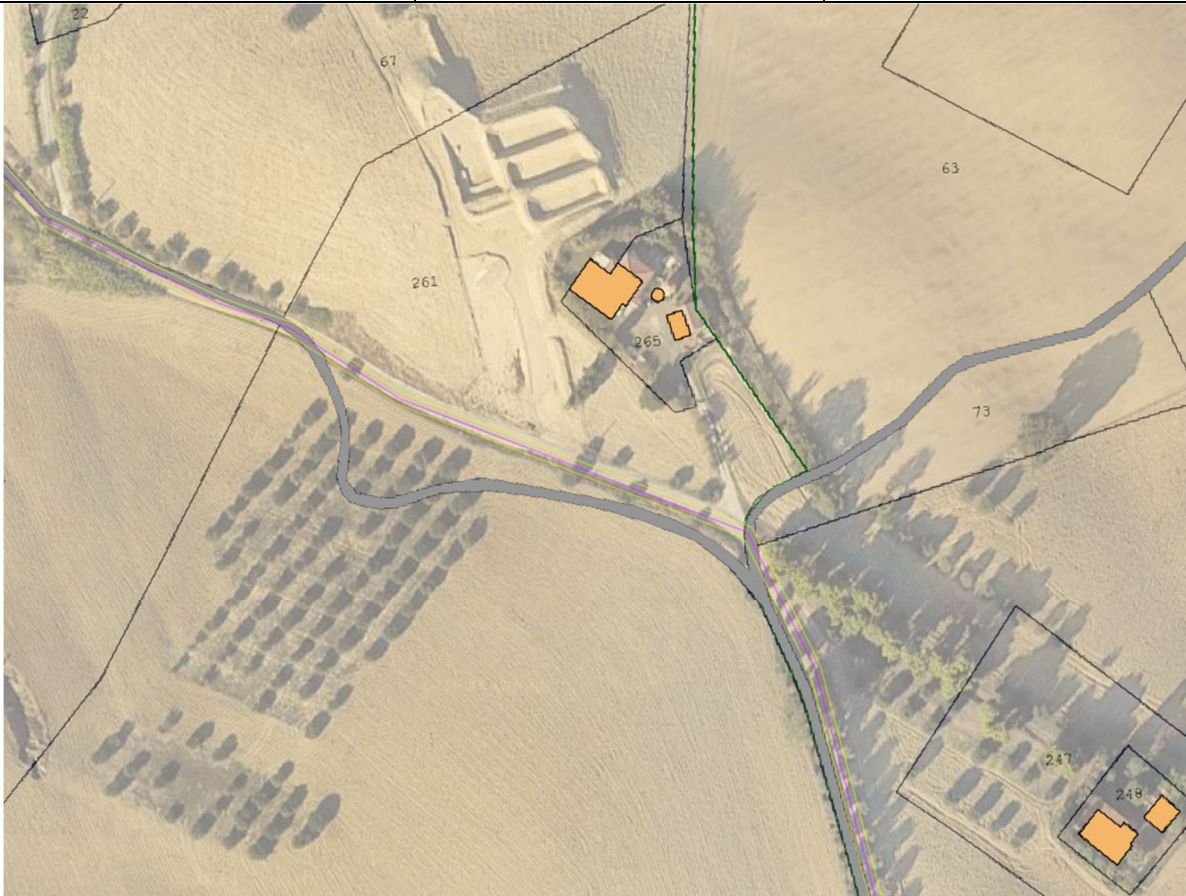
Figura 9 – Esempi di disallineamenti catastali tra le strade pubbliche ed esistenti e il WMS ufficiale dell’agenzia delle Entrate. In Ciano il cavidotto e in Giallo la fascia di asservimento. Si nota come le strade non siano accatastate/allineate come tali.
