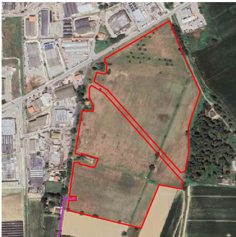
Figura 2 – Dettaglio su ortofoto dell'area di impianto (in rosso), del percorso del cavidotto di connessione alla rete (in magenta), della cabina di consegna (in azzurro) e della cabina "Le colombe" (in verde)
