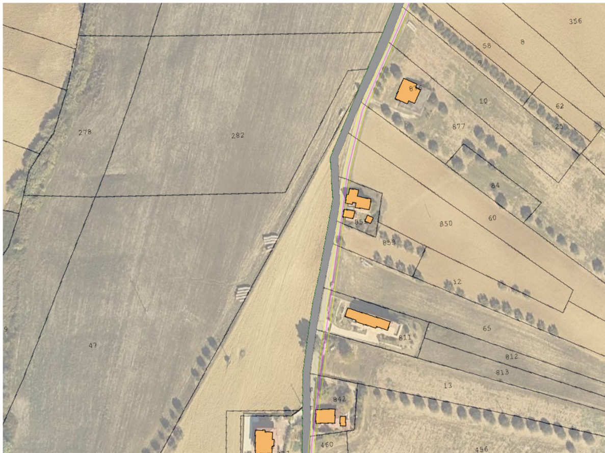
Figura 6 – Esempi di disallineamenti catastali tra le strade pubbliche ed esistenti e il WMS ufficiale dell'agenzia delle Entrate. In Ciano il cavidotto e in Giallo la fascia di asservimento. Si nota come le strade non siano accatastate/allineate come tali.
