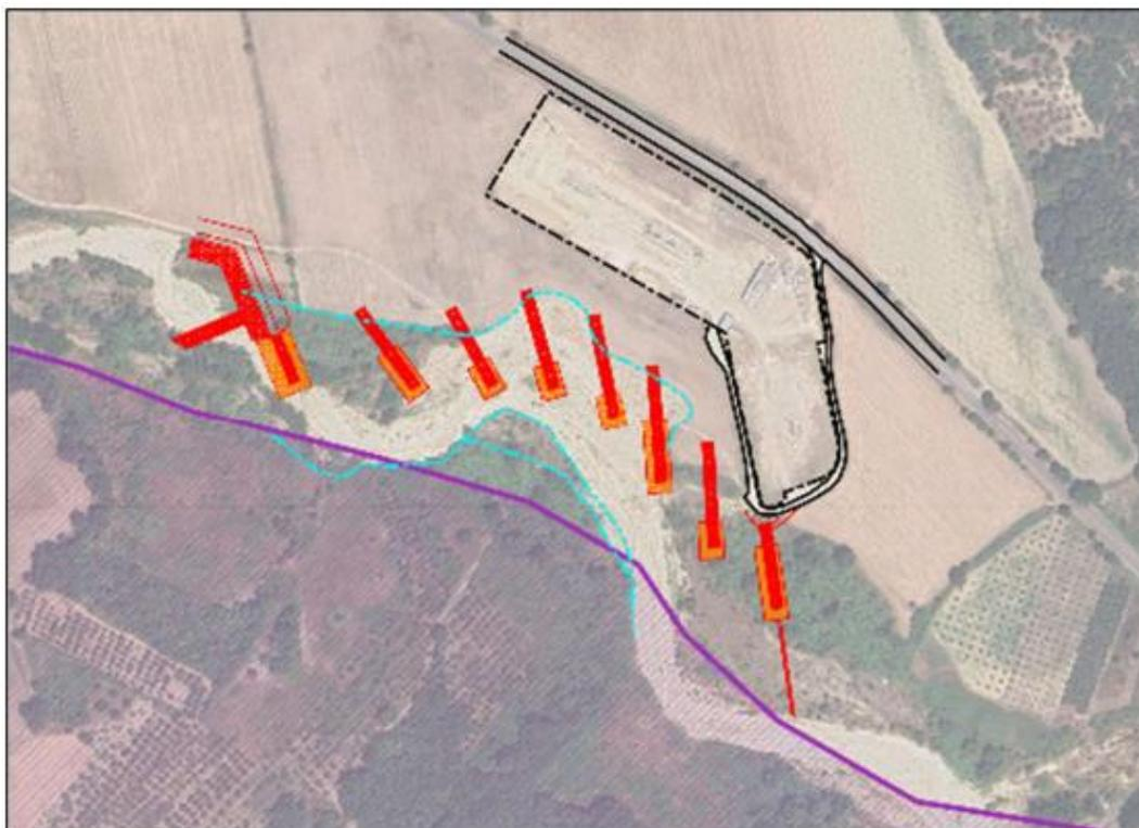
In merito alla scelta progettuale il tecnico scrive che *“l'utilizzo di modelli di simulazione idraulica ha fornito una soluzione efficace per la protezione dell'area impiantistica dall'erosione fluviale. L'effetto “immediato” dei pennelli è quello di tenere il campo ad energia cinetica elevata lontano dalla sponda sinistra deflettendo il campo delle velocità critiche di deflusso verso il “centro alveo”.*
