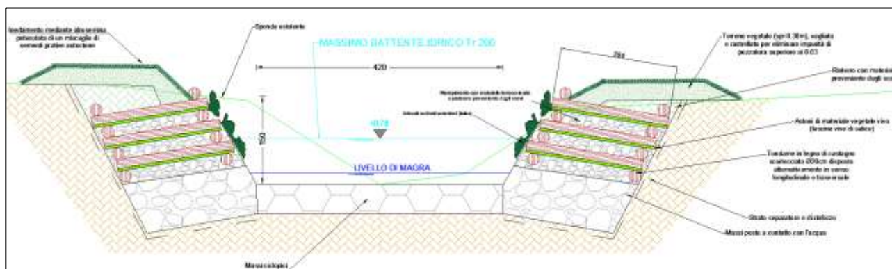
4-5 – Particolare palificata viva a cassone triangolare con regolarizzazione del fondo e riprofilatura delle sponde del fosso.
