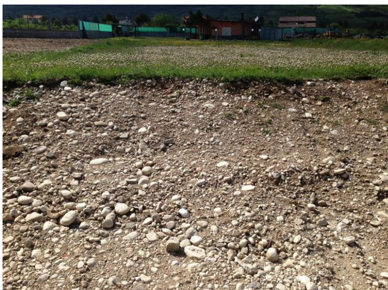
Fig. 11 - Affioramento di deposito alluvionale terrazzato appartenente all'unità geologica (at2) e all'unità litotecnica E3Ib, rilevato all'interno di una proprietà privata in prossimità del F. Zittola
