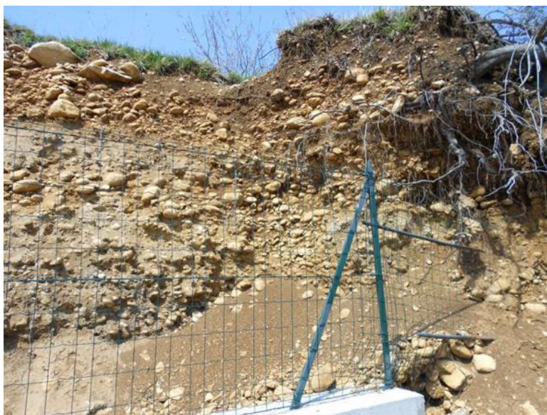
Fig. 10 - Affioramento di deposito alluvionale terrazzato di età pleistocenica (at1) rilevato tra Loc.tà Fornace e Fonte Casadonna in sinistra idrografica del F.Sangro.
