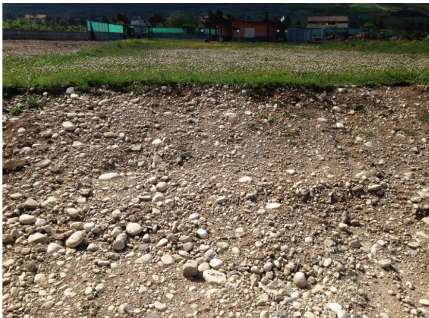
Fig.11 - Affioramento di deposito alluvionale terrazzato appartenente all'unità geologica (at2) e all'unità litotecnica E3lb, rilevato all'interno di una proprietà privata in prossimità del F. Zittola
