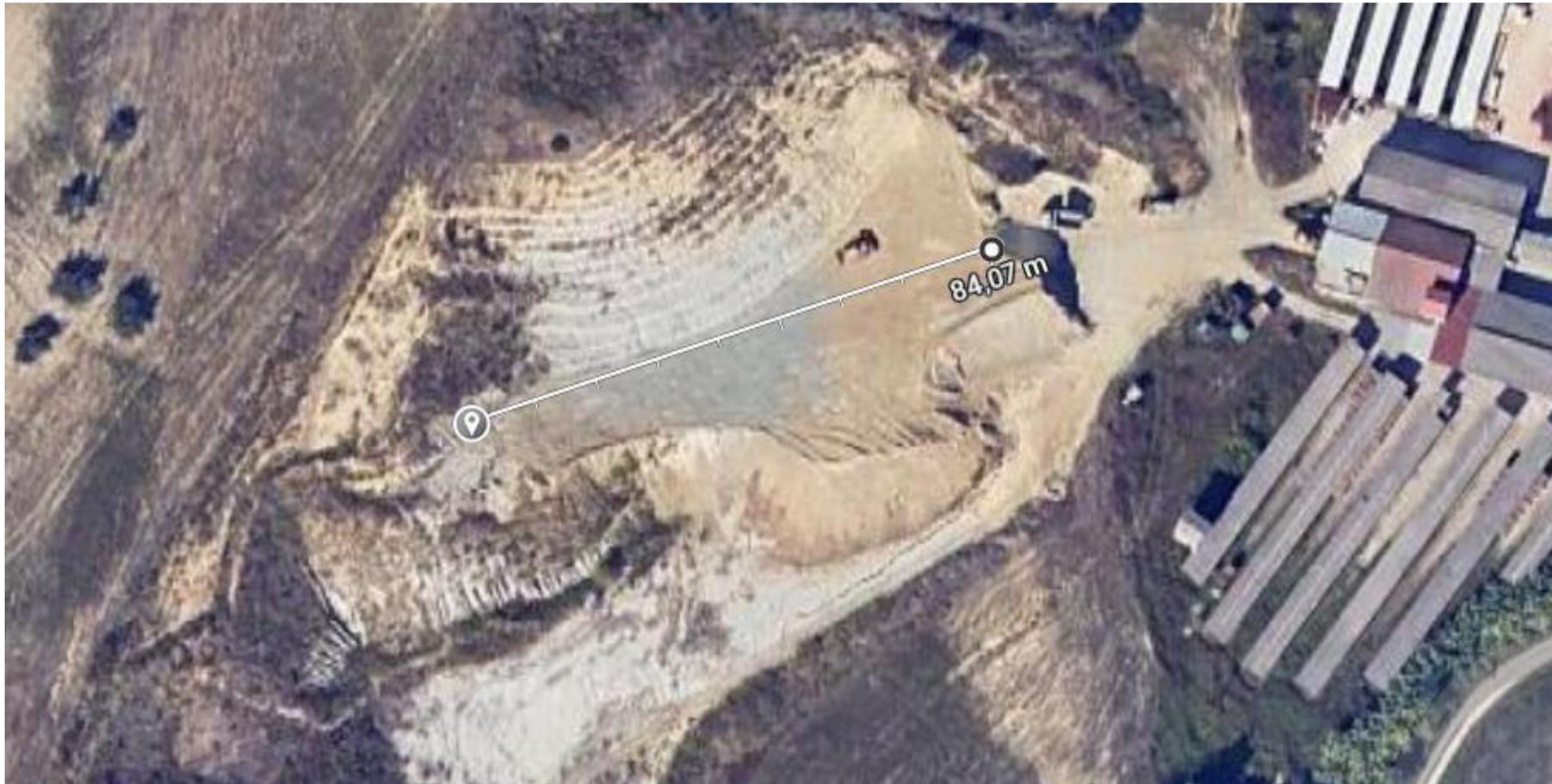
Prelievo delle argille, con l'impiego di escavatore Katerpillar 324; dal punto di escavazione le argille vengono prelevate e caricate su camion da 20 mc, per essere trasportate nel punto di stoccaggio a circa 85,00 m dal punto di prelievo.
