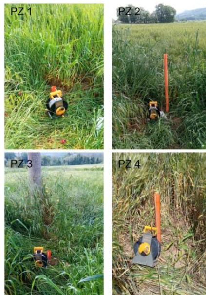
Il Geologo asserisce che nel corso delle perforazioni, e poi successivamente, sono state effettuate ispezioni dei piezometri con freattimetro a segnalazione acustica per verificare la soggiacenza della falda e, considerando la stagione tardo-invernale in cui si è operato e le frequenti precipitazioni che si sono avute nel periodo, il riscontro ha valore rappresentativo delle condizioni locali.
