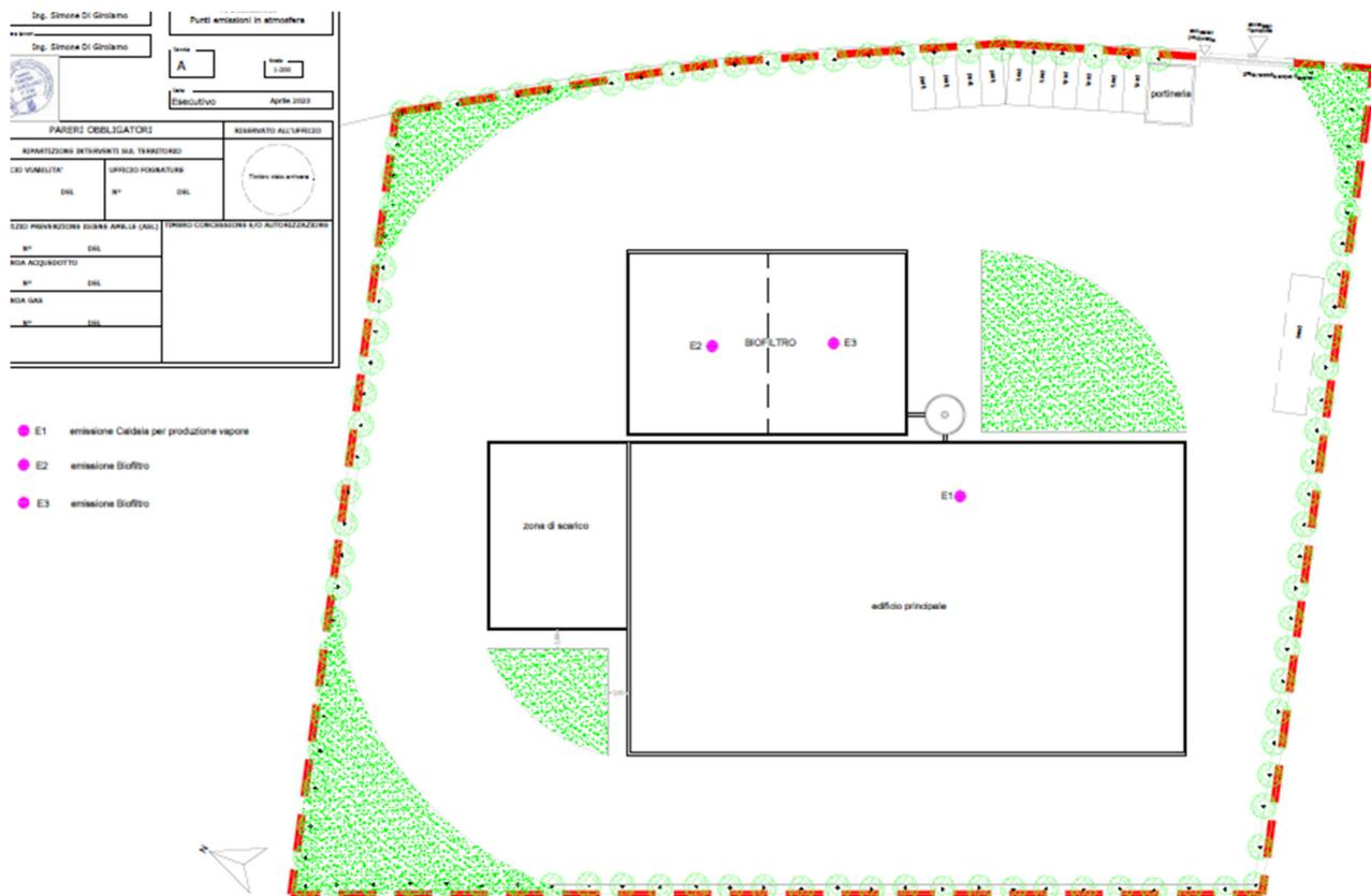
Il tecnico dichiara che per entrambi i biofiltri (BIOF\_1, BIOF\_2), il rapporto tra la portata e la superficie emissiva risulta superiore a  $50 \text{ m}^3/\text{h} \cdot \text{m}^2$ , per cui **le sorgenti sono di tipo areale a flusso indotto**.
