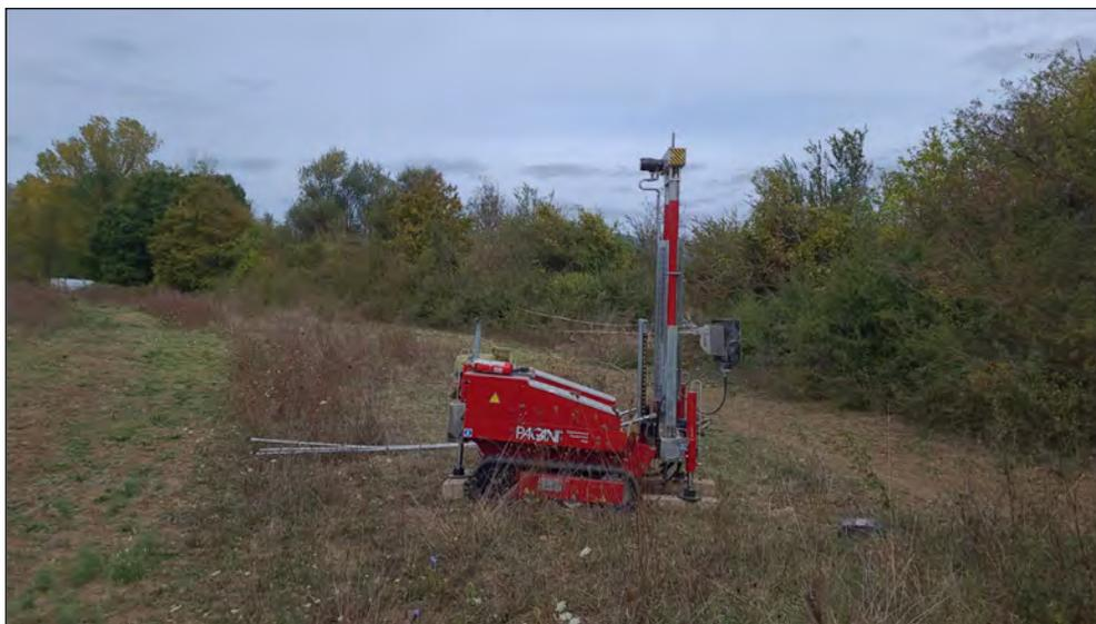
Strumentazione utilizzata per le prove penetrometriche dinamiche DPSH
