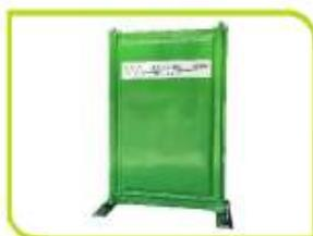
Il pannello Acustiko® autoportante integra al suo interno una struttura metallica che gli conferisce rigidità. Due tubi fuoriescono dalla parte inferiore del pannello per poter essere inseriti nel piede metallico tassellabile (accessorio) oppure nei blocchi di cemento per recinzioni da cantiere (materiale del commercio).
