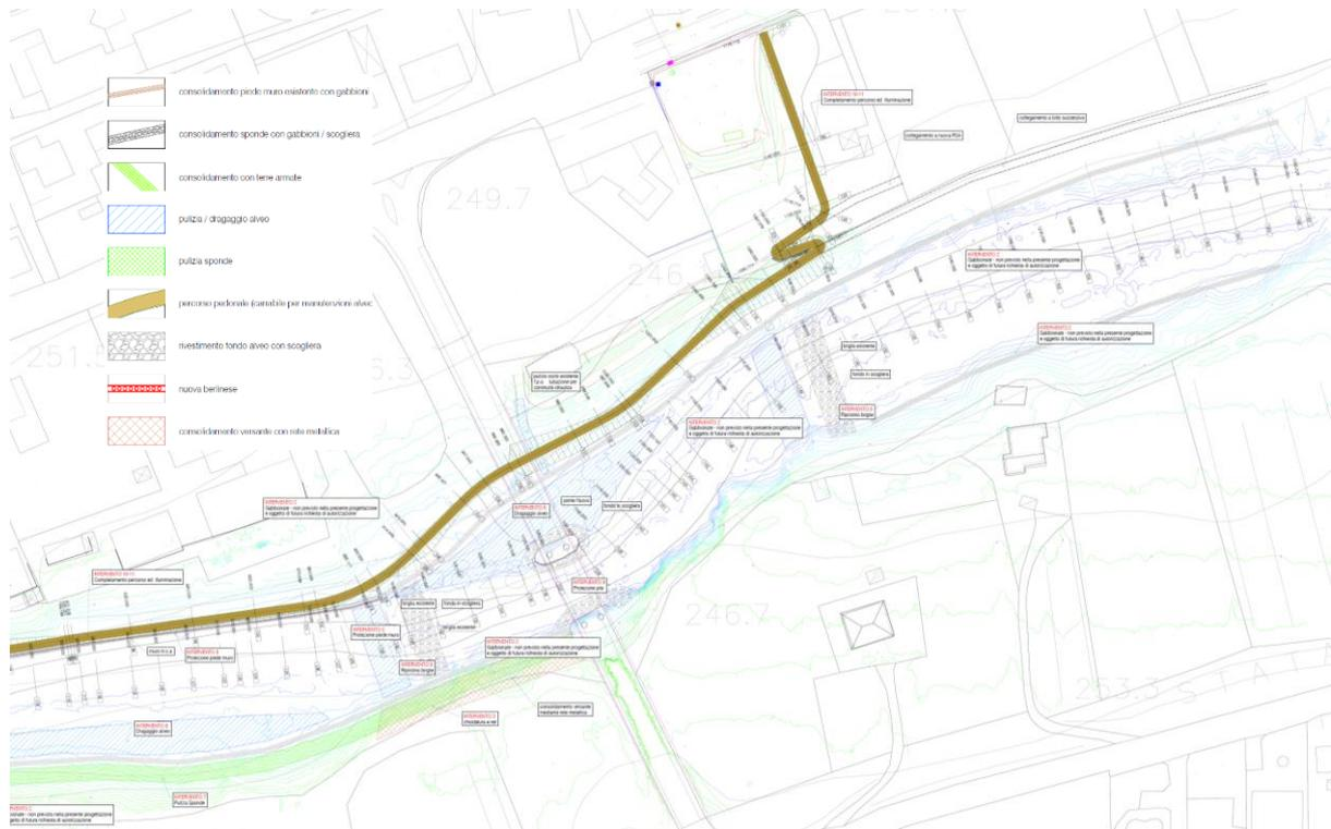
All'interno dello stesso Studio è riportata (vedi di seguito), anche planimetria di cantiere con le aree di accesso all'alveo. Tale documento, come dichiarato dal tecnico, tiene in considerazione le piste realizzate da ANAS per i lavori di manutenzione del ponte lungo la SS che hanno sensibilmente modificato l'ambiente oggetto della progettazione.
