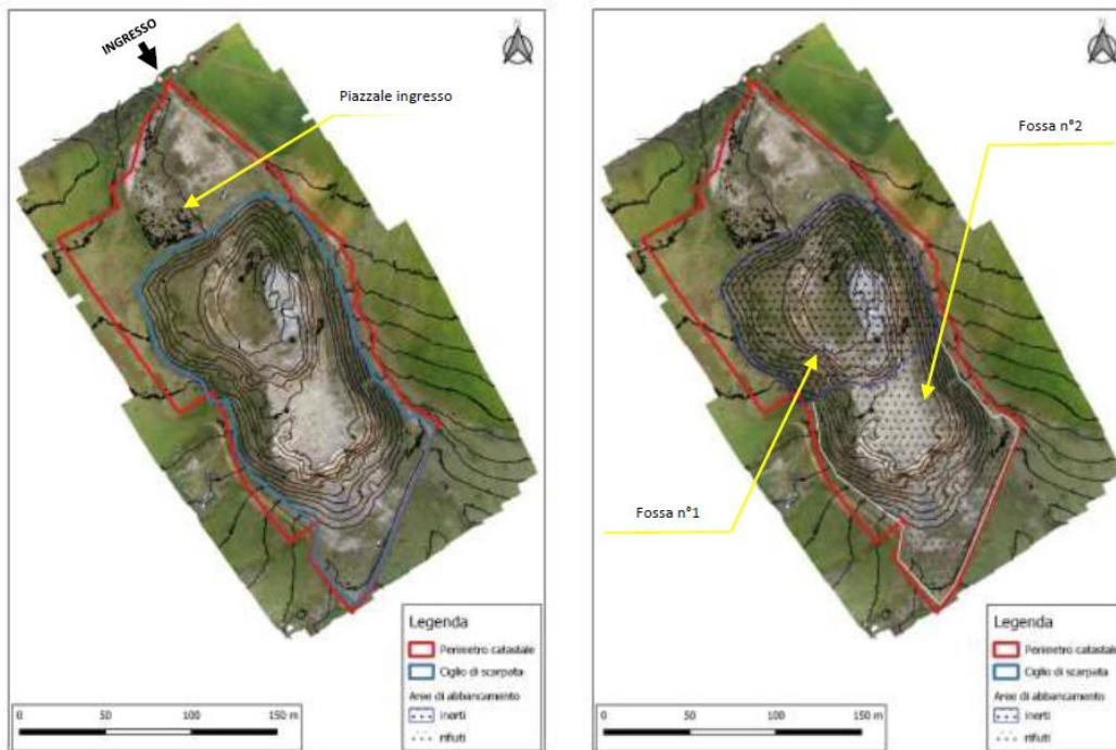
Figura 7 -Andamento del profilo di cava e aree di abbancamento individuate da progetto.
