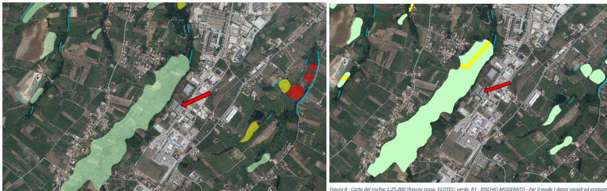
Figura 7 - Carta della pericolosità 1:10.000 (freccia rossa, Area ECOTEC; giallo, P2 - Pericolosità elevata - Aree interessate da Dissesti con alta possibilità di riattivazione; rosso, P3 - Pericolosità molto elevata - Aree interessate da Dissesti in attività o riattivati stagionalmente; azzurro, P scarpa - Pericolosità da scarpe - Aree interessate da Dissesti tipo scarpe)
