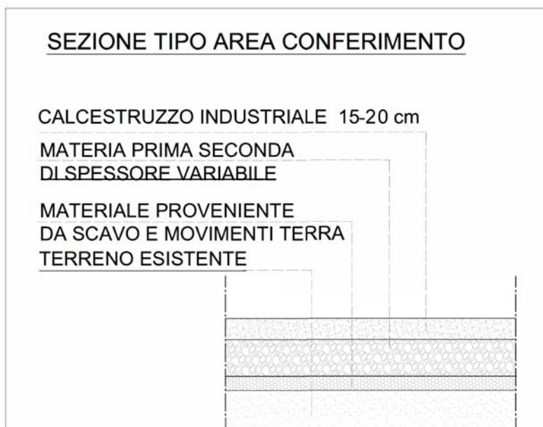
Figura 2.18. Particolare Sezione Pavimentazione in cls
