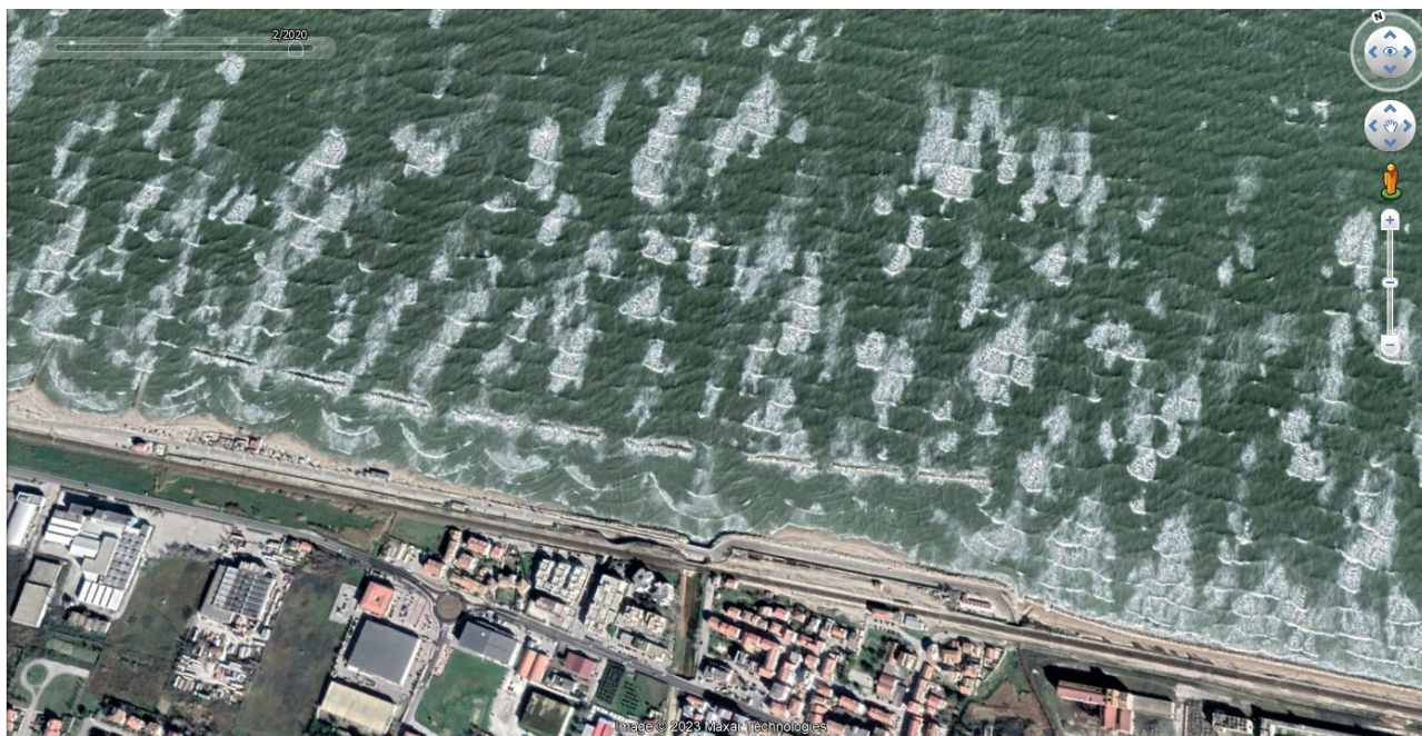
Fig. 2 Diffrazione ed overtopping in presenza di scogliere emerse durante una mareggiata
