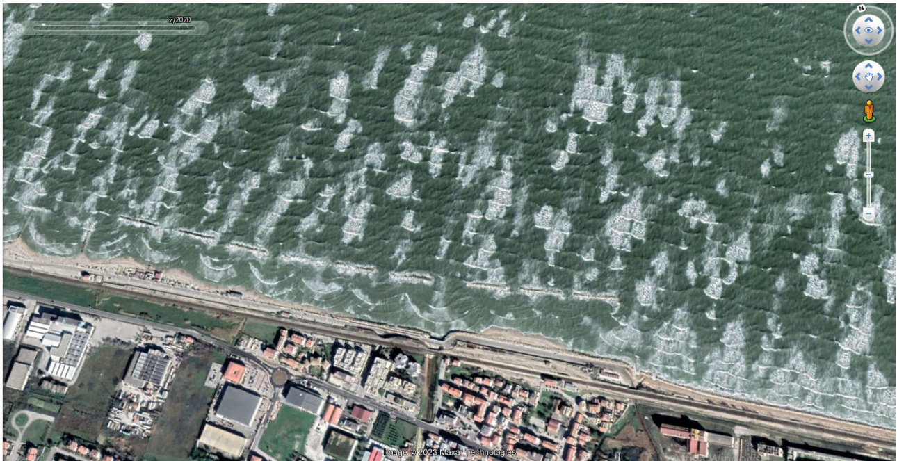
Fig. 5.2.1-1 Diffrazione ed overtopping in presenza di scogliere emerse durante una mareggiata
