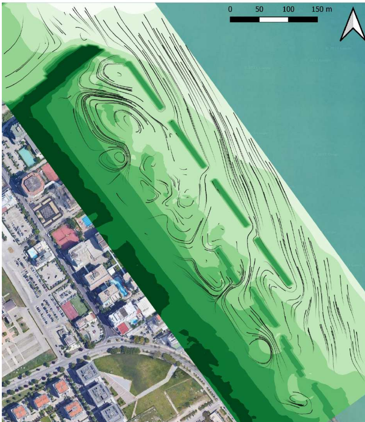
Figura 9-24: scenario di simulazione SC-2; linee di corrente desunte dal campo vettoriale (la scala dei colori rappresenta la quota del fondale).
