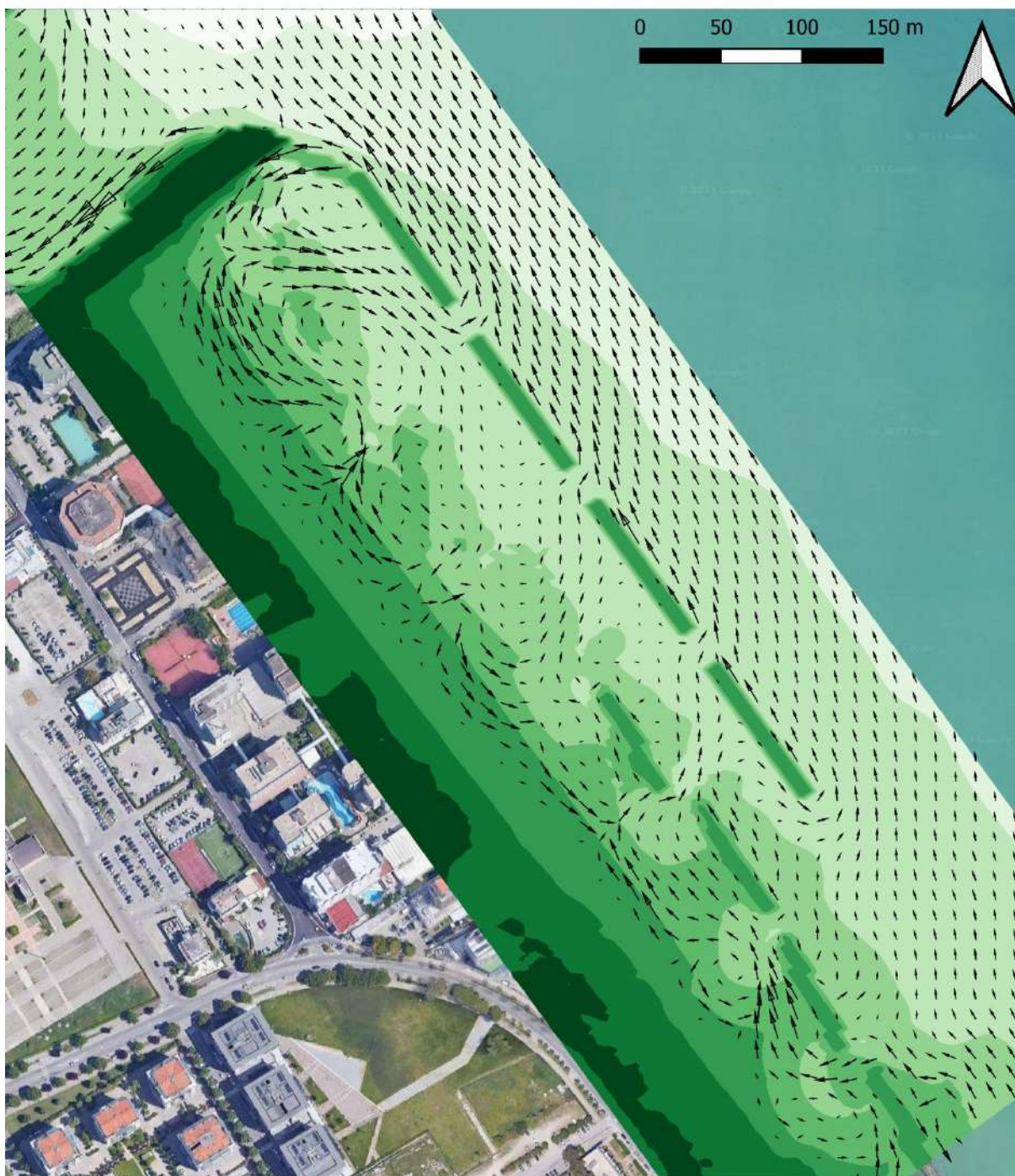
Figura 9-18: scenario di simulazione SC-2; campo vettoriale delle correnti (la scala dei colori rappresenta la quota del fondale).
