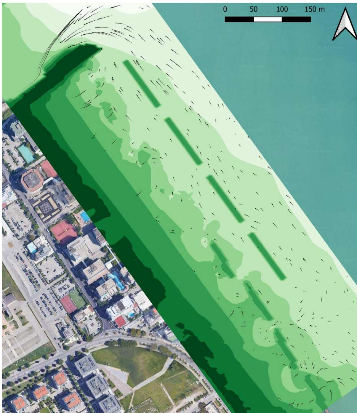
Figura 8-27: scenario di simulazione SC-5; linee di corrente desunte dal campo vettoriale (la scala dei colori rappresenta la quota del fondale).
