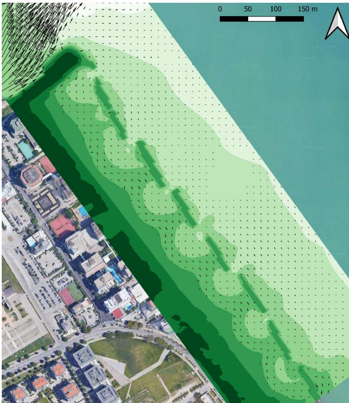
Figura 7-22: scenario di simulazione SC-6; campo vettoriale delle correnti (la scala dei colori rappresenta la quota del fondale).
