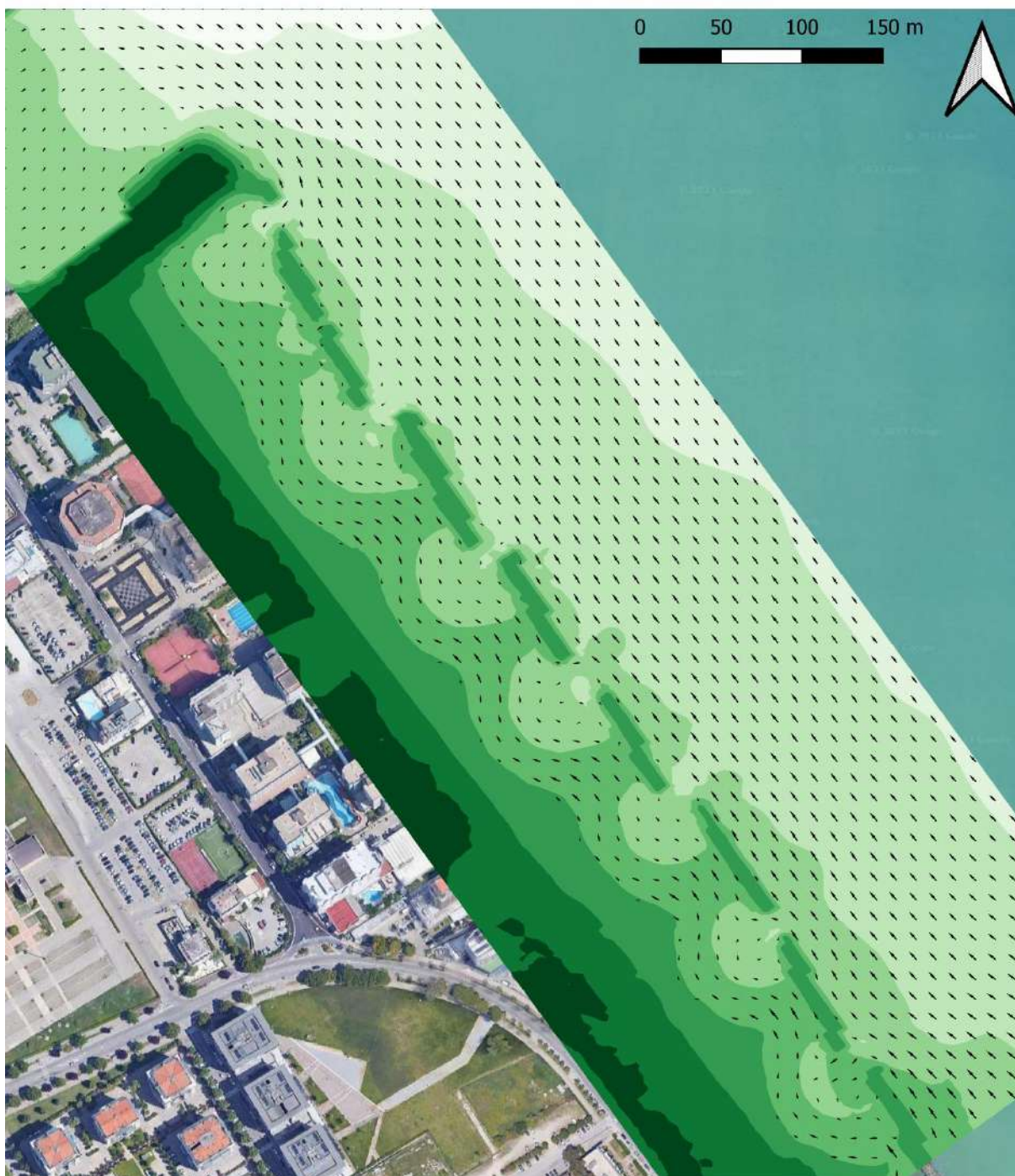
Figura 7-20: scenario di simulazione SC-4; campo vettoriale delle correnti (la scala dei colori rappresenta la quota del fondale).
