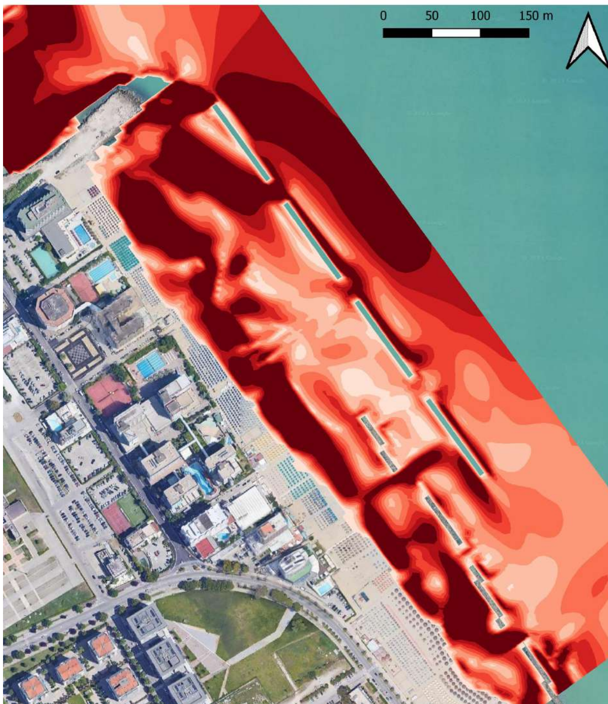
Figura 9-11: scenario di simulazione SC-1; distribuzione dell'intensità della corrente.
