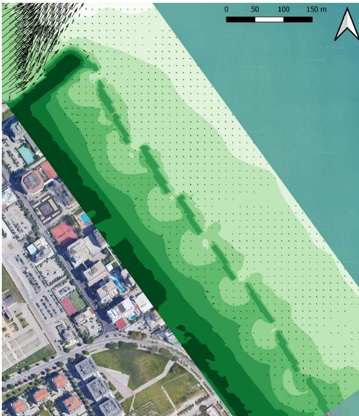
Figura 7-21: scenario di simulazione SC-5; campo vettoriale delle correnti (la scala dei colori rappresenta la quota del fondale).
