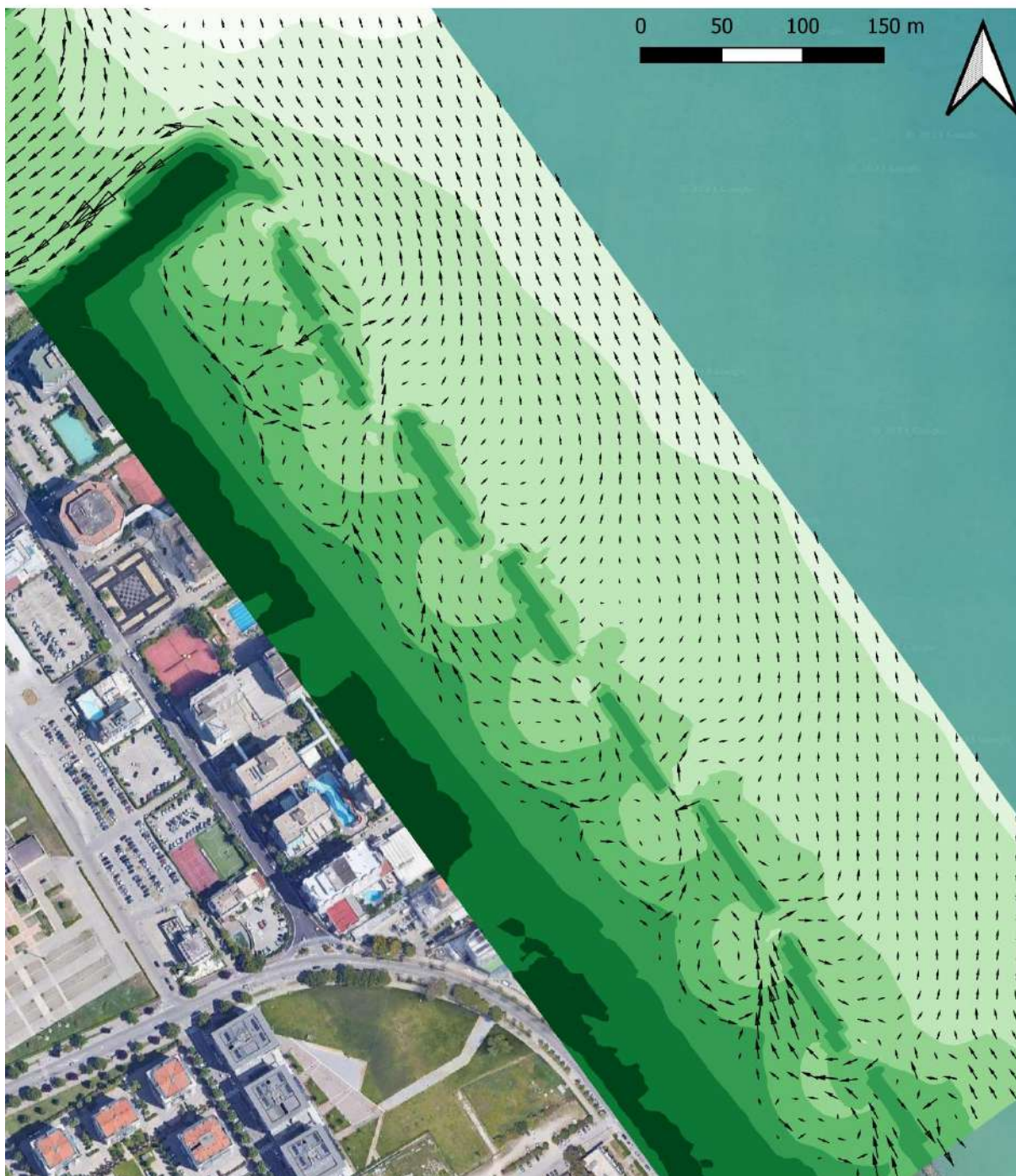
Figura 7-17: scenario di simulazione SC-1; campo vettoriale delle correnti (la scala dei colori rappresenta la quota del fondale).
