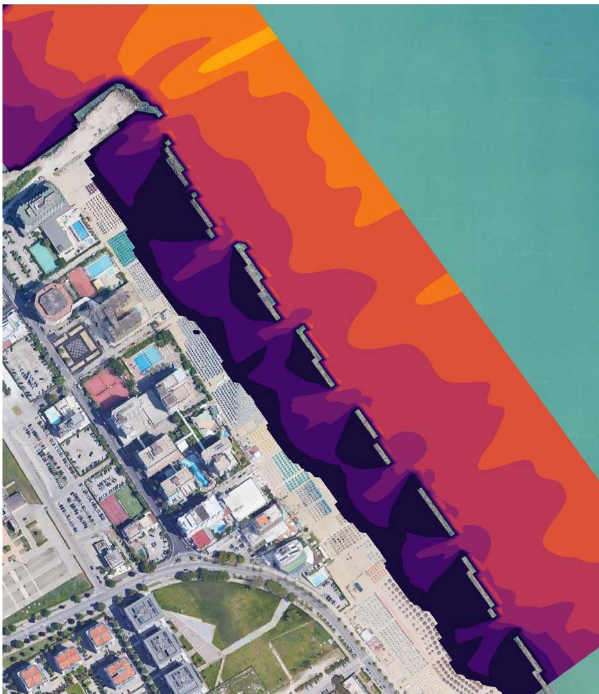
Figura 7-2: scenario di simulazione SC-2; distribuzione dell'altezza d'onda quadratica media nella porzione del dominio di calcolo ad alta risoluzione.
