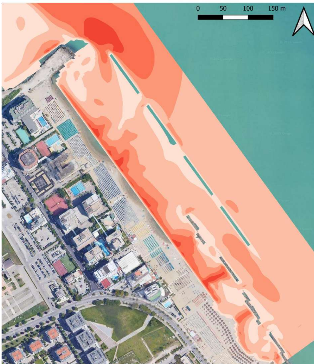
Figura 8-13: scenario di simulazione SC-3; distribuzione dell'intensità della corrente.
