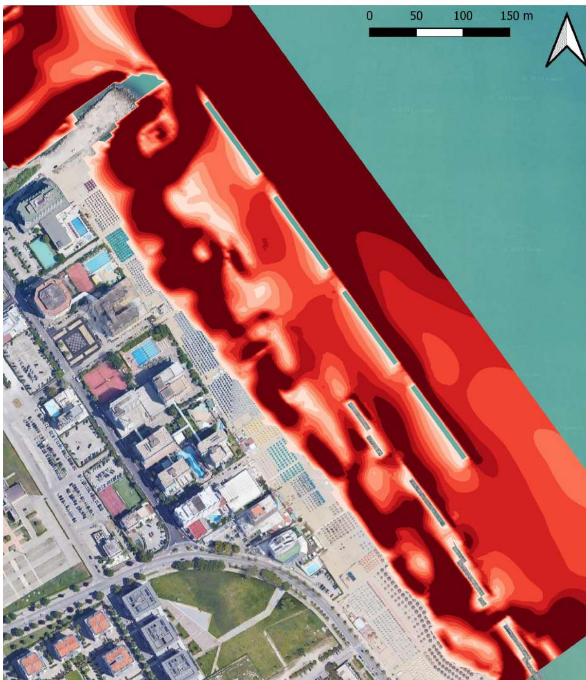
Figura 8-12: scenario di simulazione SC-2; distribuzione dell'intensità della corrente.
