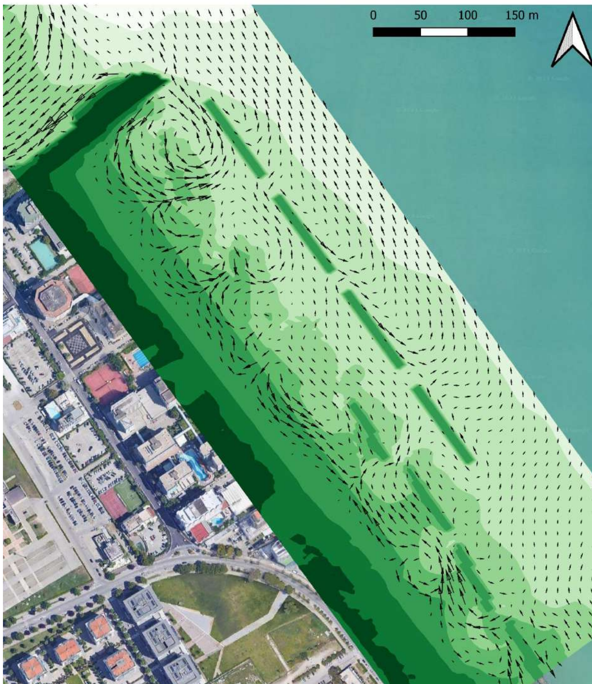
Figura 8-17: scenario di simulazione SC-1; campo vettoriale delle correnti (la scala dei colori rappresenta la quota del fondale).
