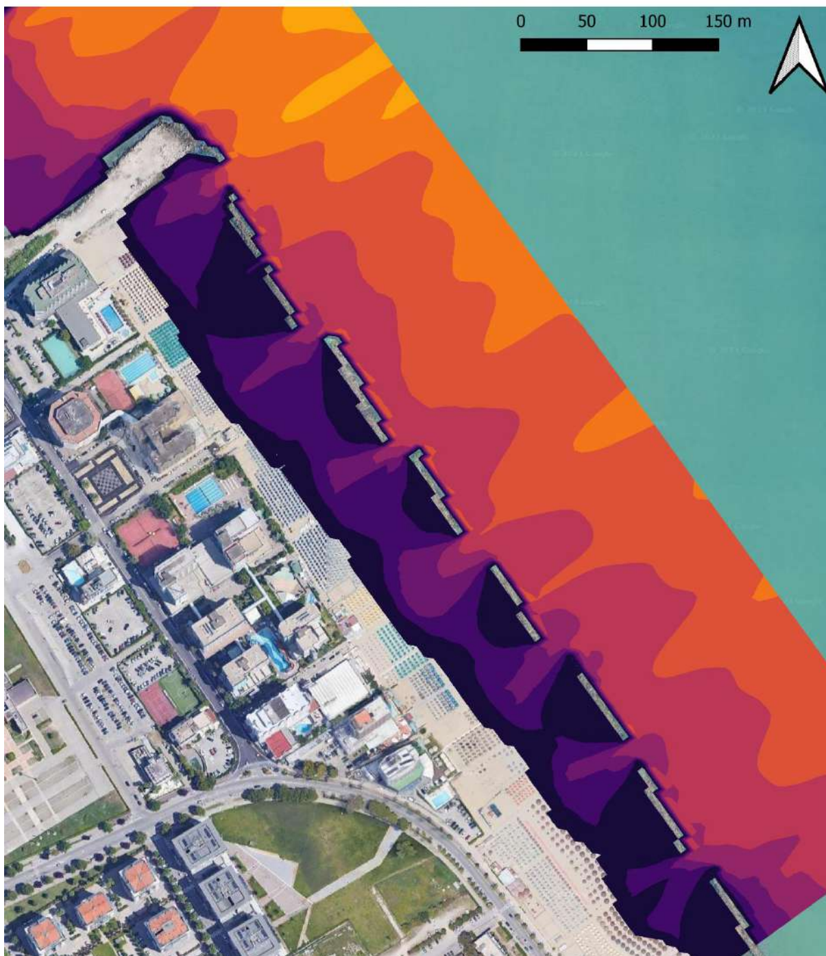
Figura 7-1: scenario di simulazione SC-1; distribuzione dell'altezza d'onda quadratica media nella porzione del dominio di calcolo ad alta risoluzione.
