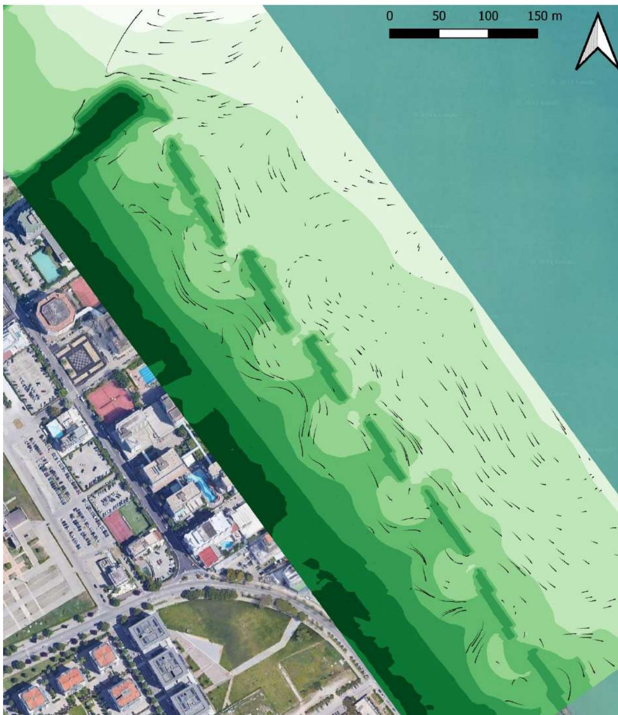
Figura 7-28: scenario di simulazione SC-6; linee di corrente desunte dal campo vettoriale (la scala dei colori rappresenta la quota del fondale).
