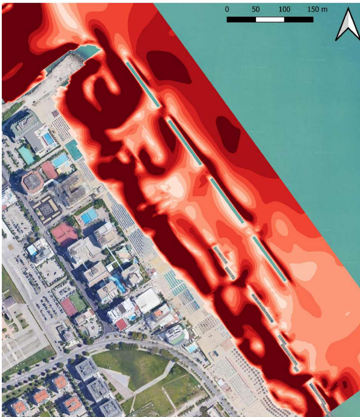
Figura 8-11: scenario di simulazione SC-1; distribuzione dell'intensità della corrente.
