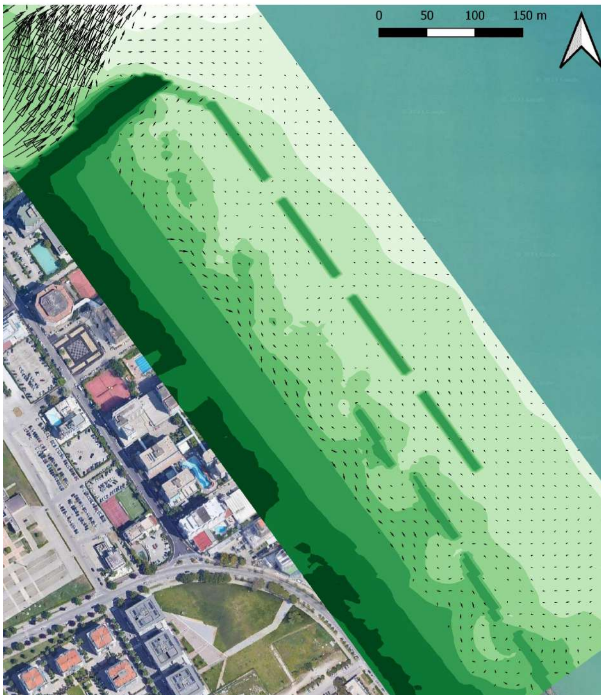
Figura 9-22: scenario di simulazione SC-6; campo vettoriale delle correnti (la scala dei colori rappresenta la quota del fondale).
