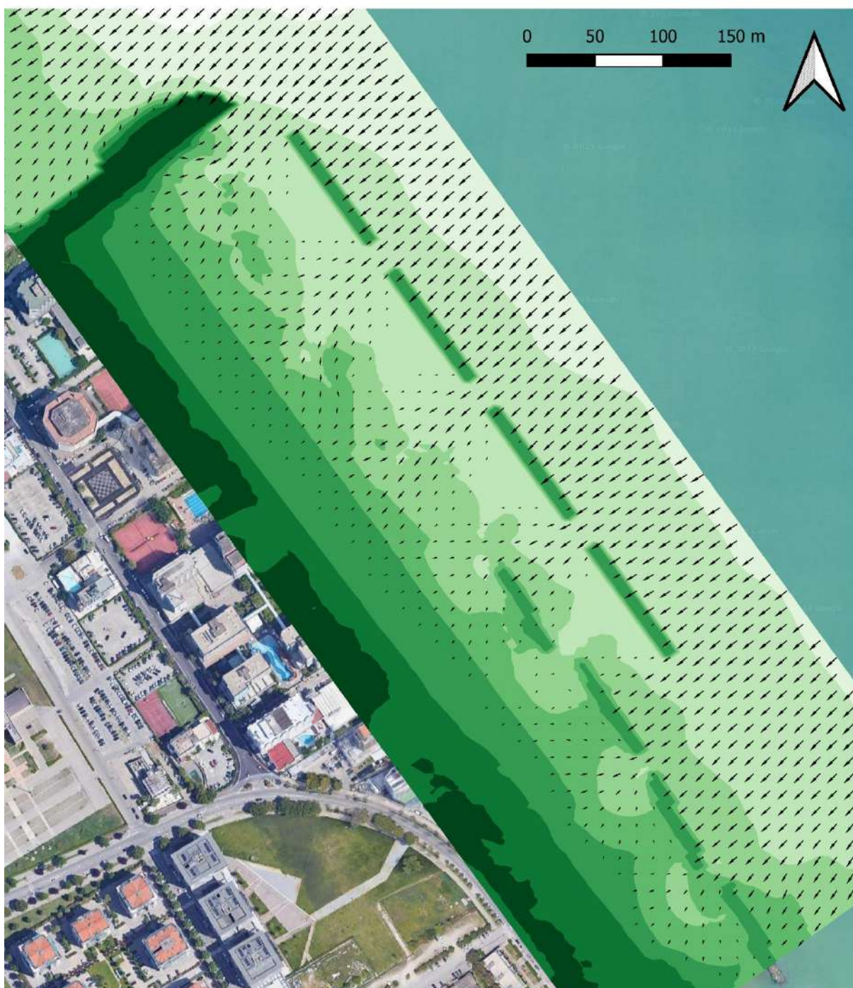
Figura 8-3: scenario di simulazione SC-1; distribuzione direzione media di propagazione del moto ondoso nella porzione del dominio di calcolo ad alta risoluzione. (la scala dei colori rappresenta la quota del fondale).
