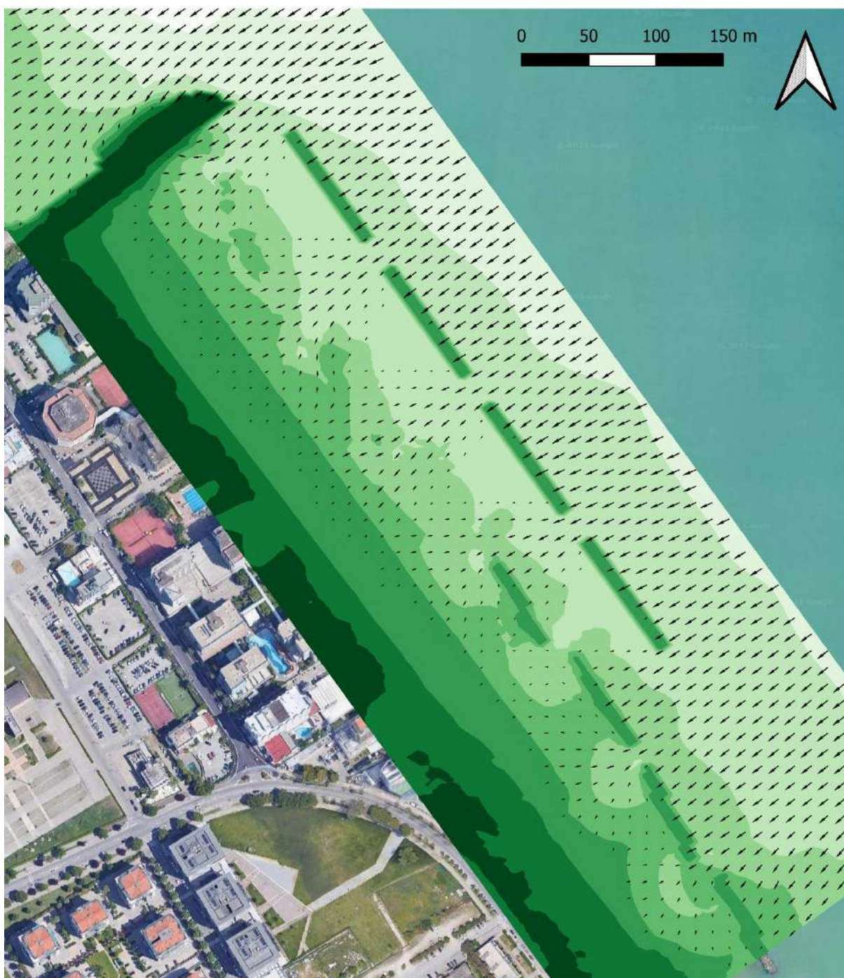
Figura 8-4: scenario di simulazione SC-2; distribuzione direzione media di propagazione del moto ondoso nella porzione del dominio di calcolo ad alta risoluzione. (la scala dei colori rappresenta la quota del fondale).
