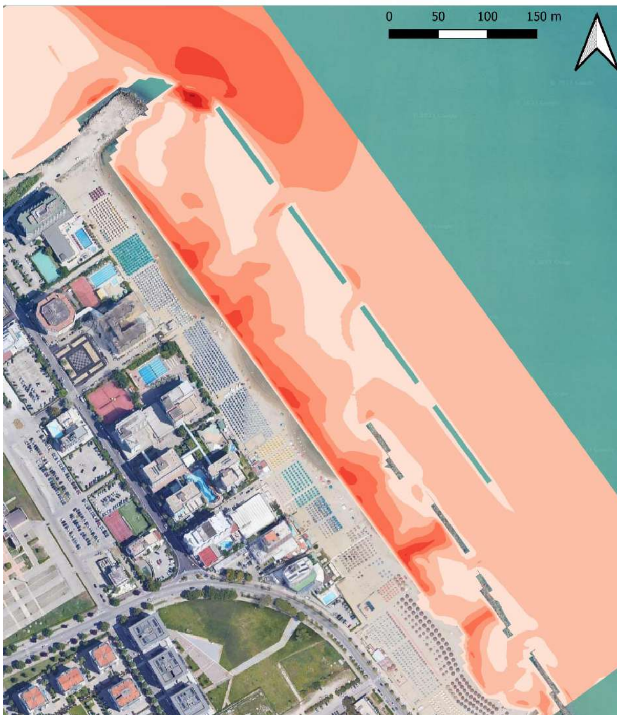
Figura 9-13: scenario di simulazione SC-3; distribuzione dell'intensità della corrente.
