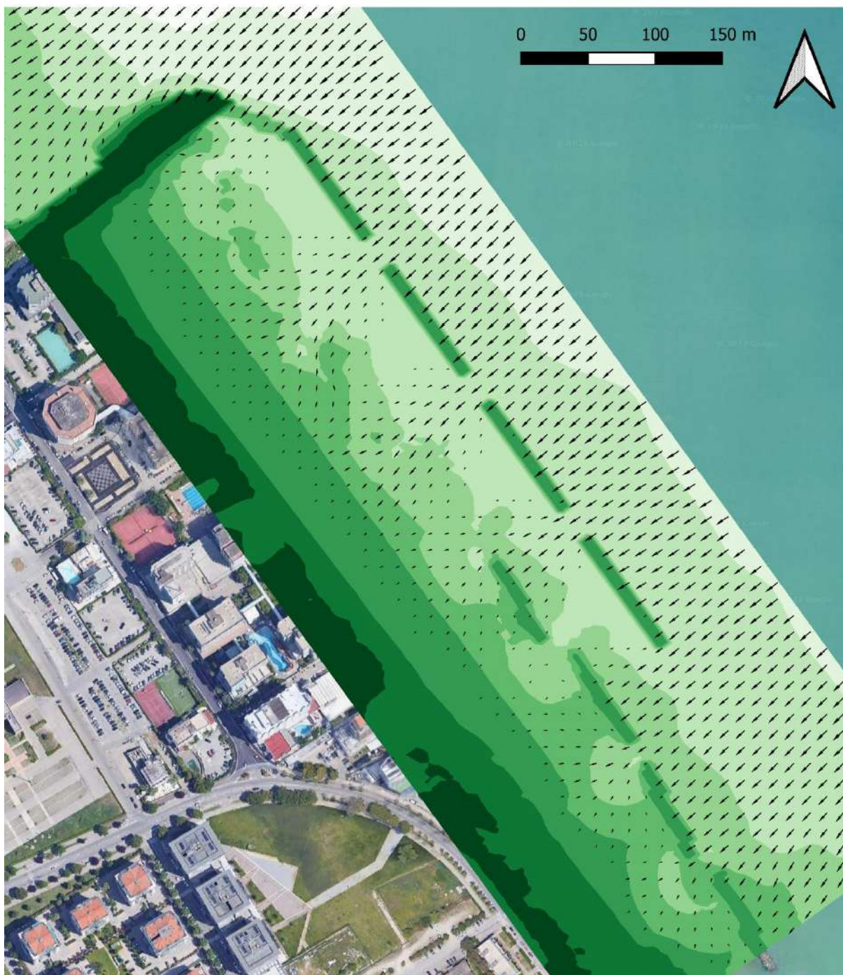
Figura 9-3: scenario di simulazione SC-1; distribuzione direzione media di propagazione del moto ondoso nella porzione del dominio di calcolo ad alta risoluzione. (la scala dei colori rappresenta la quota del fondale).
