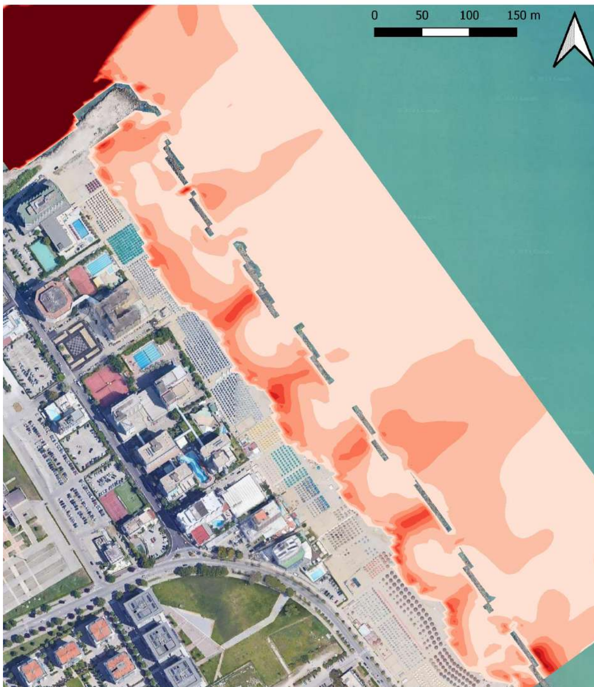
Figura 7-16: scenario di simulazione SC-6; distribuzione dell'intensità della corrente.
