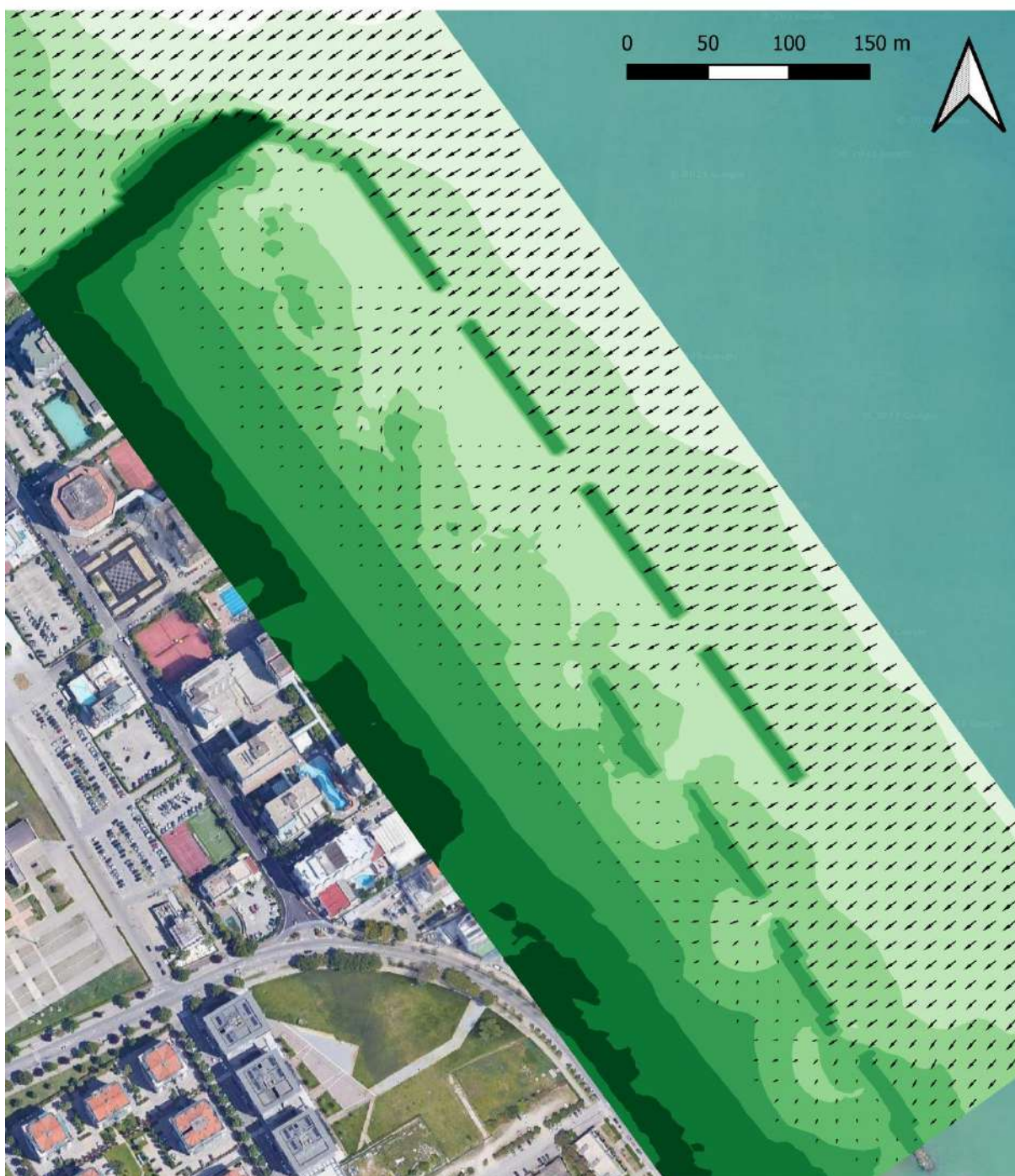
Figura 9-4: scenario di simulazione SC-2; distribuzione direzione media di propagazione del moto ondoso nella porzione del dominio di calcolo ad alta risoluzione. (la scala dei colori rappresenta la quota del fondale).
