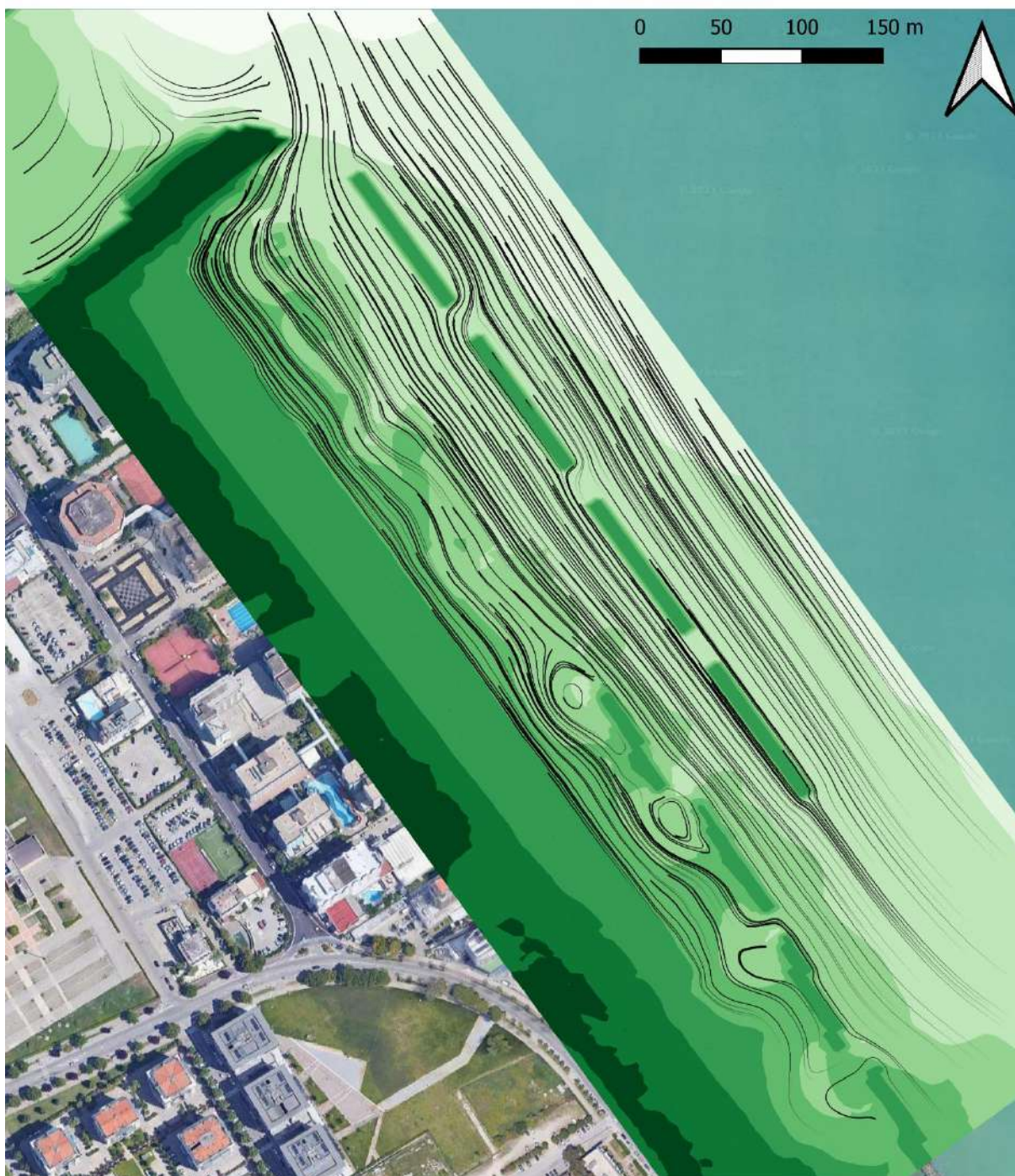
Figura 8-26: scenario di simulazione SC-4; linee di corrente desunte dal campo vettoriale (la scala dei colori rappresenta la quota del fondale).
