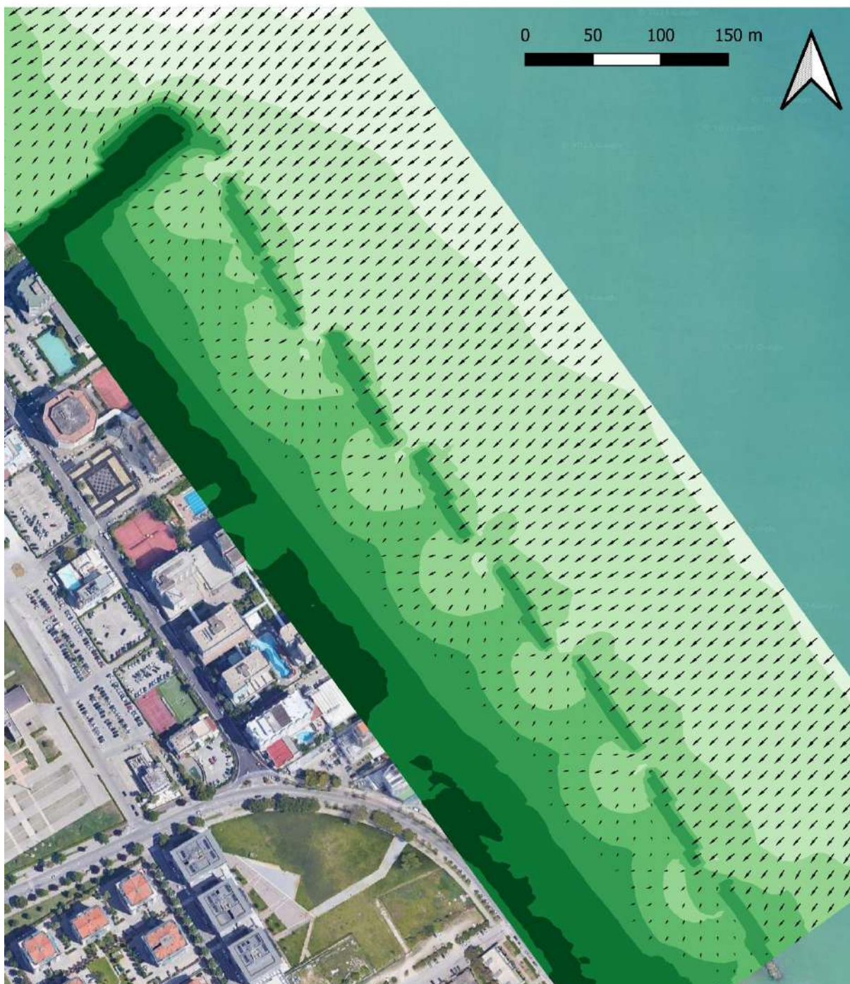
Figura 7-3: scenario di simulazione SC-1; distribuzione direzione media di propagazione del moto ondoso nella porzione del dominio di calcolo ad alta risoluzione. (la scala dei colori rappresenta la quota del fondale).
