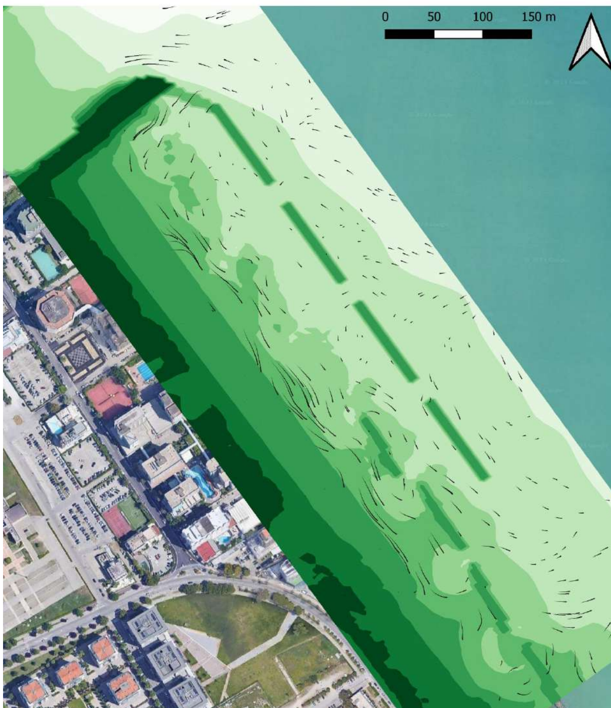
Figura 9-28: scenario di simulazione SC-6; linee di corrente desunte dal campo vettoriale (la scala dei colori rappresenta la quota del fondale).
