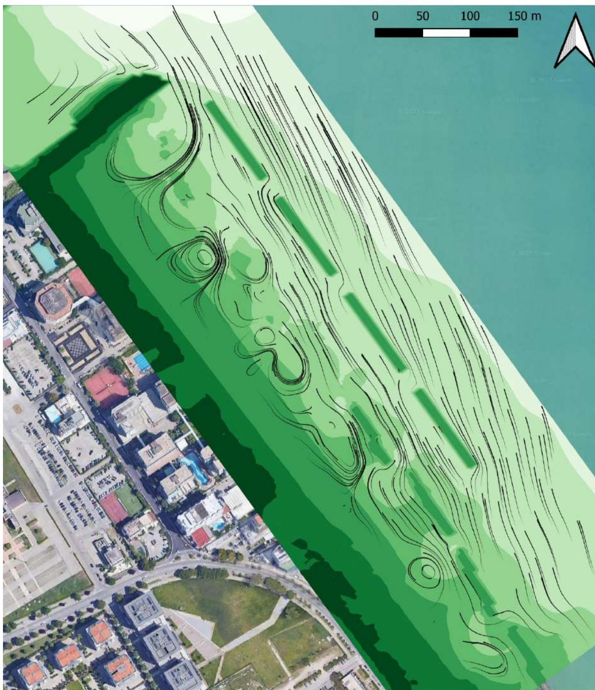
Figura 8-24: scenario di simulazione SC-2; linee di corrente desunte dal campo vettoriale (la scala dei colori rappresenta la quota del fondale).
