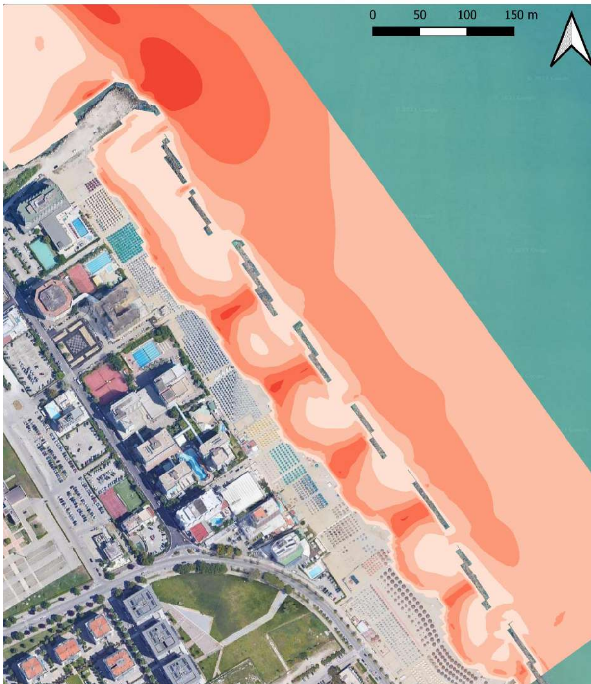
Figura 7-13: scenario di simulazione SC-3; distribuzione dell'intensità della corrente.
