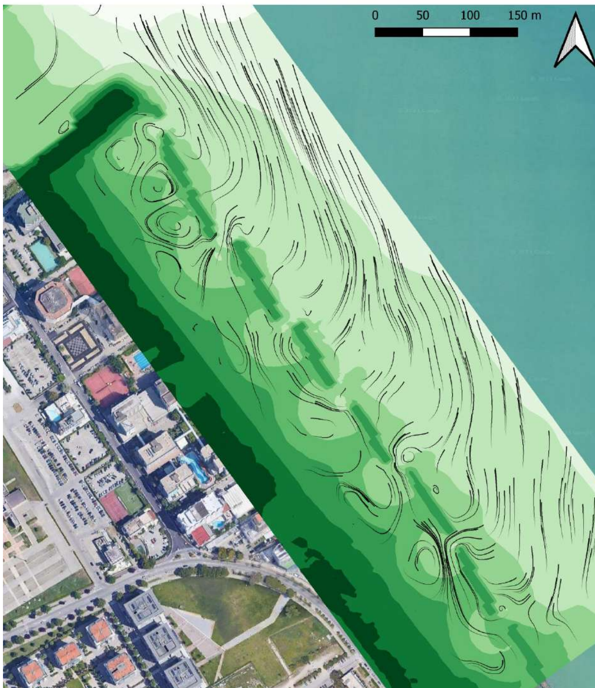
Figura 7-23: scenario di simulazione SC-1; linee di corrente desunte dal campo vettoriale (la scala dei colori rappresenta la quota del fondale).
