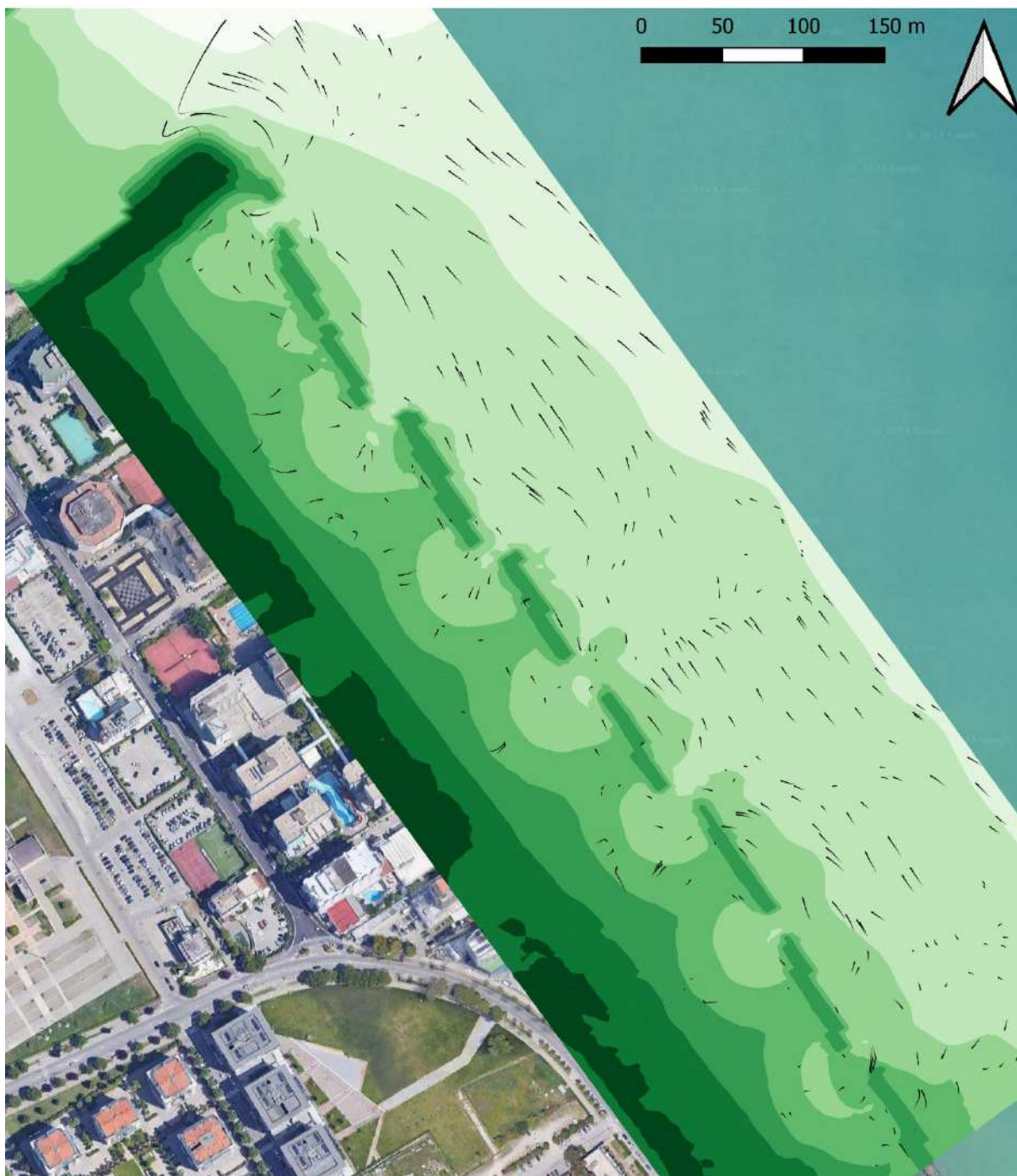
Figura 7-27: scenario di simulazione SC-5; linee di corrente desunte dal campo vettoriale (la scala dei colori rappresenta la quota del fondale).
