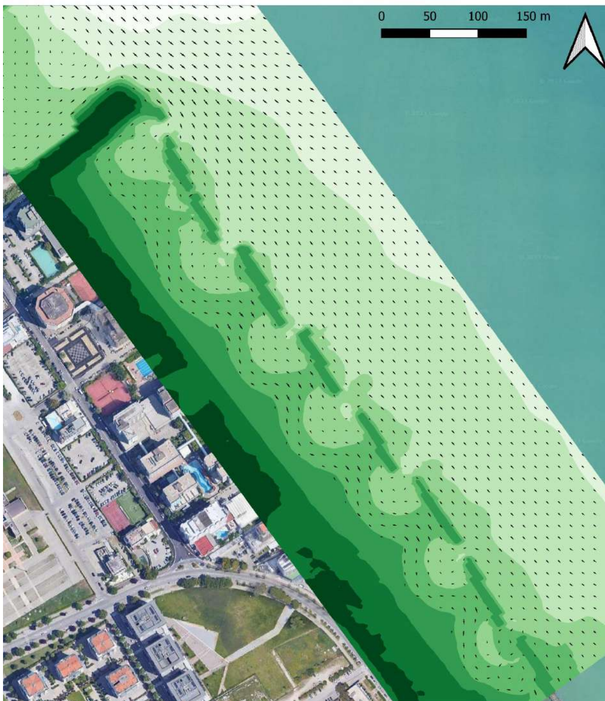
Figura 7-19: scenario di simulazione SC-3; campo vettoriale delle correnti (la scala dei colori rappresenta la quota del fondale).
