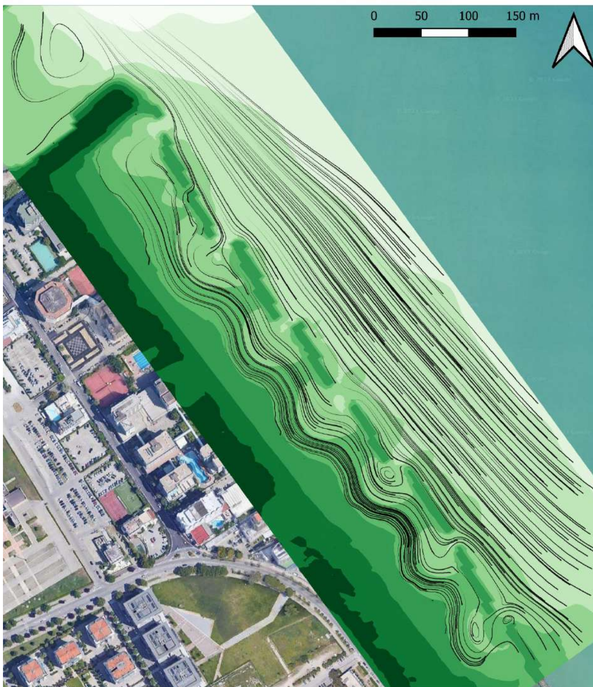
Figura 7-25: scenario di simulazione SC-3; linee di corrente desunte dal campo vettoriale (la scala dei colori rappresenta la quota del fondale).
