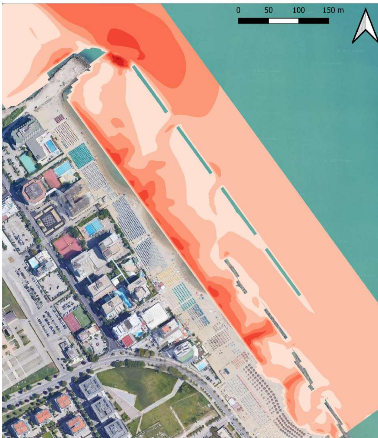
Figura 9-12: scenario di simulazione SC-2; distribuzione dell'intensità della corrente.
