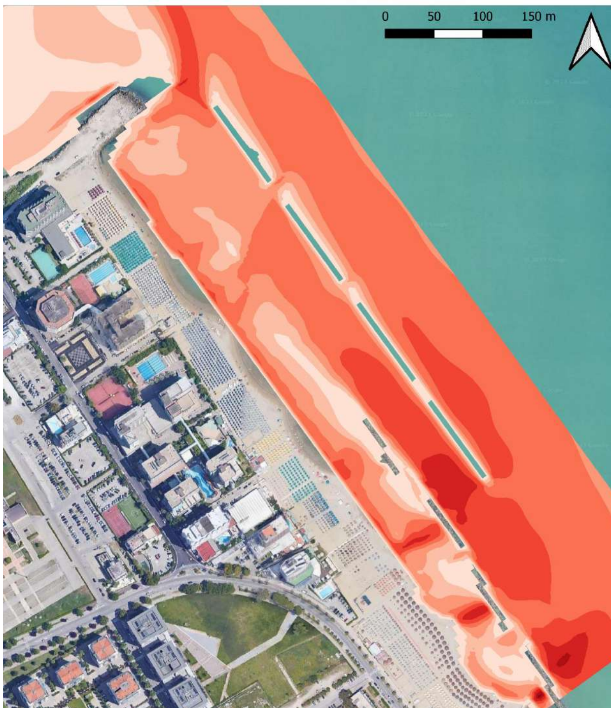
Figura 8-14: scenario di simulazione SC-4; distribuzione dell'intensità della corrente.
