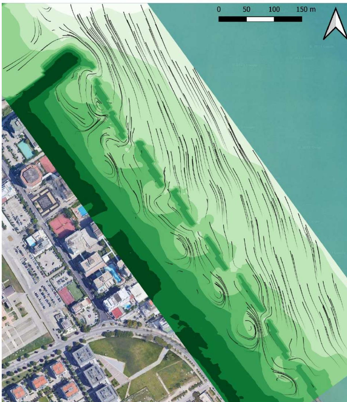
Figura 7-24: scenario di simulazione SC-2; linee di corrente desunte dal campo vettoriale (la scala dei colori rappresenta la quota del fondale).
