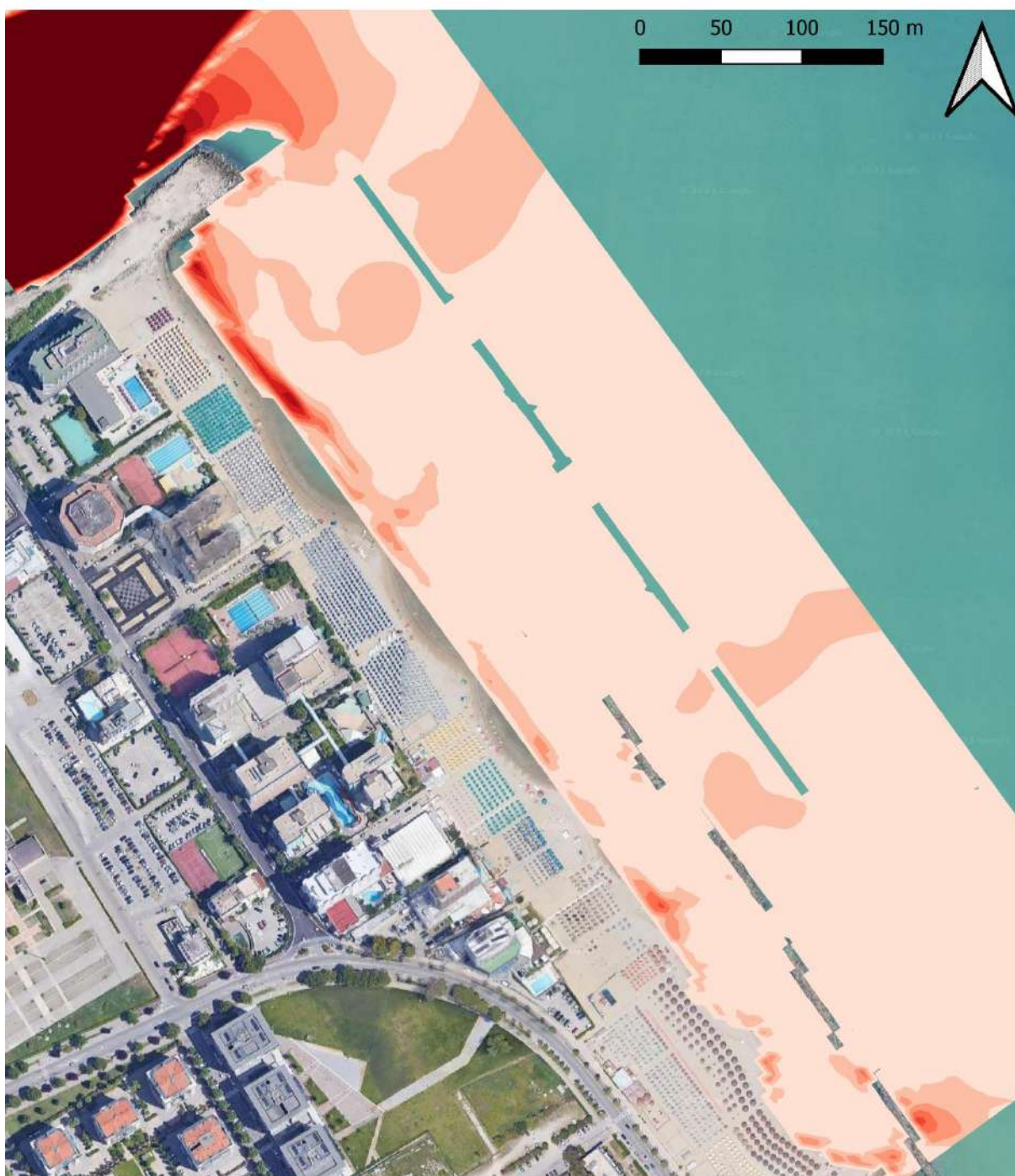
Figura 9-15: scenario di simulazione SC-5; distribuzione dell'intensità della corrente.
