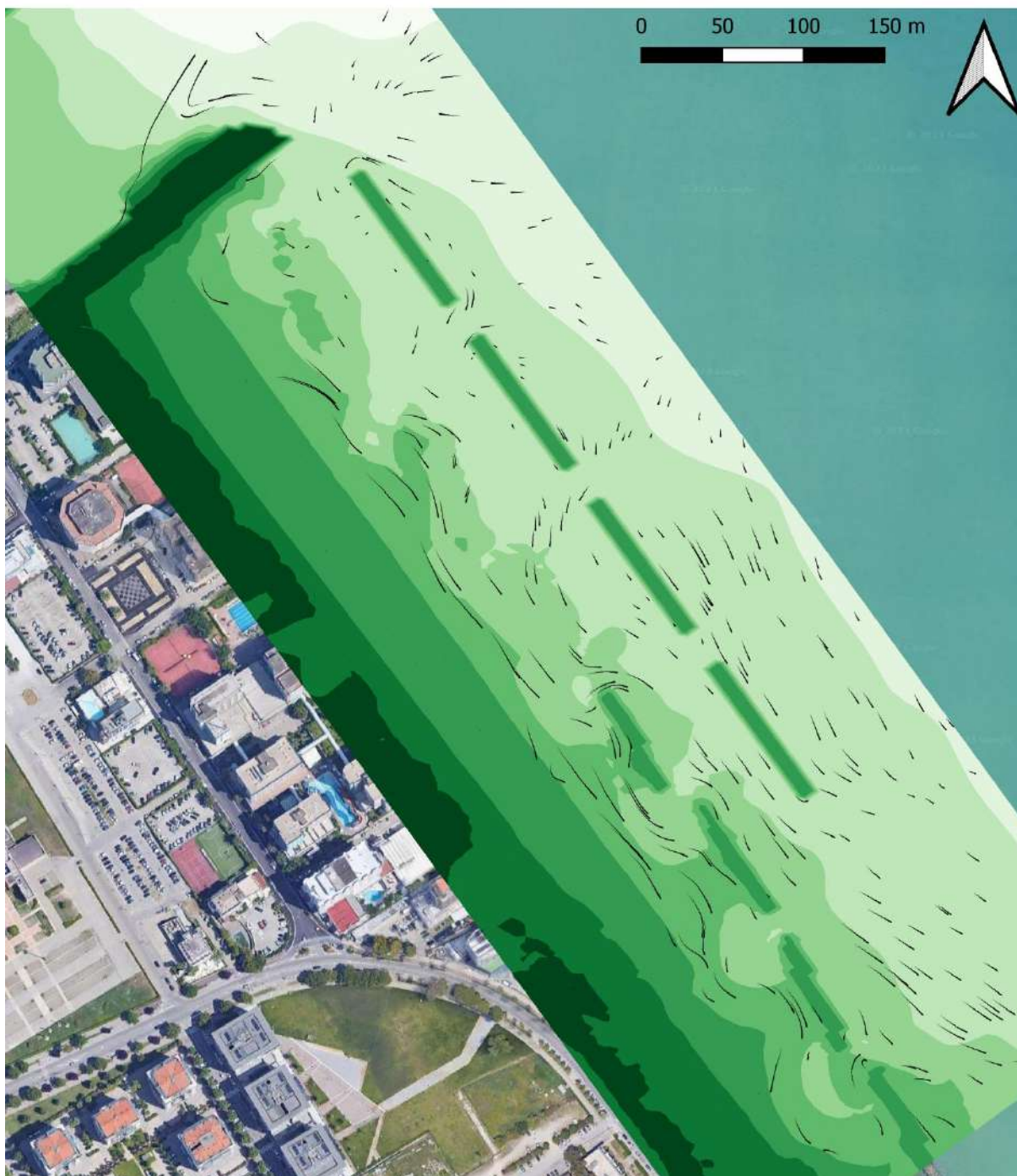
Figura 8-28: scenario di simulazione SC-6; linee di corrente desunte dal campo vettoriale (la scala dei colori rappresenta la quota del fondale).
