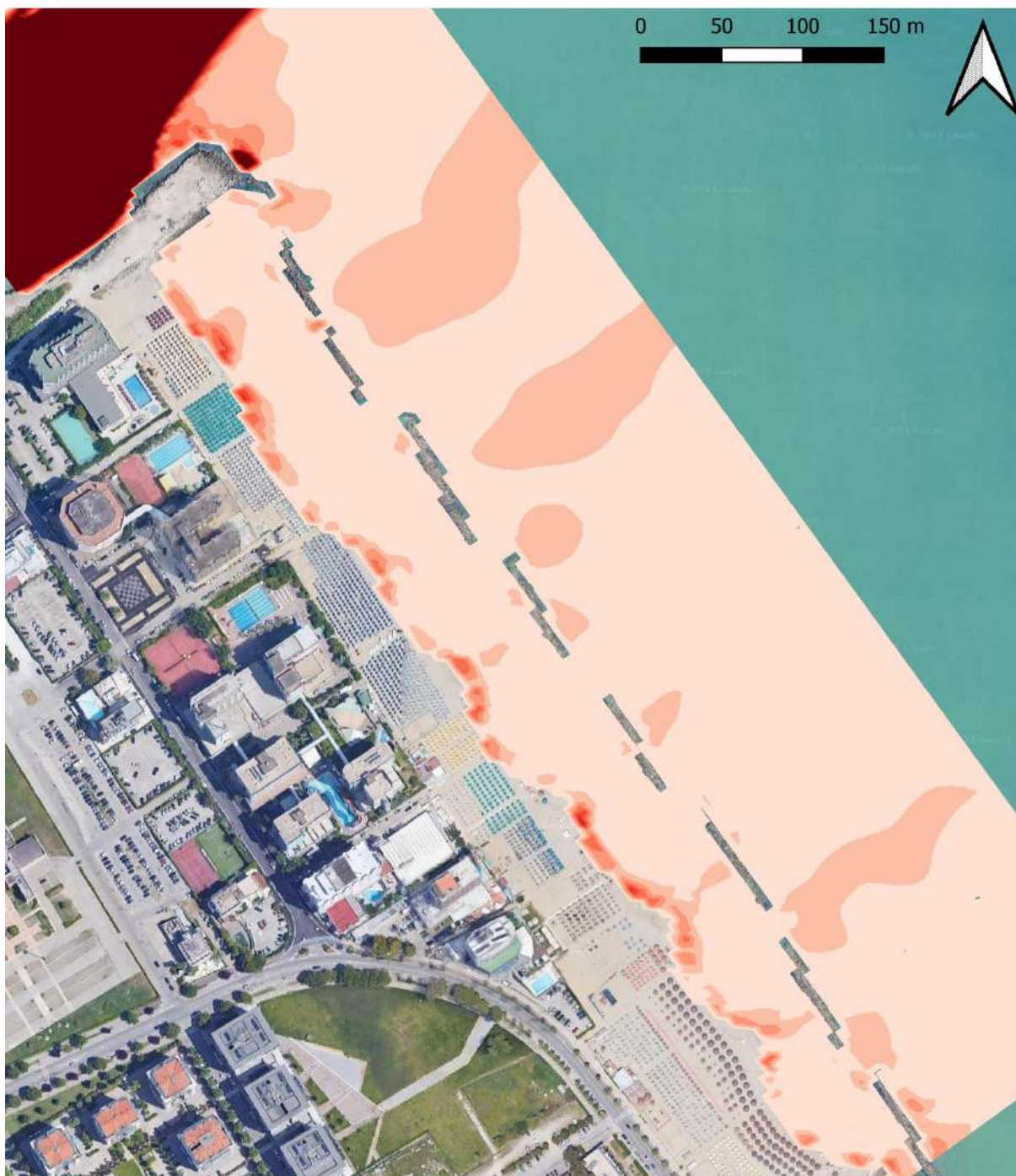
Figura 7-15: scenario di simulazione SC-5; distribuzione dell'intensità della corrente.
