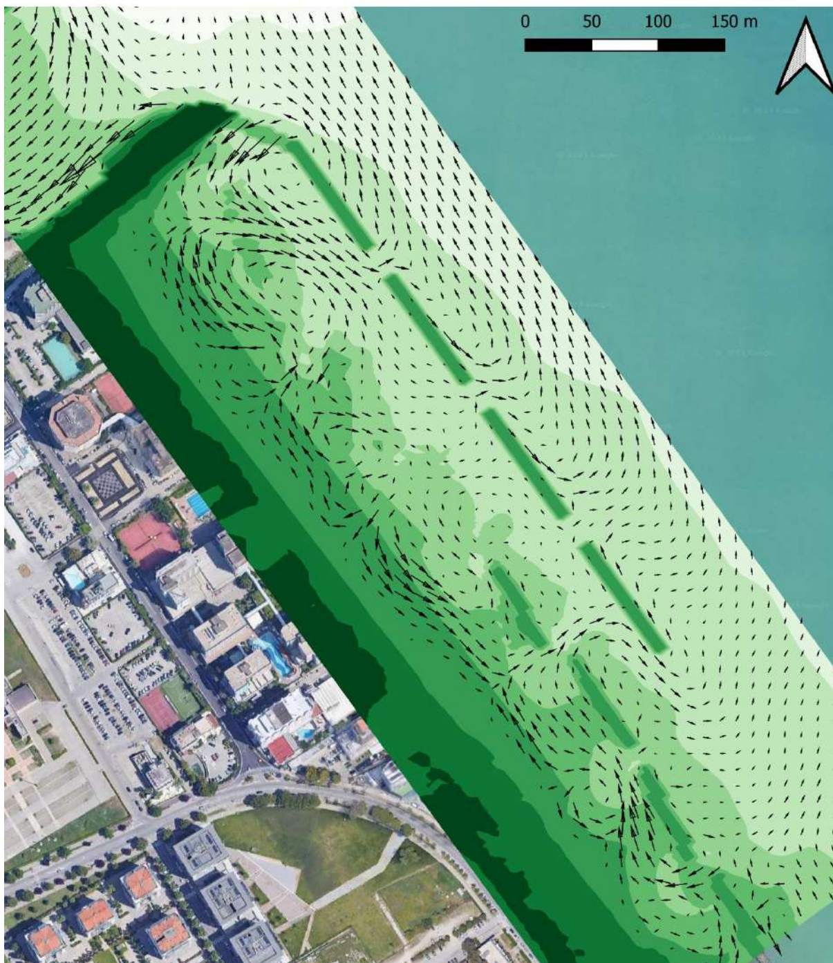
Figura 9-17: scenario di simulazione SC-1; campo vettoriale delle correnti (la scala dei colori rappresenta la quota del fondale).
