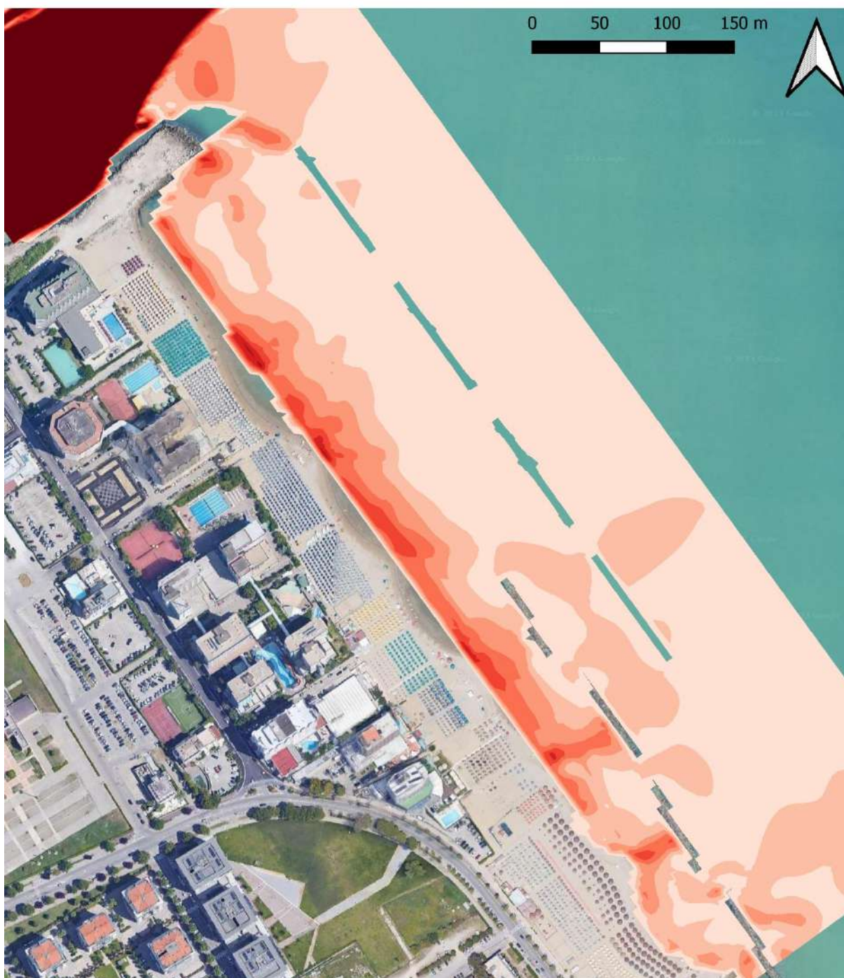
Figura 9-16: scenario di simulazione SC-6; distribuzione dell'intensità della corrente.
