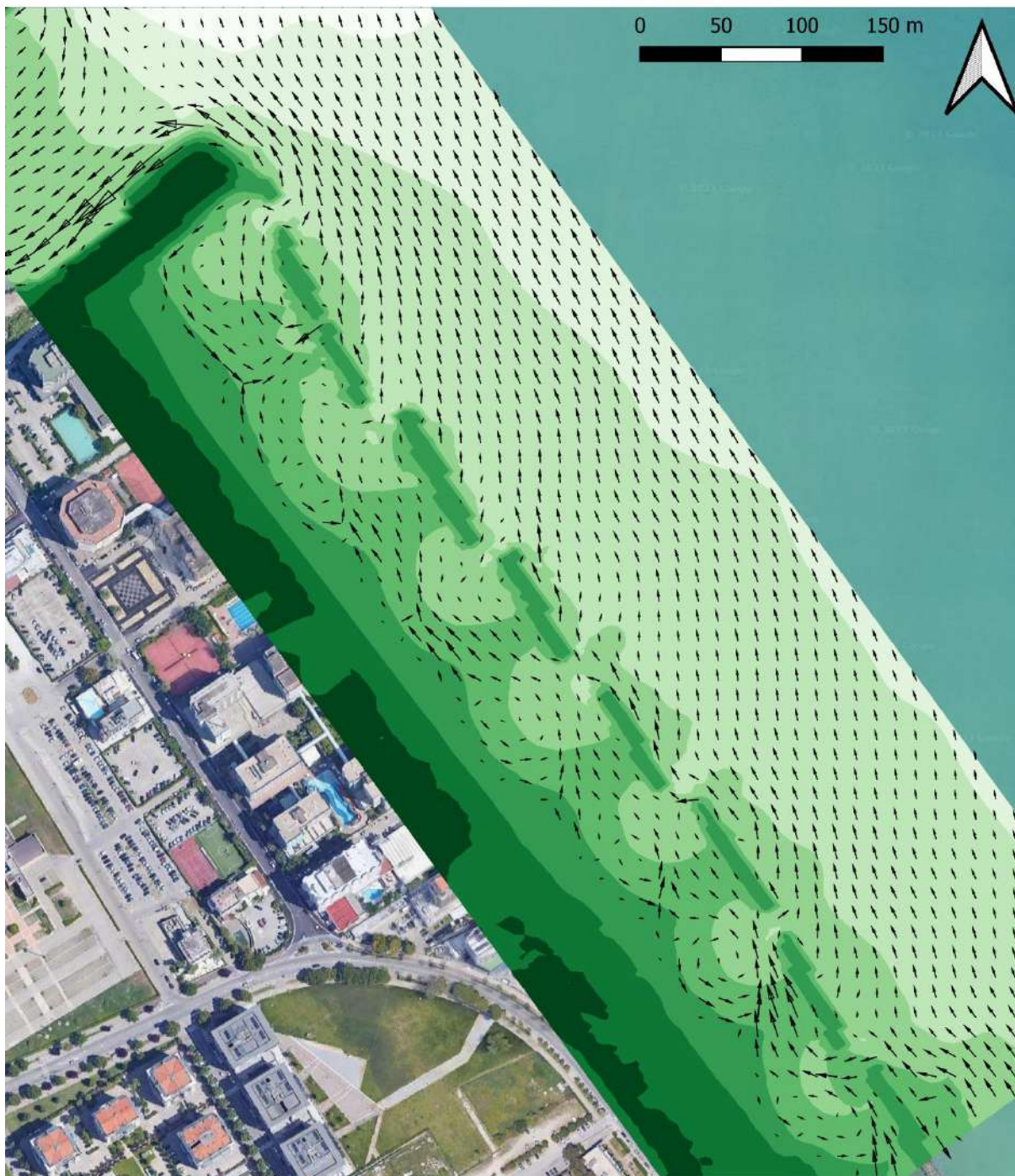
Figura 7-18: scenario di simulazione SC-2; campo vettoriale delle correnti (la scala dei colori rappresenta la quota del fondale).
