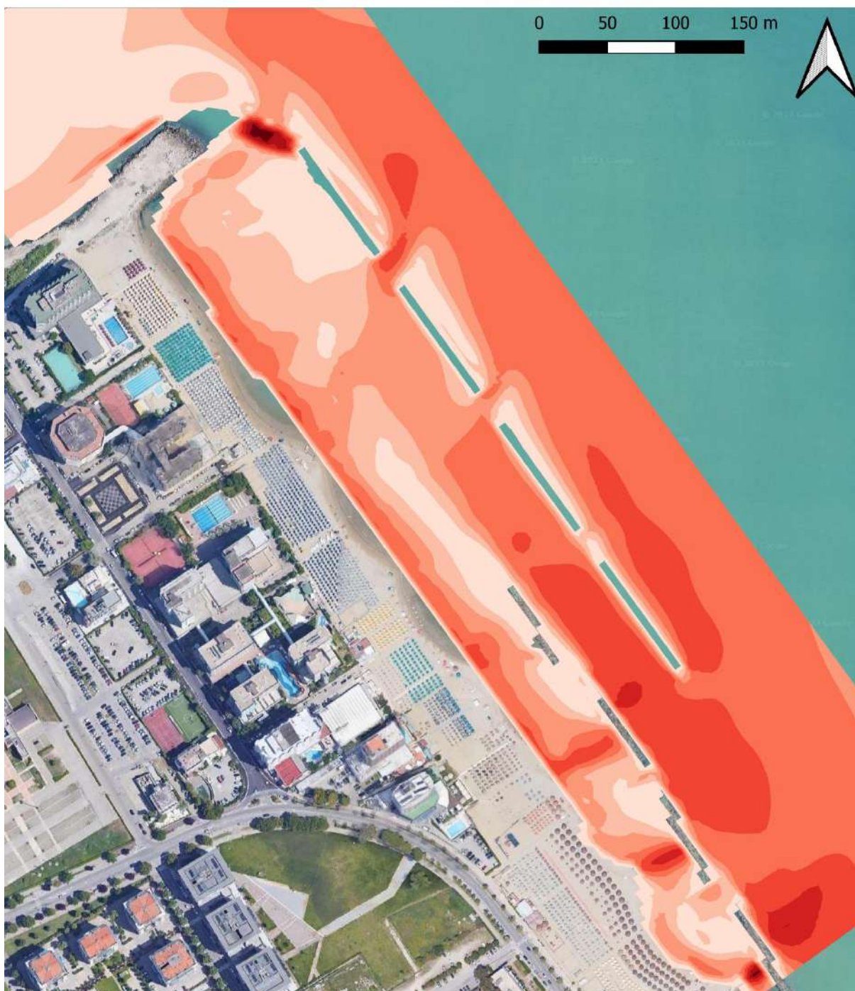
Figura 9-14: scenario di simulazione SC-4; distribuzione dell'intensità della corrente.
