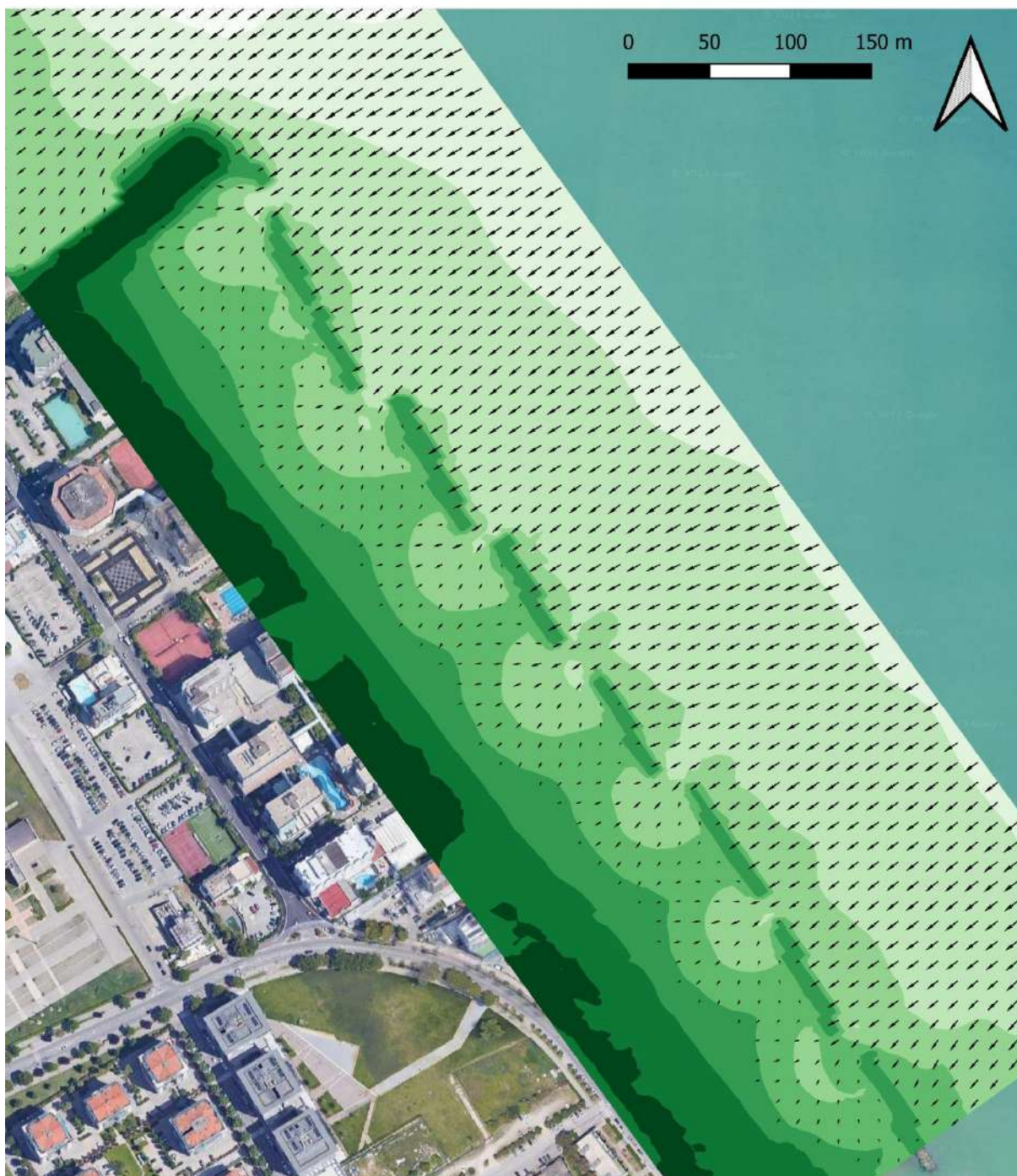
Figura 7-4: scenario di simulazione SC-2; distribuzione direzione media di propagazione del moto ondoso nella porzione del dominio di calcolo ad alta risoluzione. (la scala dei colori rappresenta la quota del fondale).
