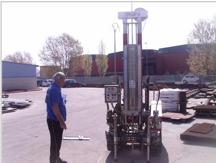
Foto Prova Penetrometrica dinamica DPSH1
