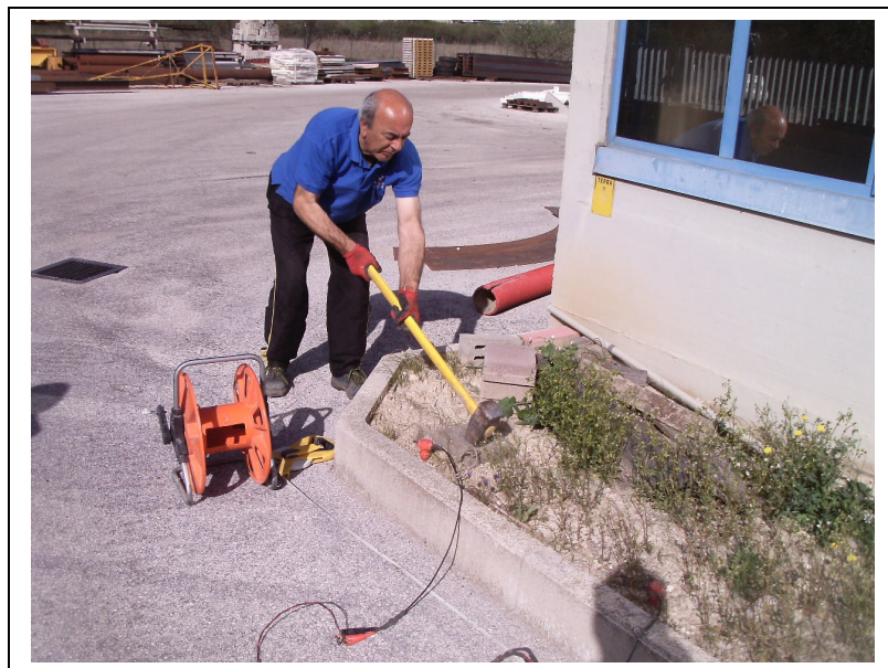
Foto 2: sistema di energizzazione: mazza da 8 kg; Trigger.
