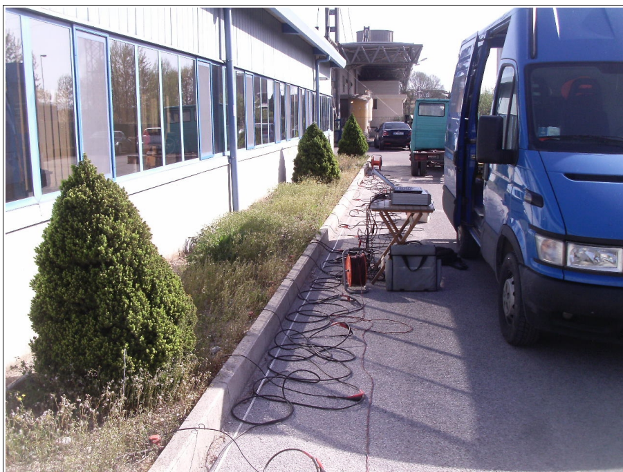
Foto Postazione della Prova Geofisica MASW – M1
