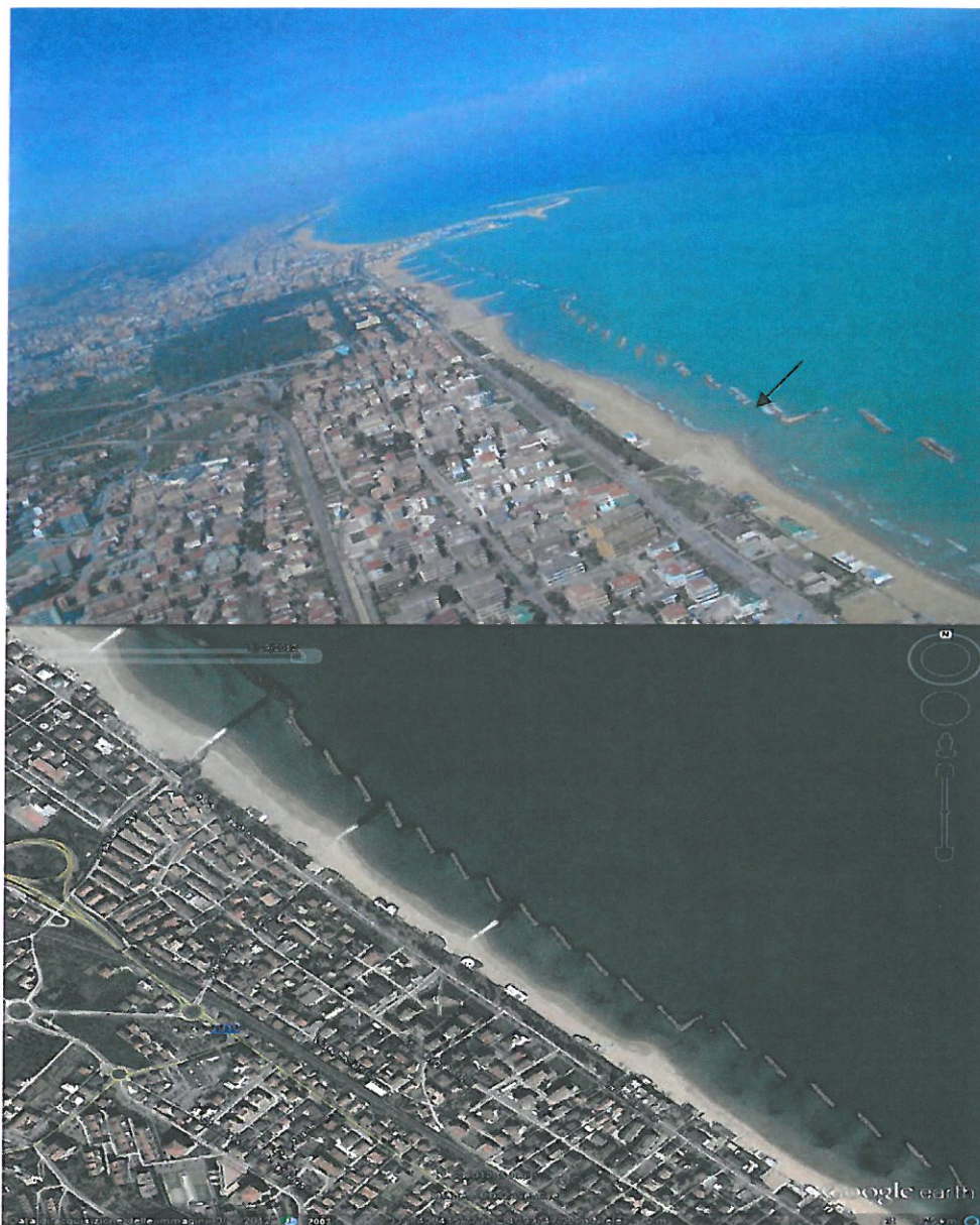
Fig2 e 3-Pescara Sud- Prima foto: Foto area dell'area in esame ( aprile 2007): si osserva la stabilizzazione della prima parte del litoraneo a sud del Porto Turistico fino al fosso Vallelunga. La parte a sud del f.sso Vallelunga prima della realizzazione dei due pennelli da parte dell'intervento del Comune di Pescara. Si intravede un leggero e progressivo arretramento della linea di costa nella parte antistante i primi due stabilimenti a sud del fosso Vallelunga. Foto google 2010 si può notare che l'area a ridosso del confine comunale tende ad essere sempre più marcatamente a dente di sega ,con l'accentuazione della rientranza sugli ultime due stabilimenti.
