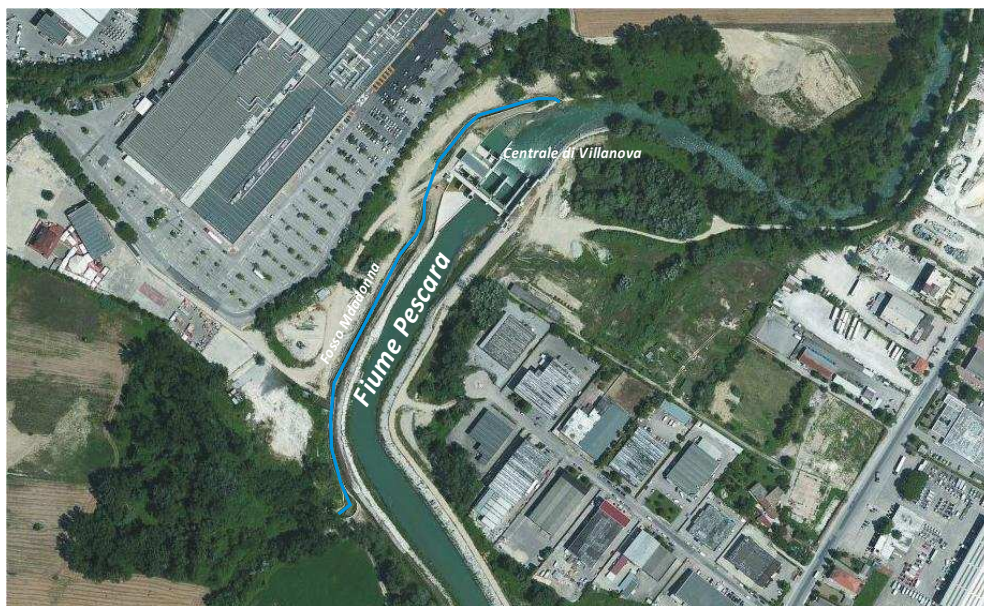
Figura 3.12 - Fosso Madonna presso la centrale di Villanova, in fase di realizzazione. In primo piano il fosso completamente cunettato in calcestruzzo.
