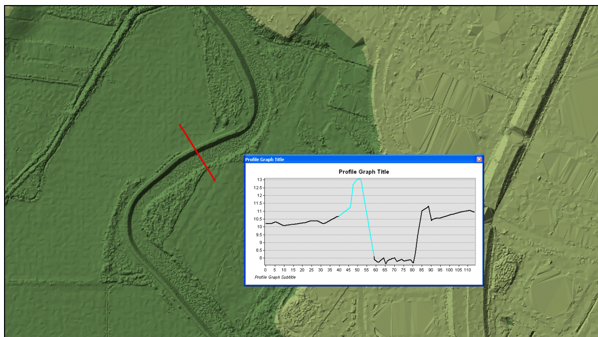
Figura 3.2 – Stralcio del rilievo disponibile presso l'area di studio. Si noti, in corrispondenza della sezione tracciata in planimetria (indicata in rosso), come il profilo della sezione evidenzi la presenza dell'arginatura di contenimento in sponda sinistra.
