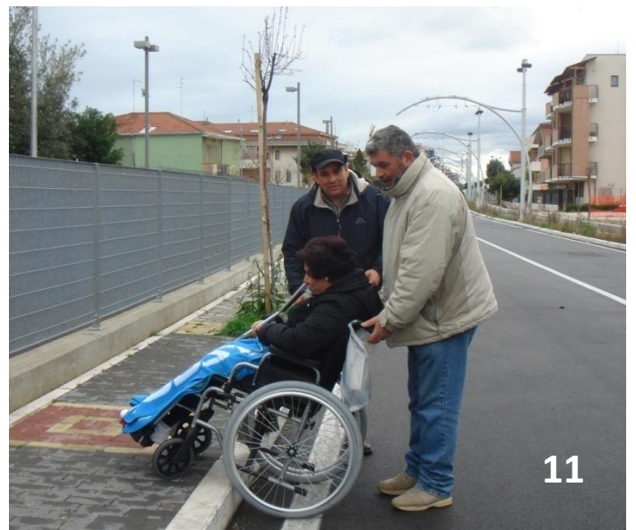
Foto 10 e 11. La persona sulla carrozzina è costretta a scendere dal marciapiede a causa dell'ingombro del palo che gli impedisce di proseguire il suo cammino, deve farsi aiutare da qualcuno perché non c'è traccia di scivolo per tutto il lungo tratto di Viale Europa.
