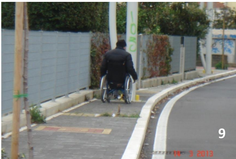
Foto 10 e 11. La persona sulla carrozzina è costretta a scendere dal marciapiede a causa dell'ingombro del palo che gli impedisce di proseguire il suo cammino, deve farsi aiutare da qualcuno perché non c'è traccia di scivolo per tutto il lungo tratto di Viale Europa.
