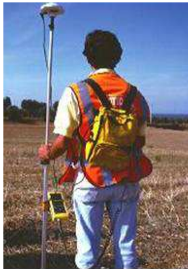
Figura 3.9 - Rilievo topografico mediante uso di GPS
