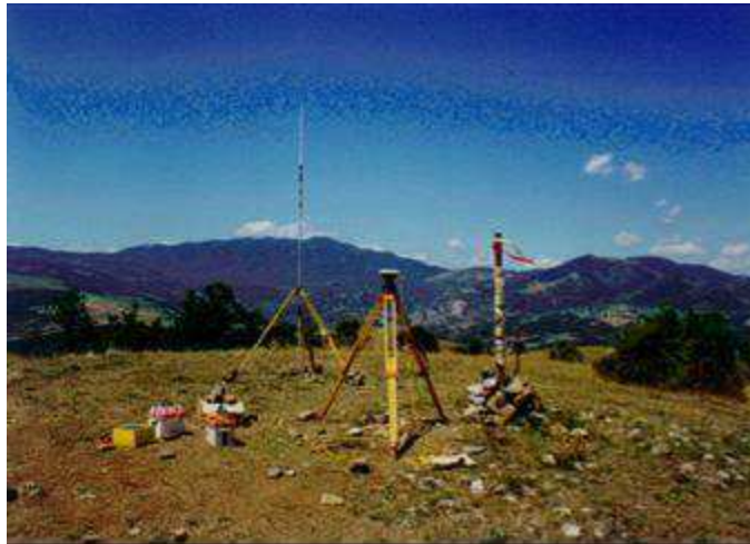
Figura 3.8 - Rilievo topografico mediante uso di GPS
