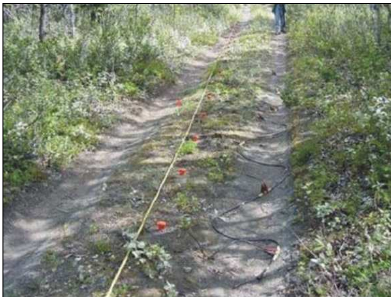
Figura 3.15 - Esempio di stendimento geofoni su strada sterrata
