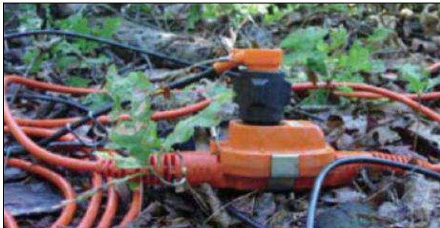
Figura 3.7 - Posizionamento dei geofoni
