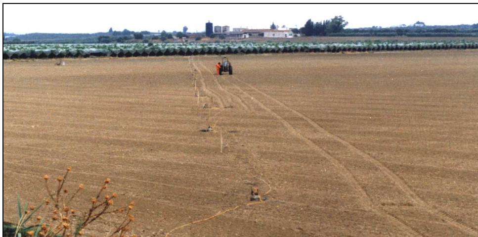
Figura 3.10 - Esempio di pattern di geofoni, che prevede gruppi di 12 geofoni distanti fra loro 2,27 m, per una lunghezza totale del pattern di 25 m
