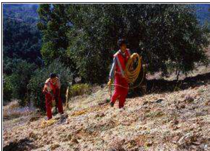
Figura 3.12 - Stesura dei cavi, dei geofoni e della strumentazione
