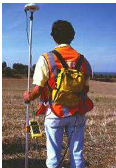
Figura 3.9 - Rilievo topografico mediante uso di GPS
