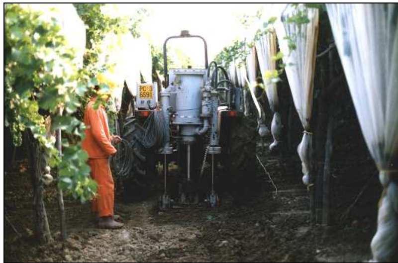
Figura 3.5 - Vibroseis leggero montato su mezzo agricolo operativo in area appenninica
