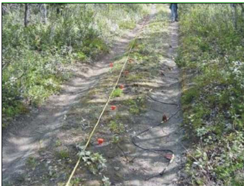
Figura 3.15 - Esempio di stendimento geofoni su strada sterrata
