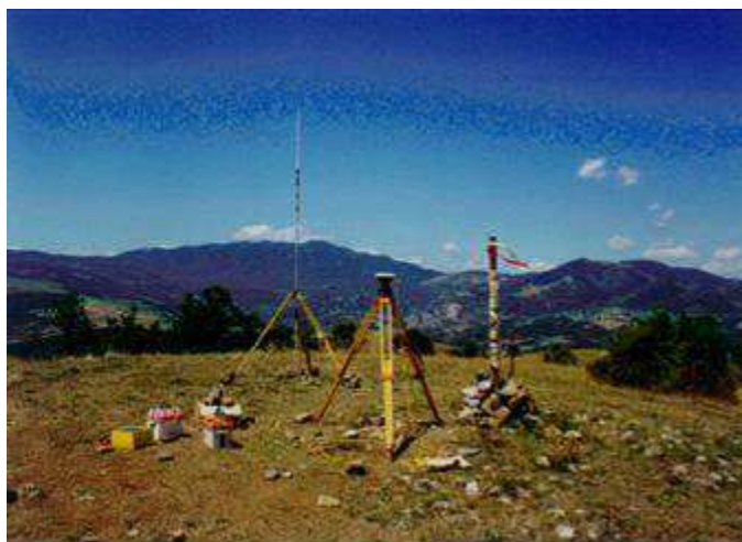
Figura 3.8 - Rilievo topografico mediante uso di GPS
