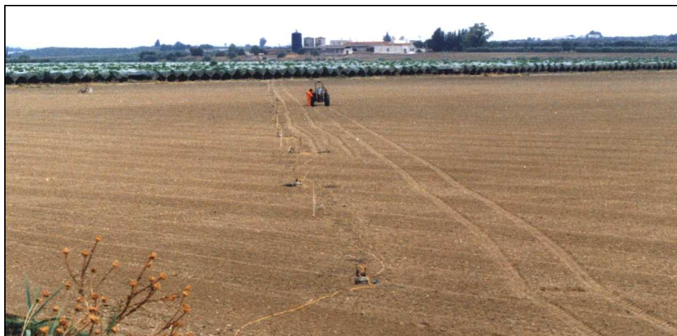
Figura 2.10 - Esempio di pattern di geofoni, che prevede gruppi di 12 geofoni distanti fra loro 2,27 m, per una lunghezza totale del pattern di 25 m
