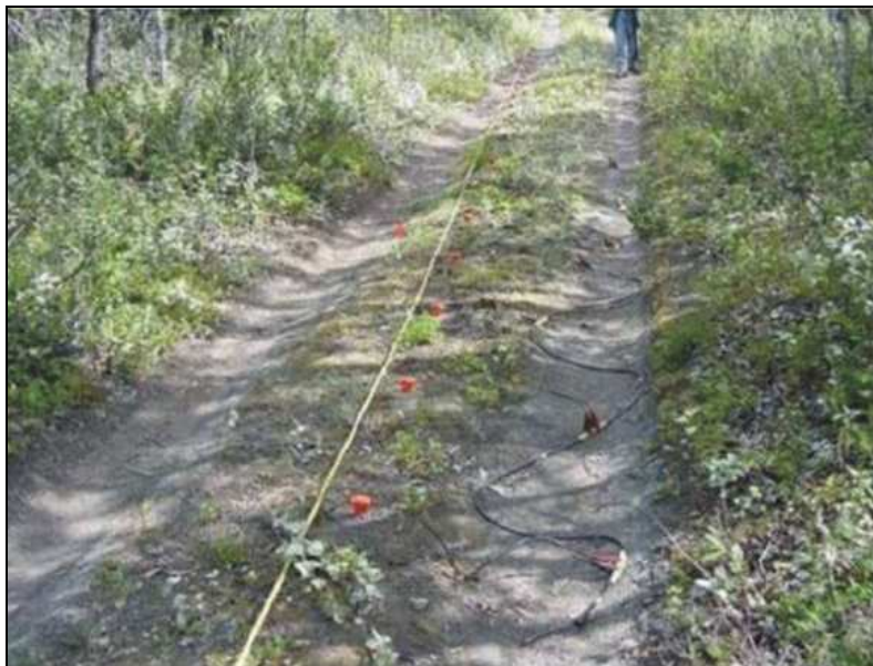
Figura 2.15 - Esempio di stendimento geofoni su strada sterrata
