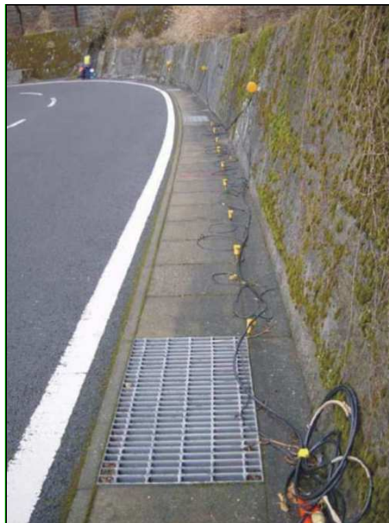
Figura 2.14 - Esempio di stendimento geofoni su strada
