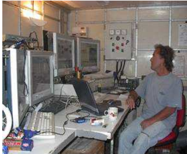
Figura 2.1 - Registratore telemetrico e plottaggio dei risultati per quality control
