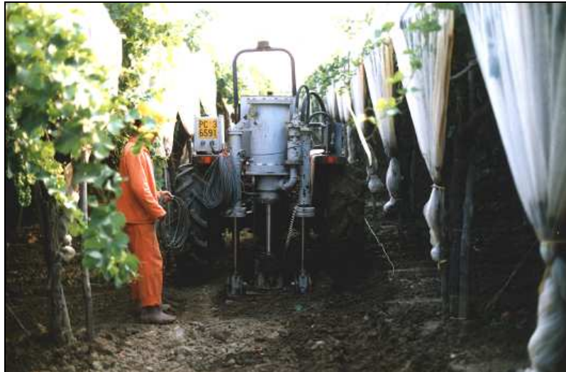
Figura 2.5 - Vibroseis leggero montato su mezzo agricolo operativo in area appenninica
