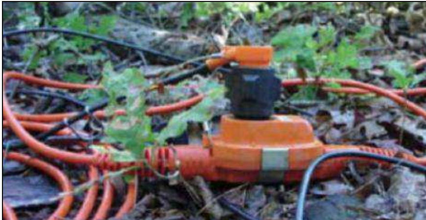
Figura 2.7 - Posizionamento dei geofoni
