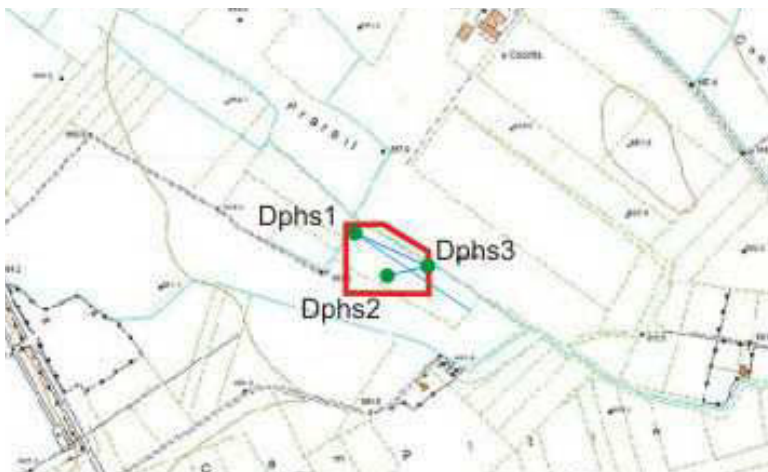
Figura 2 – CTRN con ubicazione delle prove DPSH in verde, in azzurro la traccia della sezione MASW e in blu le tracce delle sezioni geologiche.
