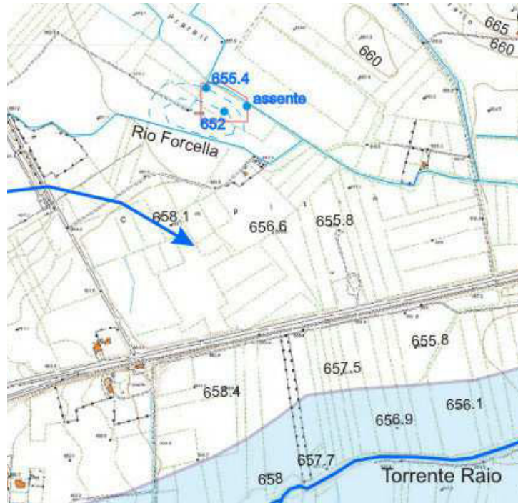
Figura 1 – CTRN con ubicazione delle misure della piezometrica e le quote in blu, in rosso è delineata l’area di intervento, in azzurro i canali di drenaggio e l’area considerata a pericolo idrogeologico del PSDA e in blu la traccia del torrente Raio e le linee di drenaggio.
