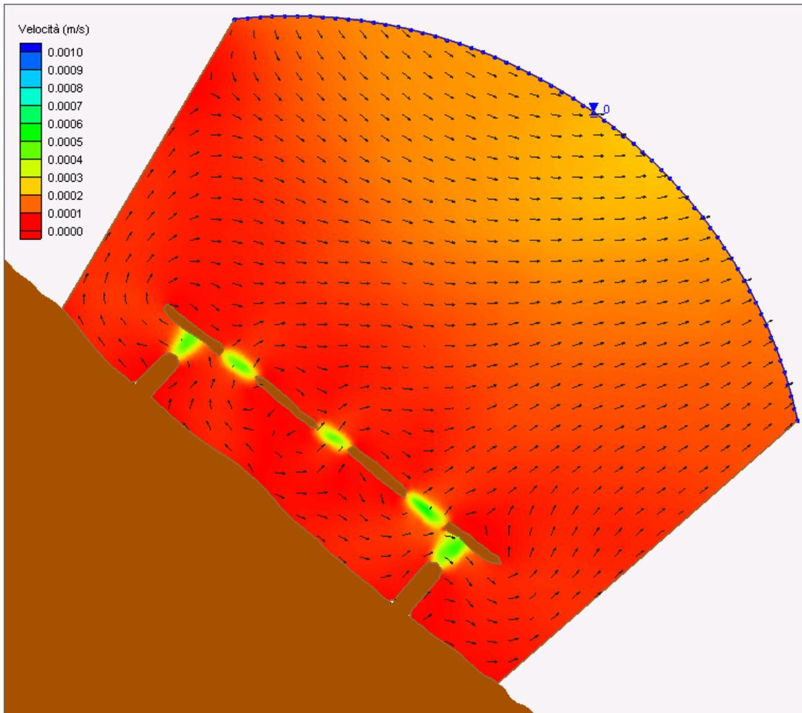
**Figura 3.3 – Particolare del campo idrodinamico indotto dalla sola marea astronomica alle ore 9.00 (inversione del flusso).**
