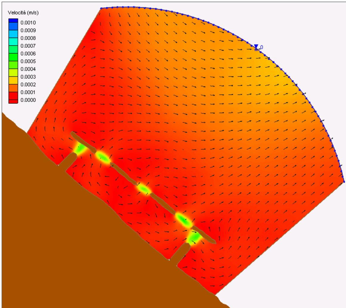
Figura 3.1 – – Particolare del campo idrodinamico indotto dalla sola marea astronomica alle ore 3.00 (inversione del flusso)
