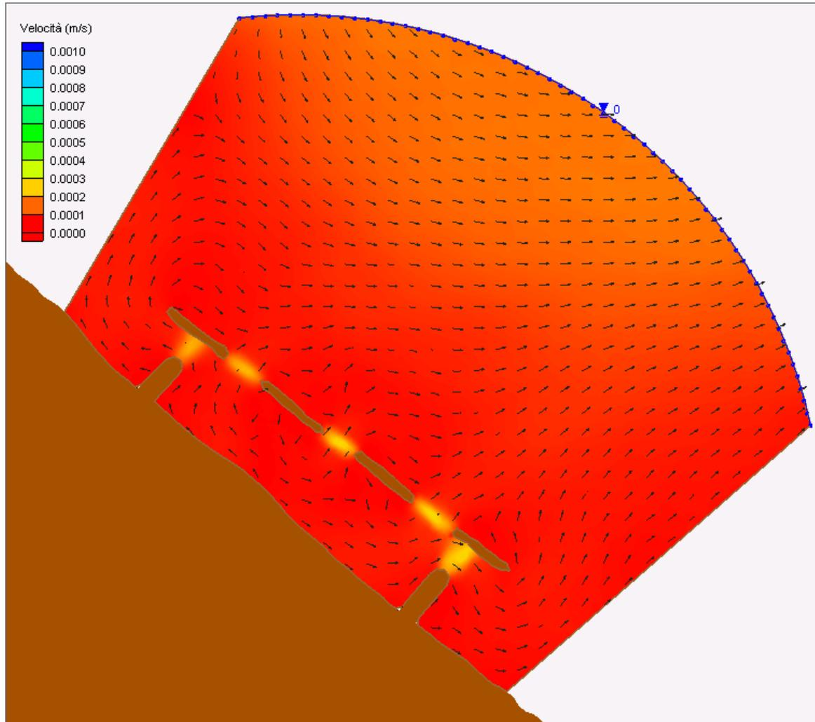
**Figura 3.7 – Particolare del campo idrodinamico indotto dalla sola marea astronomica alle ore 21.00 (inversione del flusso).**
