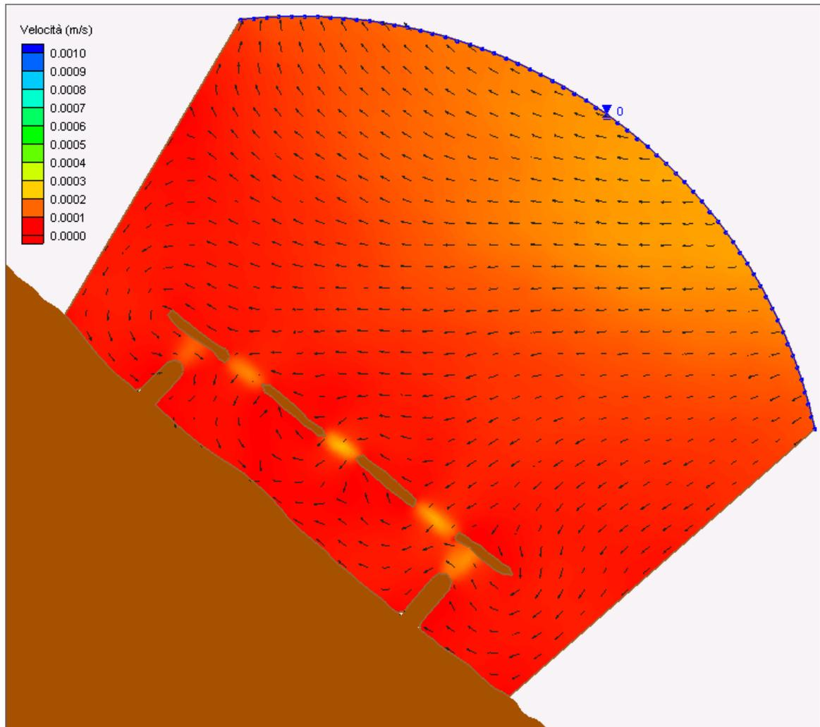
**Figura 3.5 – Particolare del campo idrodinamico indotto dalla sola marea astronomica alle ore 15.00 (inversione del flusso).**
