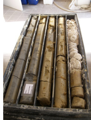
Piezometro Valle profondità 1 – 5 mt dopo prelievo campione a 3 mt
