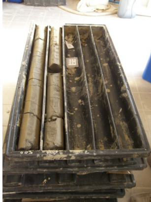
Piezometro Valle profondità 6 – 7 mt dopo prelievo campione a 6,5 mt
