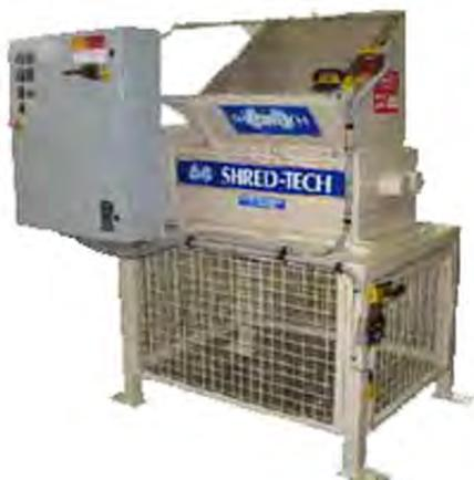
Per alcune tipologie di materiale che occupano parecchio volume come schede elettroniche, carcasse di computer, plastiche ecc. si procederà ad effettuare una riduzione volumetrica mediante un tritatore posto a fine rulliera di disassemblaggio al fine di favorire il trasporto di maggiori quantità di materiale agli impianti finali. **(Allegato 4)**
