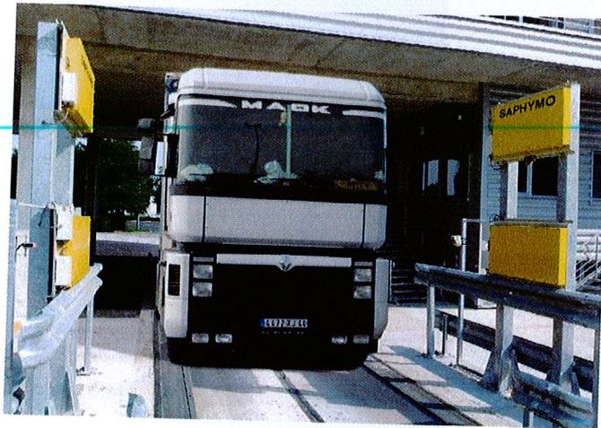
*Foto 2: Esempio di impiego del portale SAF-3000 per la rilevazione di sorgenti radioattive all'interno di veicoli*
