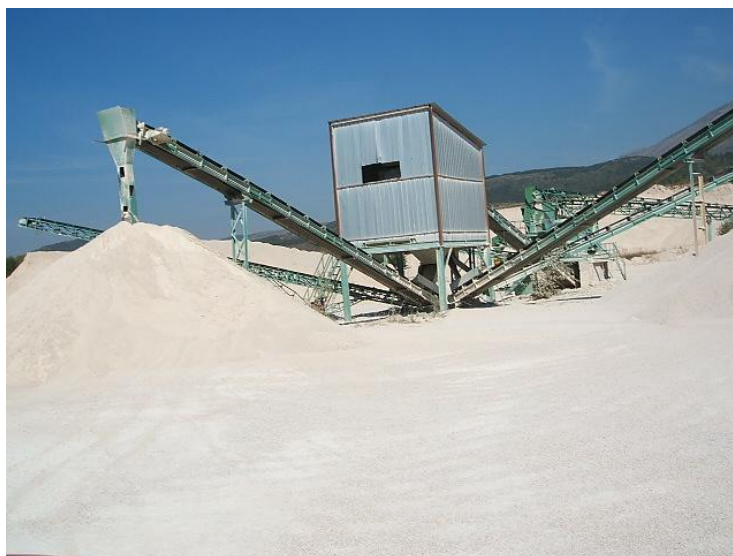
Macchinario di triturazione del fresato
