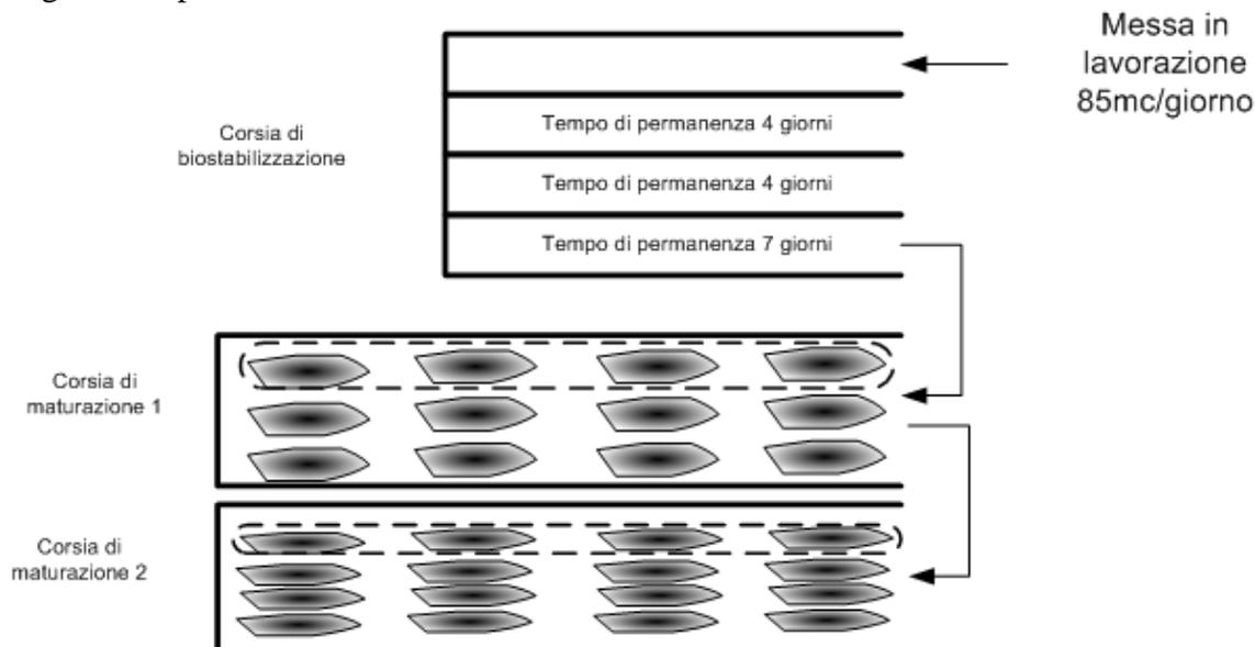
Considerato il volume totale delle corsie di maturazione primaria ed il volume occupato dal materiale proveniente dalle corsie di bio-ossidazione, è pari a 360 mc si ottiene che è possibile suddividere il materiale in almeno 7 corsie.
